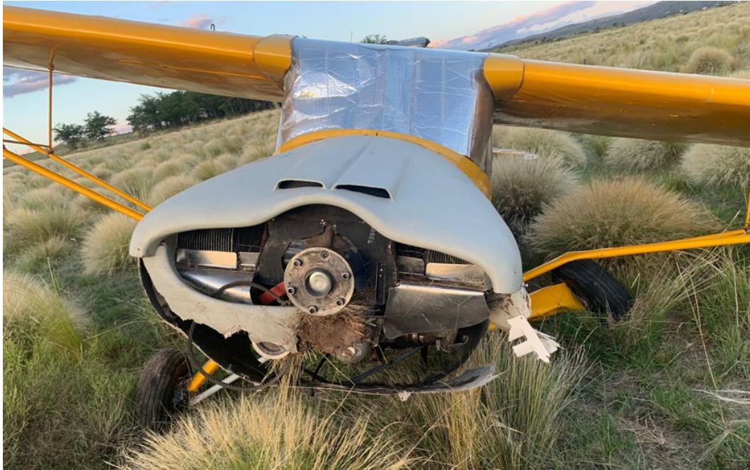
Figura 3. Daños en el tren principal izquierdo y zona de motor. Fuente: investigación JST
