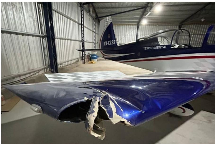
Figura 2. Daños en la puntera de plano. Fuente: investigación JST
