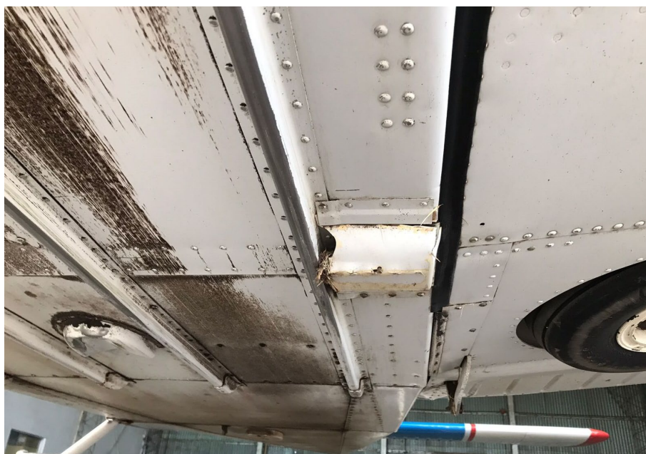
Figura 4. Daños en el fuselaje. Fuente: investigación JST
