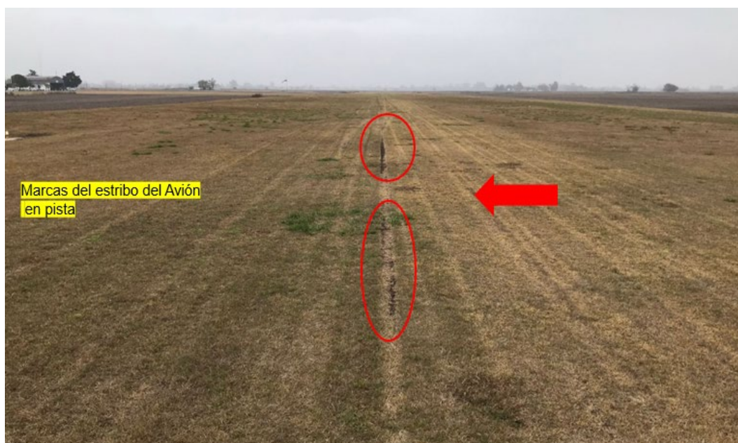
Figura 5. Marcas identificadas y registradas en la pista de aterrizaje. Fuente: investigación JST
