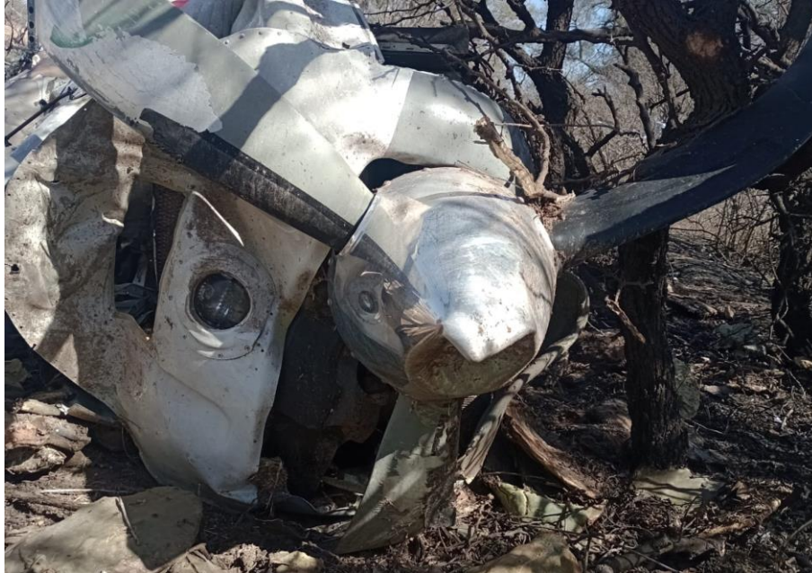
Figura 9. Imagen del motor girado y de los daños en la hélice. Fuente: investigación JST
