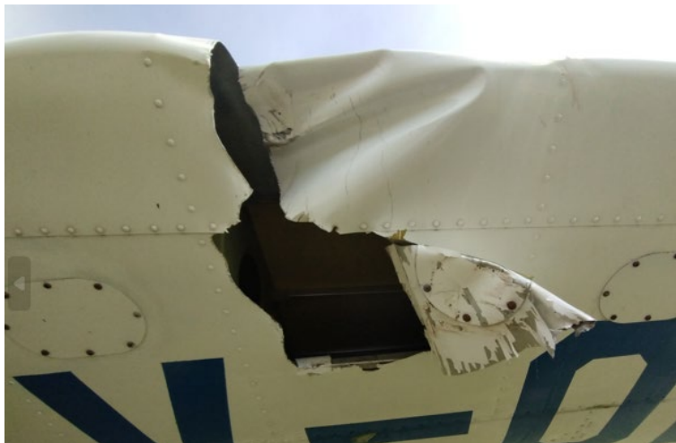
Figura 5. Daños en el semiplano (vista externa). Fuente: investigación JST
