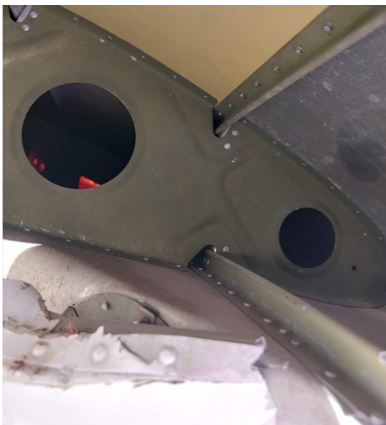
Figura 6. Daños en el semiplano (vista interna). Fuente: investigación JST
