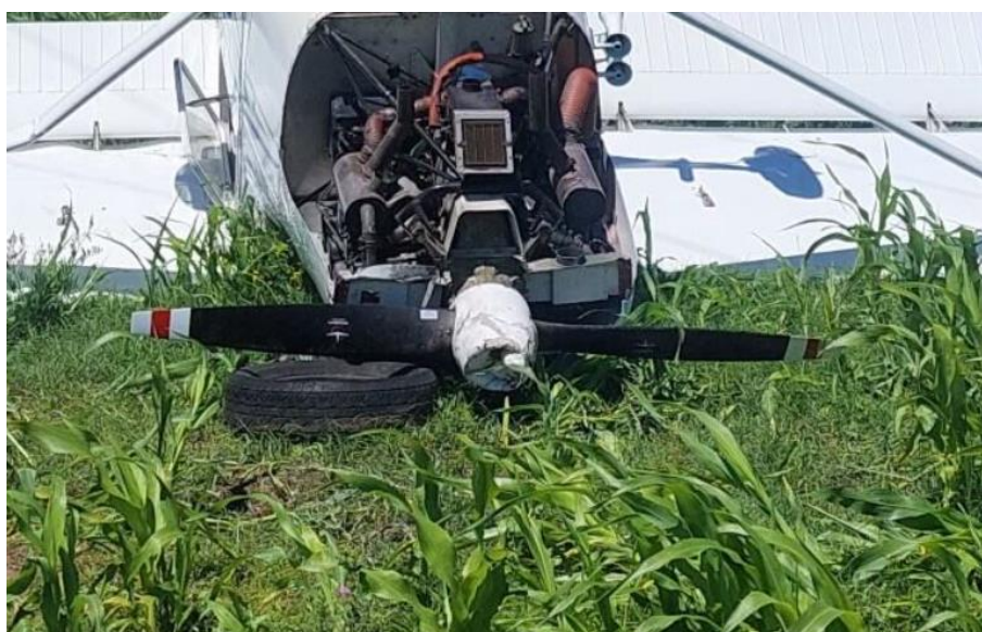
Figura 8. Daños en la hélice. Fuente: investigación JST
