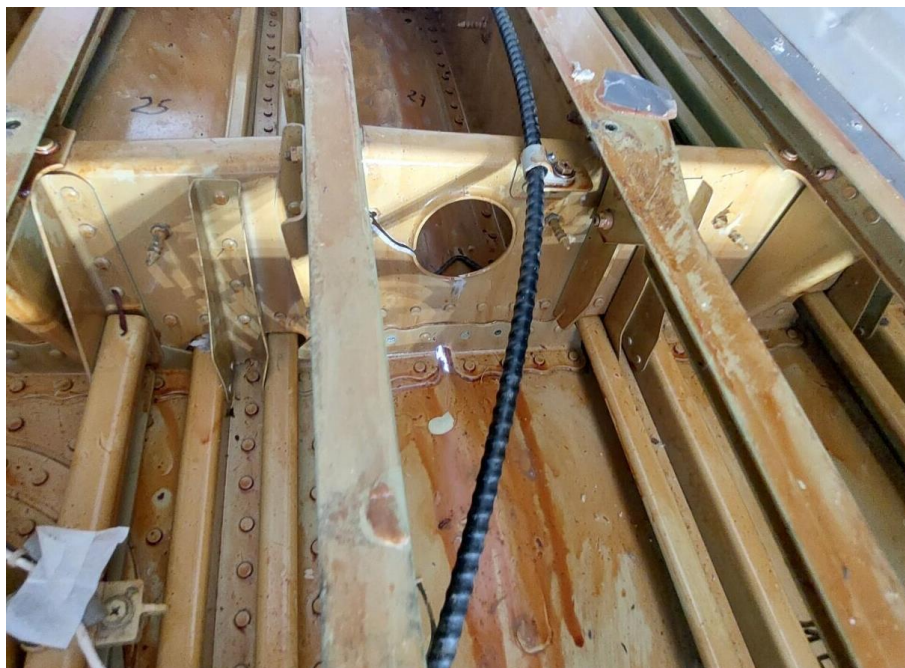
Figura 3. Daños en las cuadernas del fuselaje. Fuente: investigación JST
