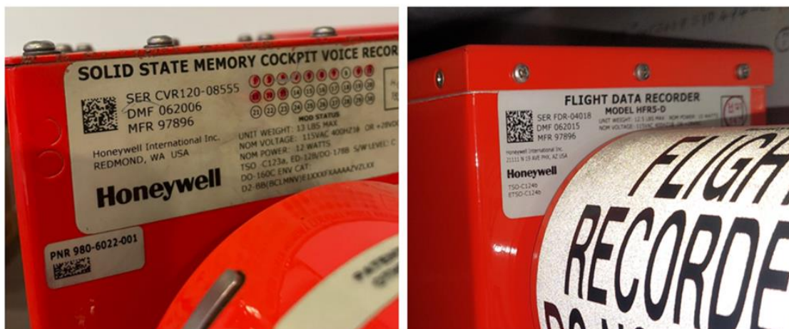
Figura 12. CVR (izquierda) y FDR (derecha). Fuente: investigación JST
