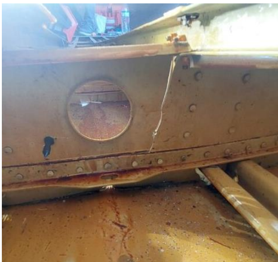
Figura 4. Daños en las cuadernas del fuselaje. Fuente: investigación JST
