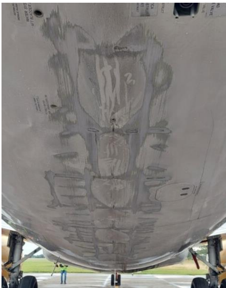
Figura 2. Daños en el fuselaje. Fuente: investigación JST
