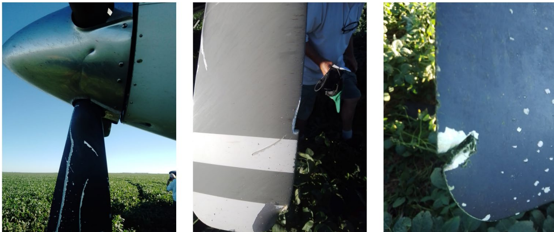
Figura 4. Daños en las palas y el cono de hélice. Fuente: investigación JST
