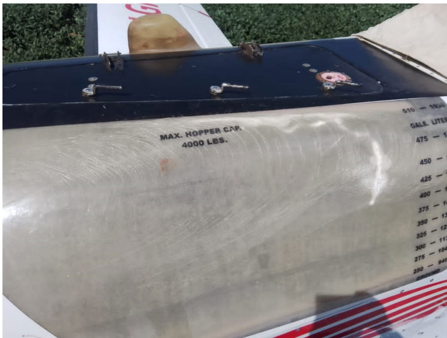
Figura 6. Daños en tolva de la aeronave. Fuente: investigación JST
