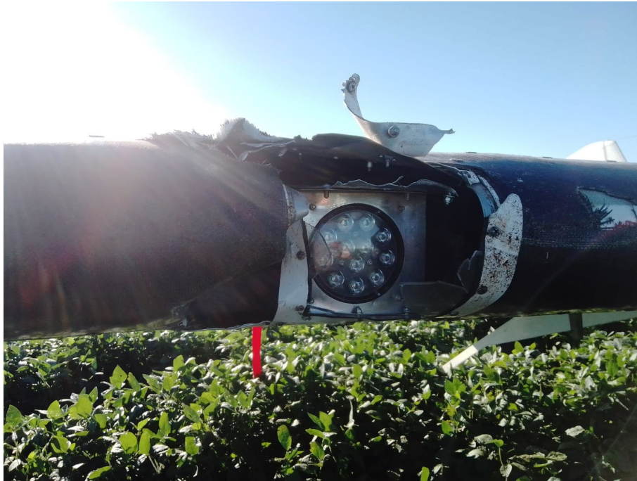
Figura 5. Daño en el faro de aterrizaje del plano derecho. Fuente: investigación JST
