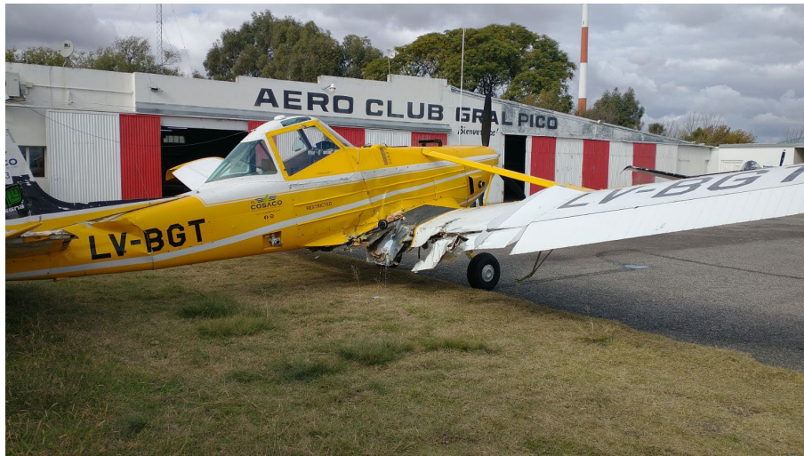
Figura 3. Daños de importancia de la aeronave LV-BGT. Fuente: investigación JST
