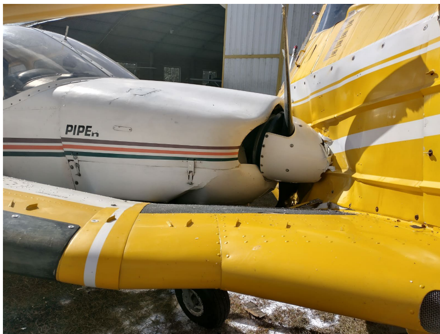
Figura 4. Daños en hélice de la aeronave LV-ODF. Fuente: investigación JST
