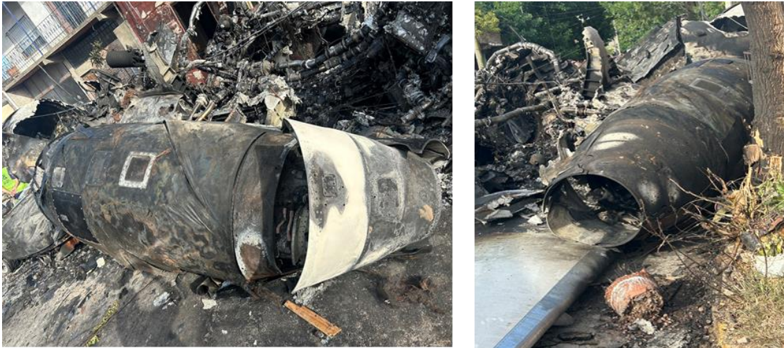
Figura 3. Daños en los motores debido al incendio. Fuente: investigación JST
