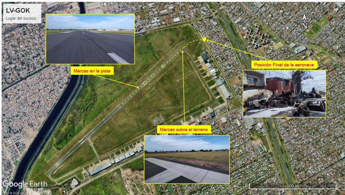
Figura 19. Trayectoria de la aeronave tras la toma de contacto con la pista. Fuente: investigación JST
