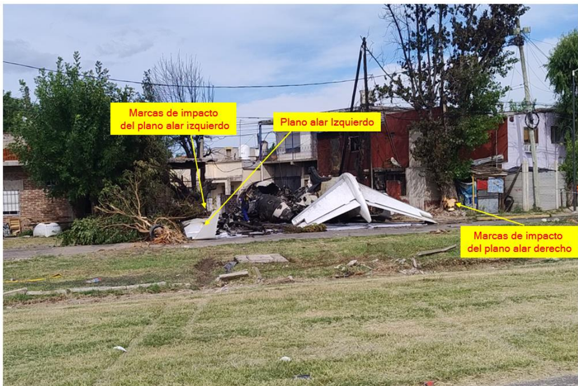
Figura 23. Detalle de las marcas en el terreno. Fuente: investigación JST
