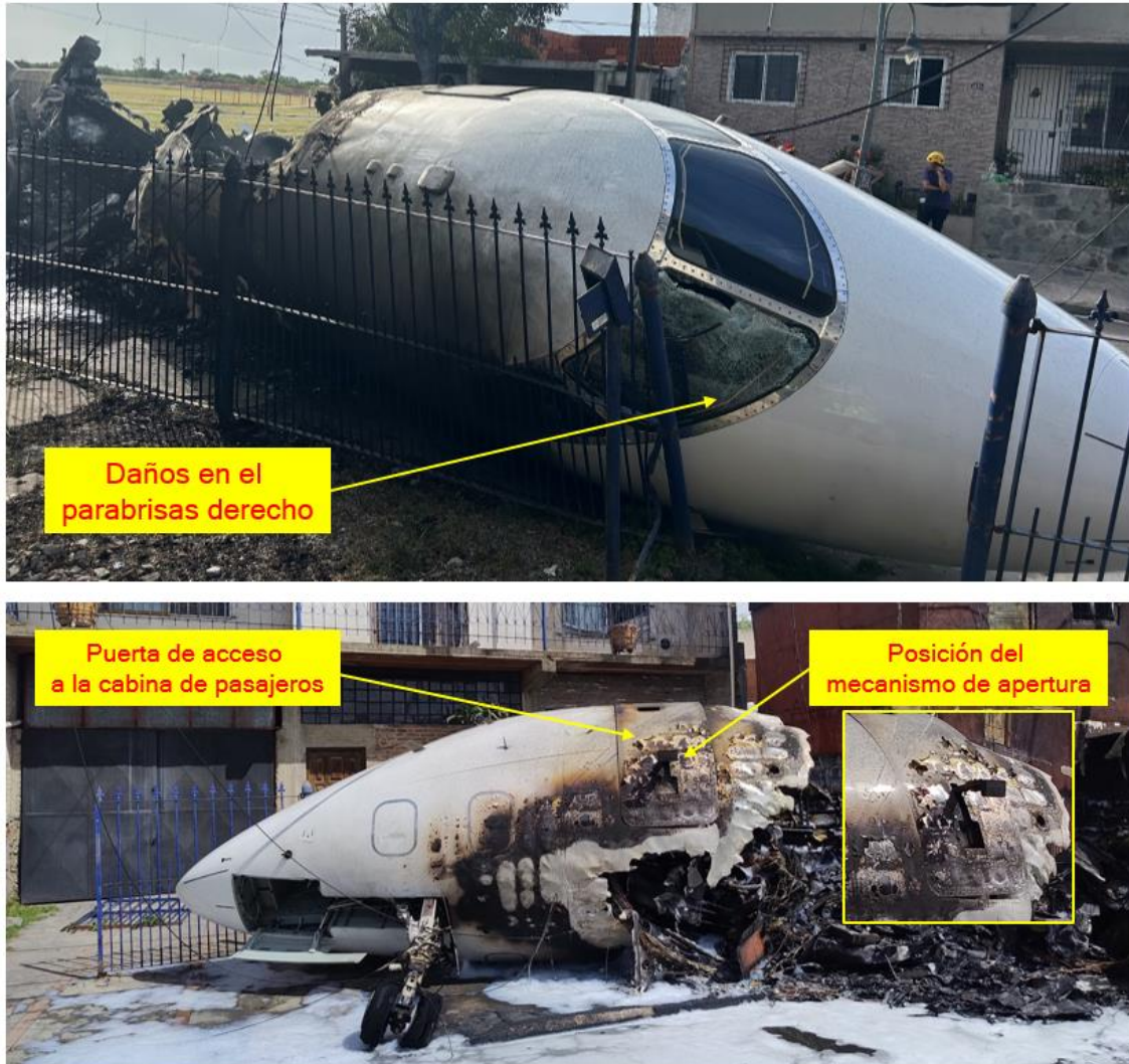
Figura 35. Condición de la cabina luego del suceso. Fuente: investigación JST
