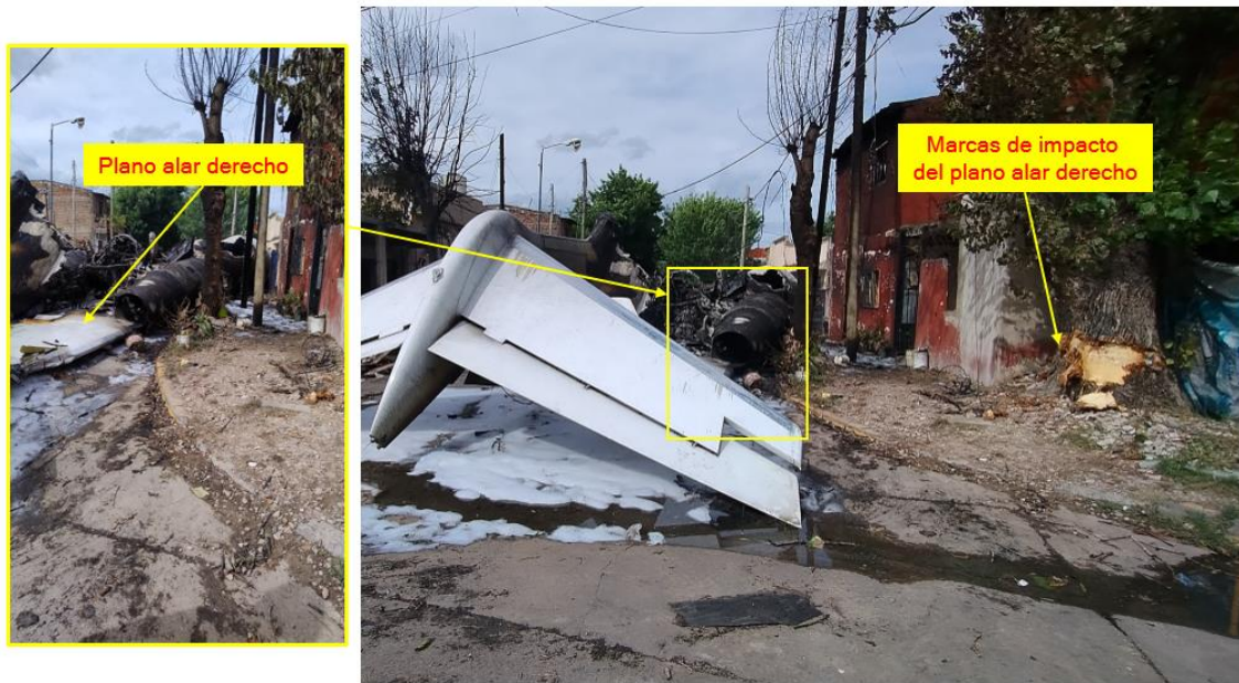
Figura 22. Detalle de las marcas en el terreno. Fuente: investigación JST
