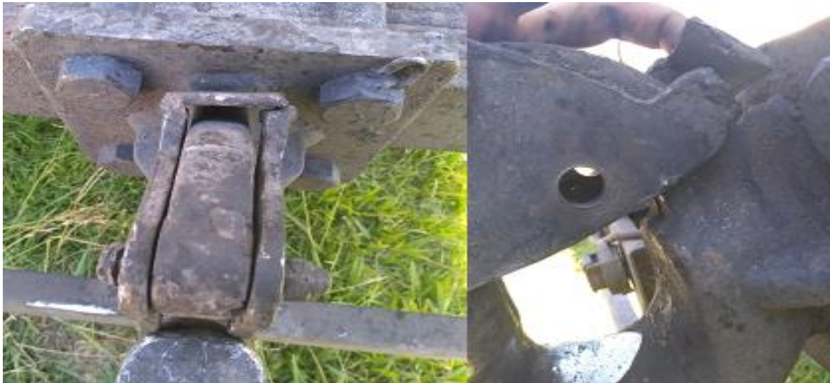
Figura 35. Sistema de enganche, fractura del sistema de seguridad. Fuente: JST, 2021
