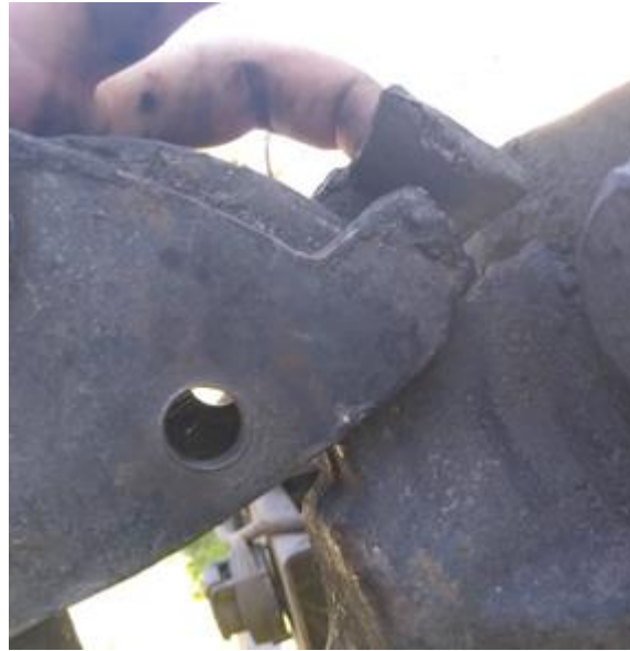
Figura 18. Traba de seguridad del enganche alterada. Fuente: JST, 2021
