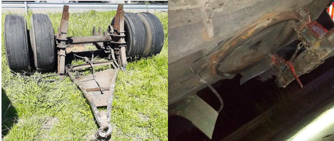
Figura 5. Tren delantero desvinculado del acoplado y separación del aro giratorio. Fuente: JST, 2021
