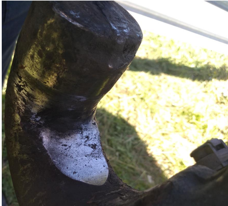
Figura 34. Desgaste del gancho. Fuente JST, 2021
