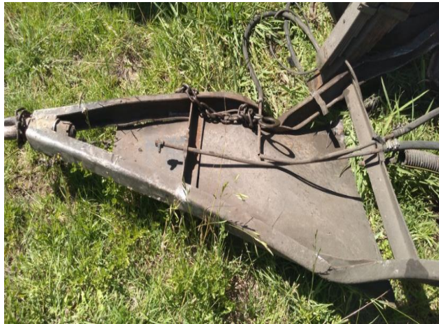
Figura 6. Lanza rígida deformada. Fuente: JST, 2021
