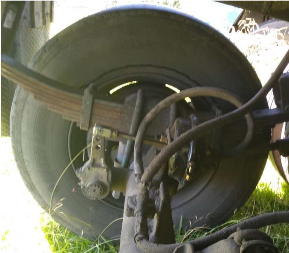
Figura 52. Rajadura en el flanco interno del neumático. Fuente: JST, 2021
