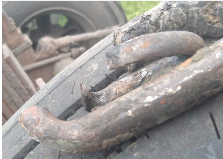
Figura 9. Eslabón deformado y fracturado. Fuente: JST, 2021
