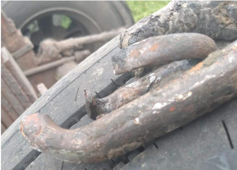
Figura 48. Eslabón deformado y fracturado. Fuente: JST, 2021
