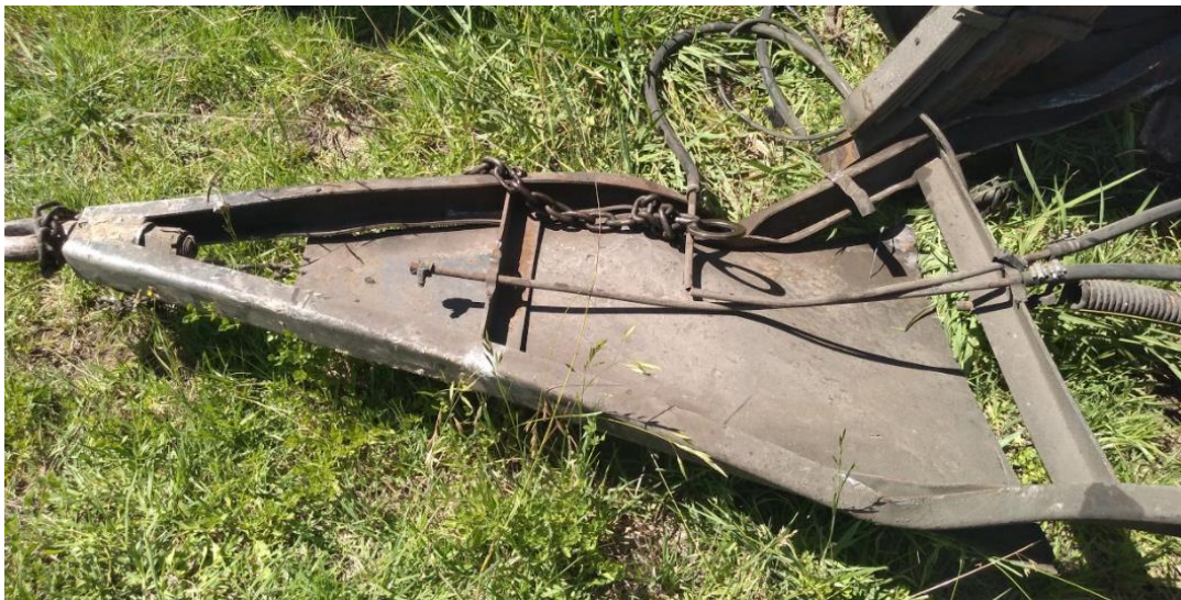
Figura 44. Lanza rígida deformada. Fuente: JST, 2021
