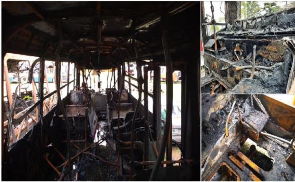
Figura 8. Daños sector interior. Fuente: JST
