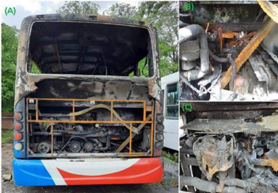
Figura 4. Daños sector trasero/Vano motor. Fuente: JST y Metropól.
