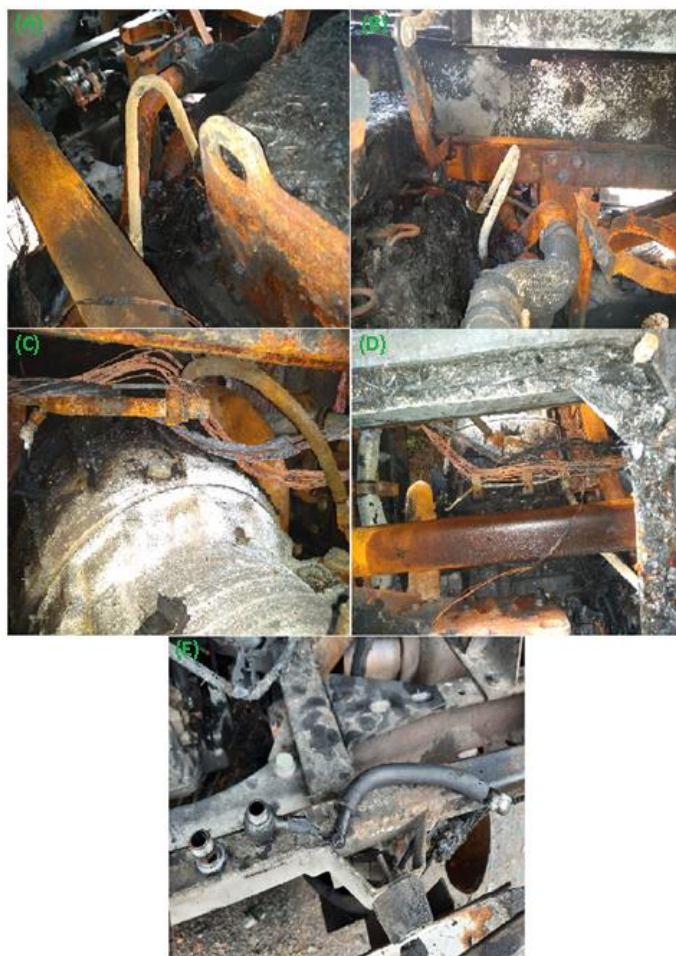
Figura 9: Piezas dañadas por el fuego. (A) tubería de aire; (B) tubería de aire; (C) Falta de flexible; (D) Falta de flexible; (E) poliamida de gasoil. Fuente JST
