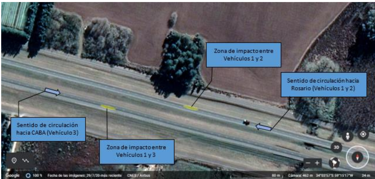
Figura 2. Imagen satelital del lugar del suceso, en la que se agregaron referencias de sentidos de circulación original de los vehículos y zonas de impacto aproximadas. Fuente: Google Earth, 2021.
