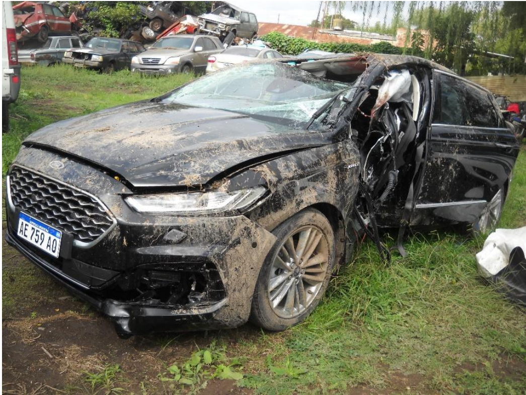
Figura 17. Deformaciones en el lateral izquierdo. Fuente: JST, 2021.
