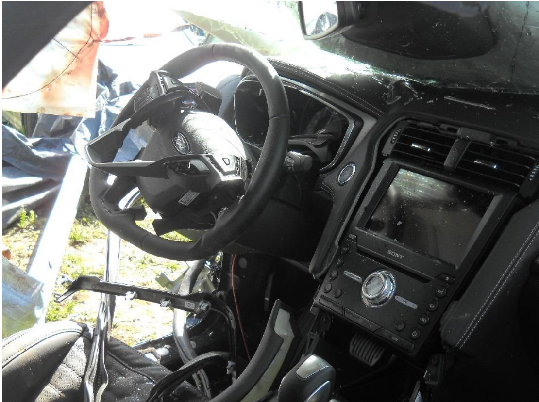
Figura 20. Roturas en el panel del tablero y el volante. Fuente: JST, 2021.
