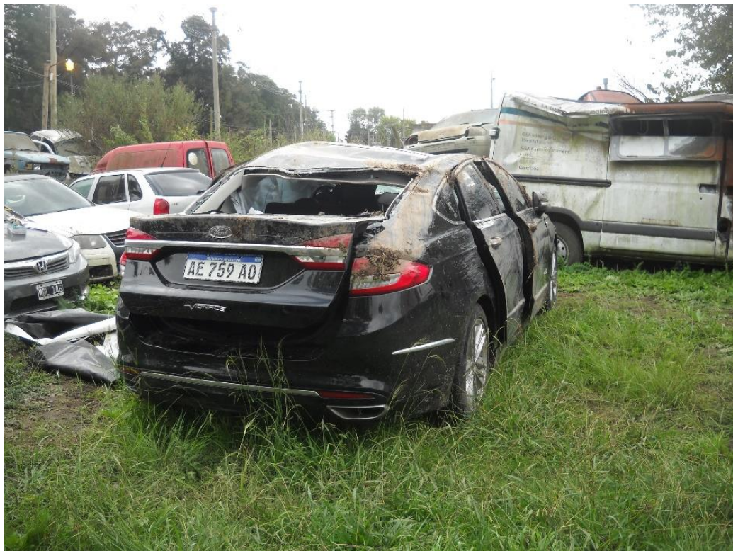
Figura 18. Deformación en el techo y rotura de la luneta. Fuente: JST, 2021.
