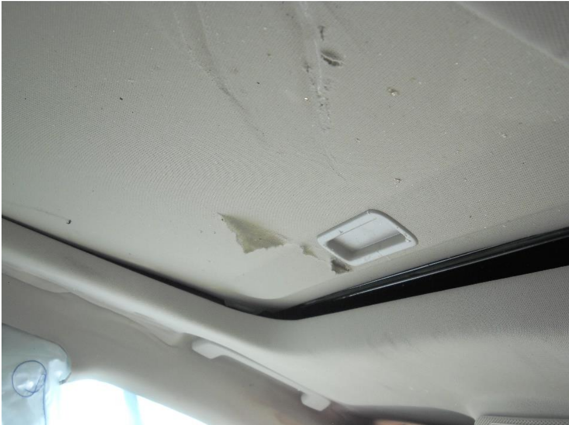
Figura 22. Marcas de roce en el techo interior del vehículo. Fuente: JST, 2021.
