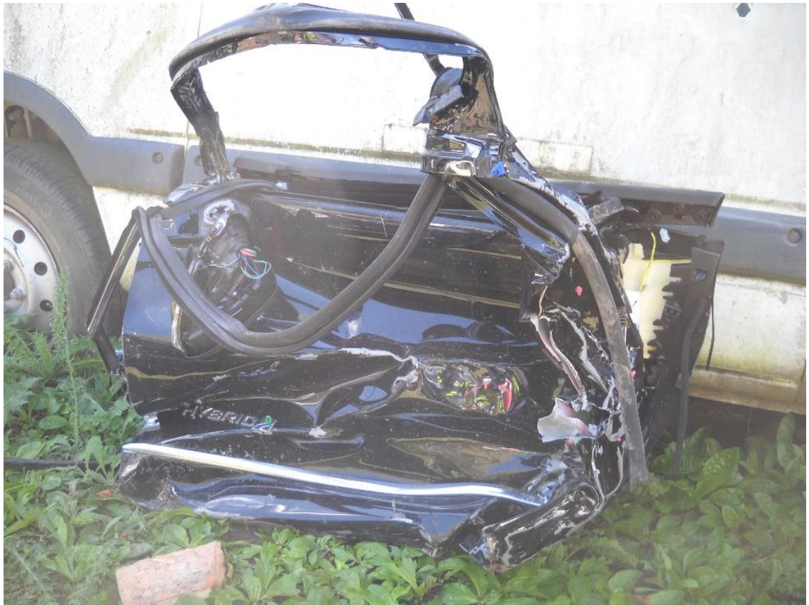
Figura 19. Deformaciones en la puerta del conductor: desprendimiento de las bisagras. Fuente: JST, 2021.
