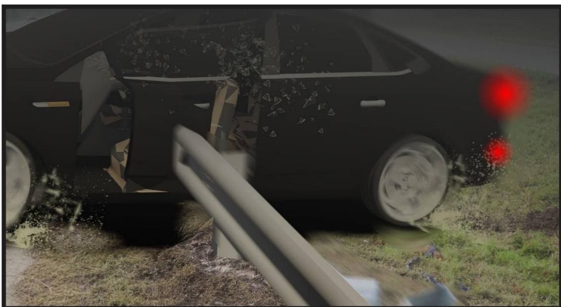
Figura 24. Choque lateral con terminal de barrera de contención. Fuente: JST, 2022.
