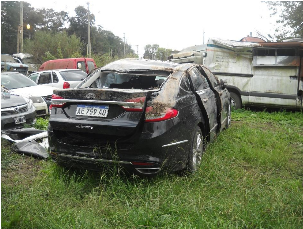
Figura 19. Deformación en el techo y rotura de la luneta. Fuente: JST, 2021
