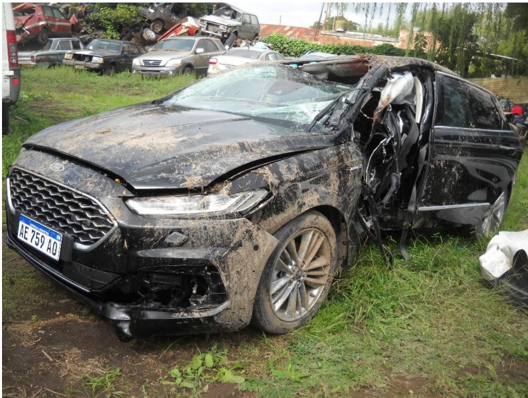
Figura 18. Deformaciones en el lateral izquierdo. Fuente: JST, 2021
