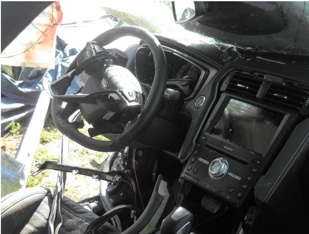
Figura 21. Roturas en el panel del tablero y el volante. Fuente: JST, 2021
