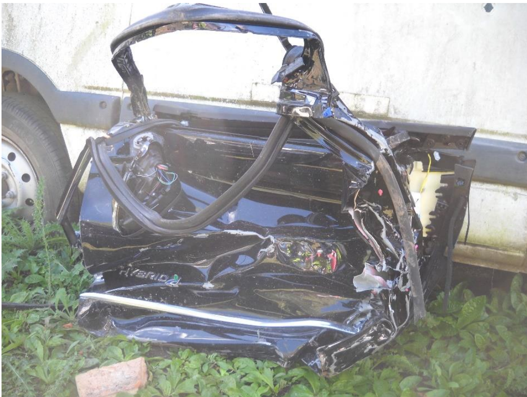
Figura 20. Deformaciones en la puerta del conductor: desprendimiento de las bisagras. Fuente: JST, 2021
