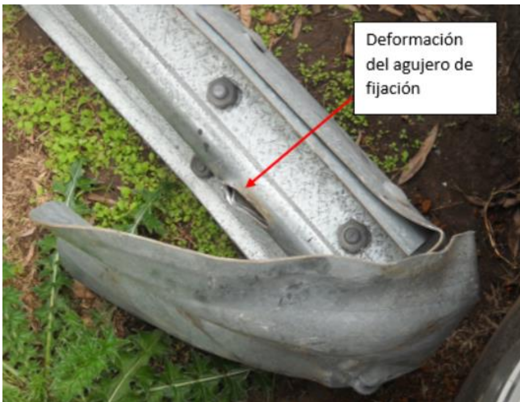
Figura 13. Tramo de la barrera desprendido. Fuente: JST, 2021
