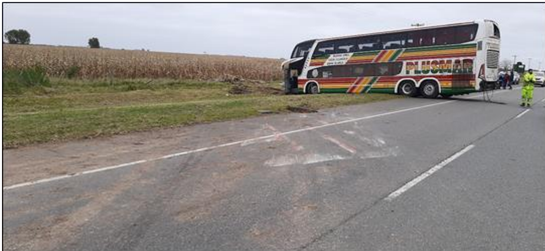
Figura 24. Inicio de las marcas de arrastre sobre la calzada sentido a Miramar
