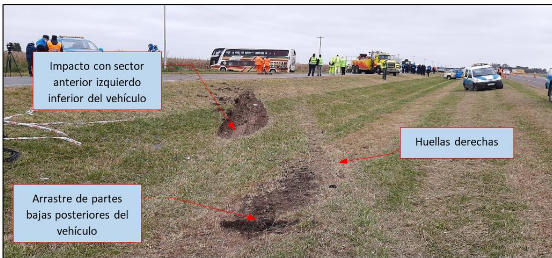
Figura 20. Zona de impacto del ómnibus con el talud del cantero central
