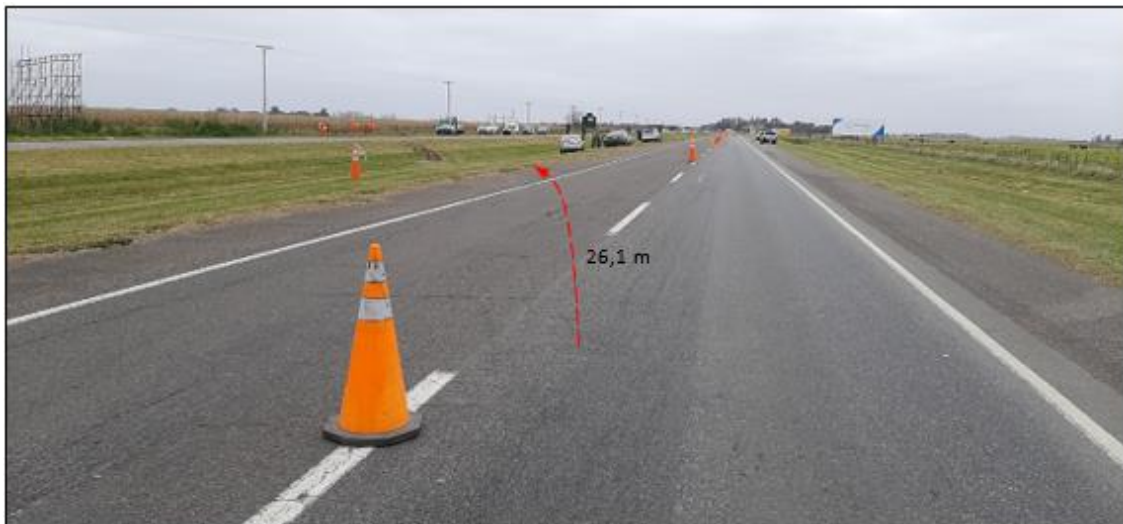
Figura 17. Huellas iniciales de derrape sobre la calzada vista a CABA
