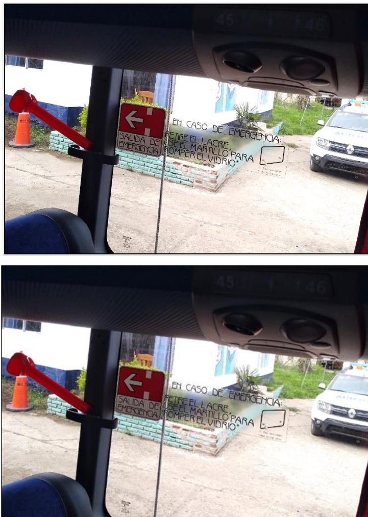
Figura 43. Señalización de una salida de emergencia y ubicación del martillo
