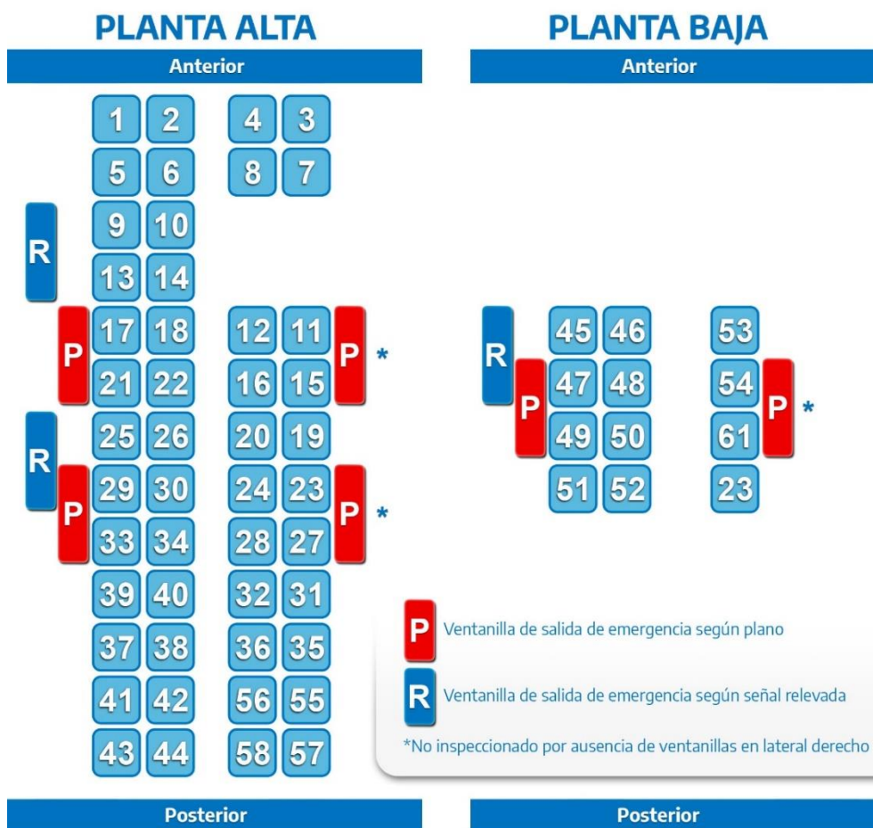
Figura 11. Esquema de ubicación de ventanillas de salida de emergencia
