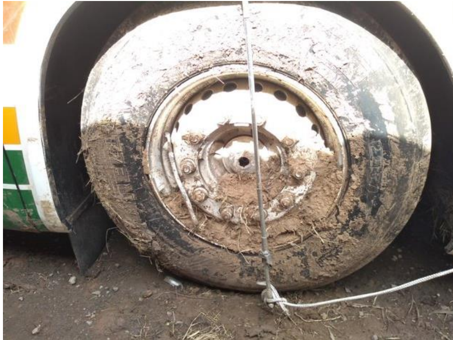
Figura 51. Daños en la rueda delantera derecha (direccional).
