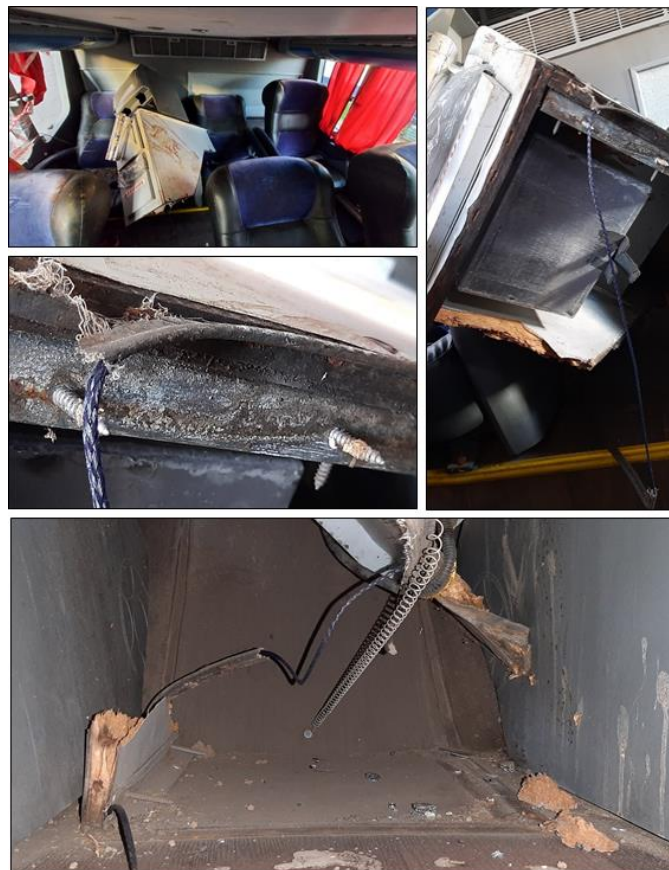
Figura 5. Cafetera desprendida en planta baja
