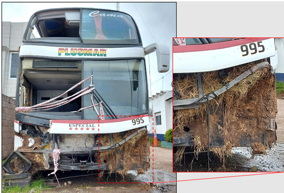
Figura 38. Daños en sector anterior de la unidad
