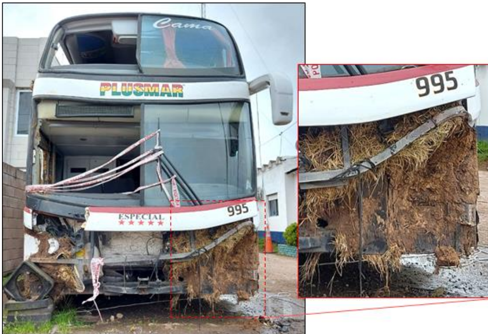
Figura 4. Daños en sector anterior de la unidad
