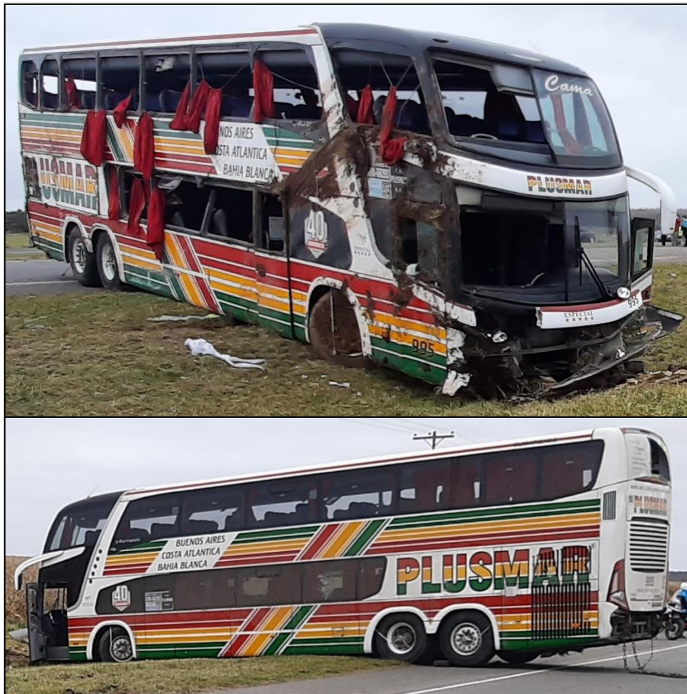
Figura 37. Daños principales en el exterior del ómnibus
