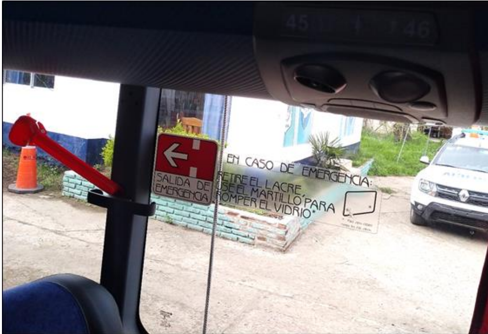
Figura 10. Señalización de una salida de emergencia y ubicación del martillo
