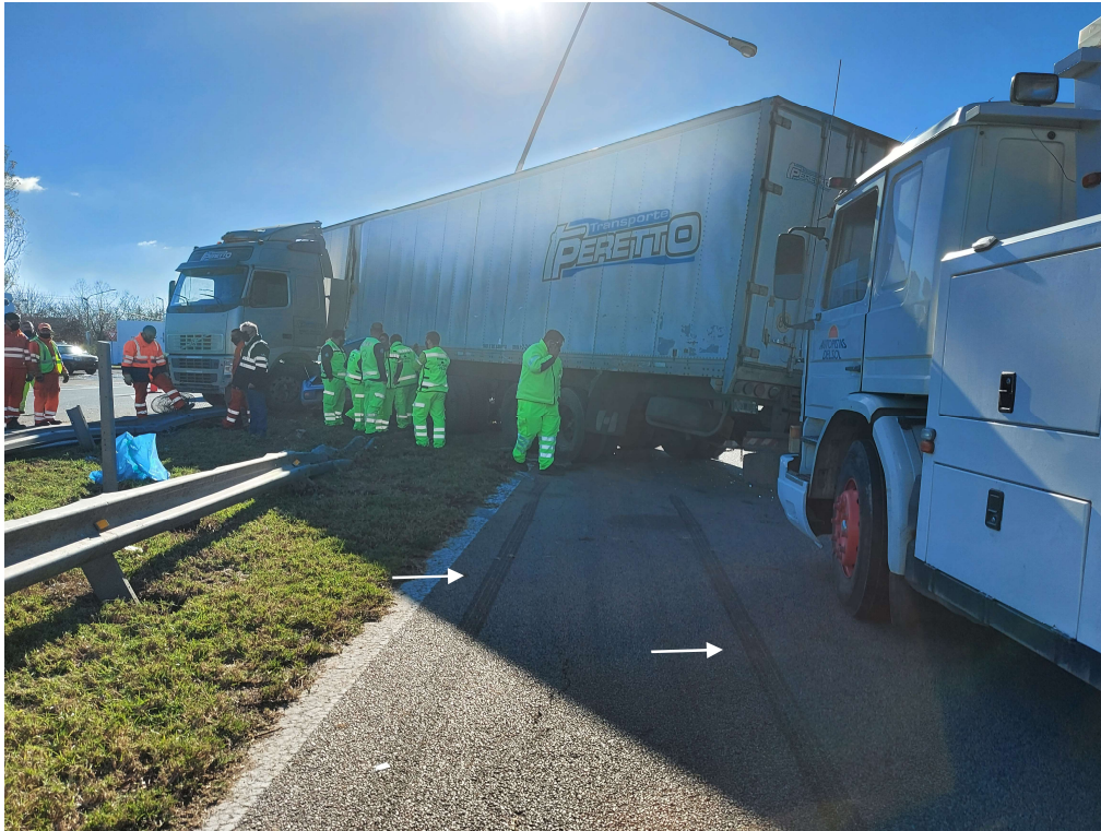
Figura 13. Fotografía de huellas de frenado correspondientes al Vehículo 3. Fuente: JST, 2021.
