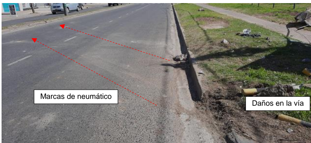
Figura 7. Vestigios que indican la trayectoria poscolisión del Vehículo 1. Fuente: JST.
