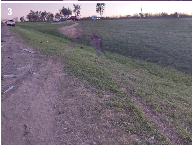
Figura 7. Inicio de la huella de frenado y esquive del Vehículo 1. Fuente: JST, 2021.
