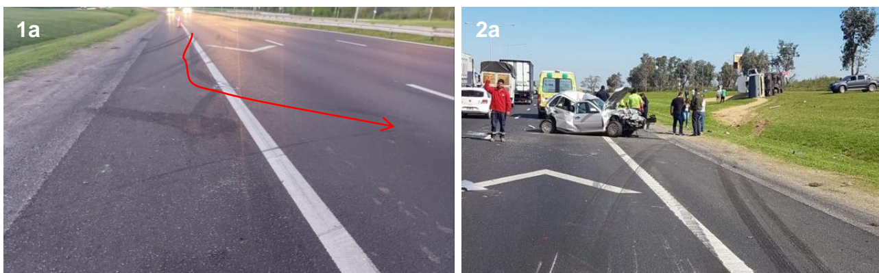
Figura 9. Huella de arrastre posimpacto, mancha de fluidos estáticos y posición final del Vehículo 2. Fuente: JST y Autopista del sol, 2021.
