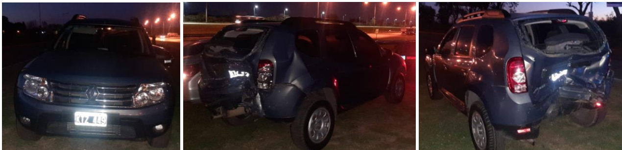
Figura 6. Daños en el Vehículo 3. Fuente: JST, 2021.
