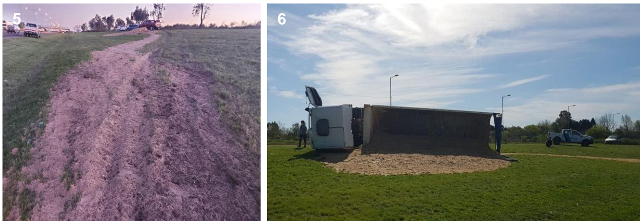
Figura 8. Huellas de frenado y desprendimiento de carga del Vehículo 1. Fuente: JST y Autopista del Sol, 2021.
