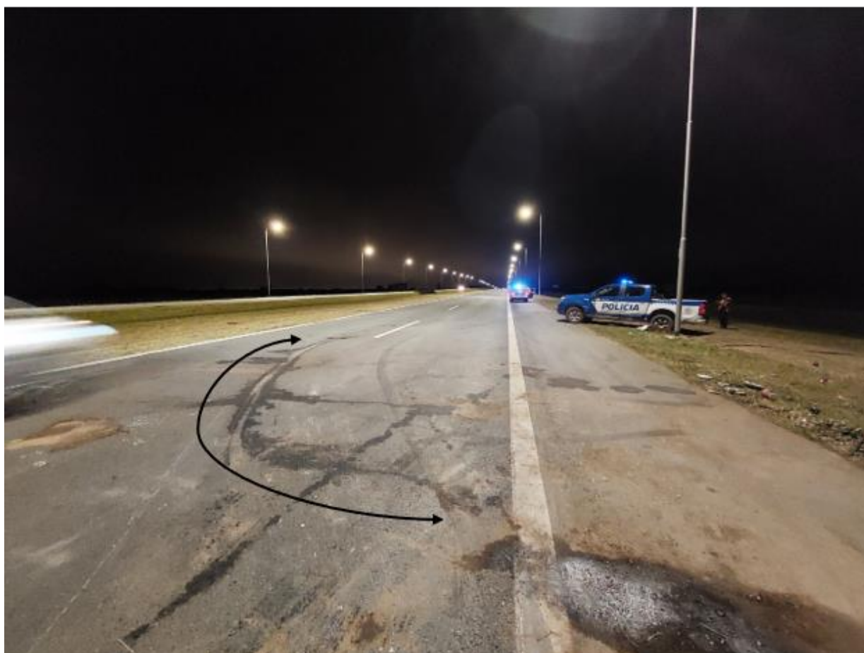
Figura 6. Huellas de frenado y de derrame de líquidos provenientes del impacto del Vehículo 1 contra el Vehículo 3. Fuente: JST
