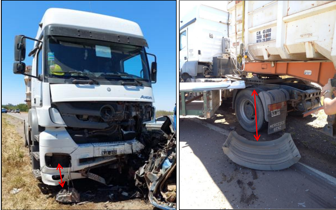
Figura 6. a) Daños en el sector anterior izquierdo de la unidad tractora del Camión Mercedes Benz. b) Desprendimiento del guardabarros posterior izquierdo. Fuente: JST.
