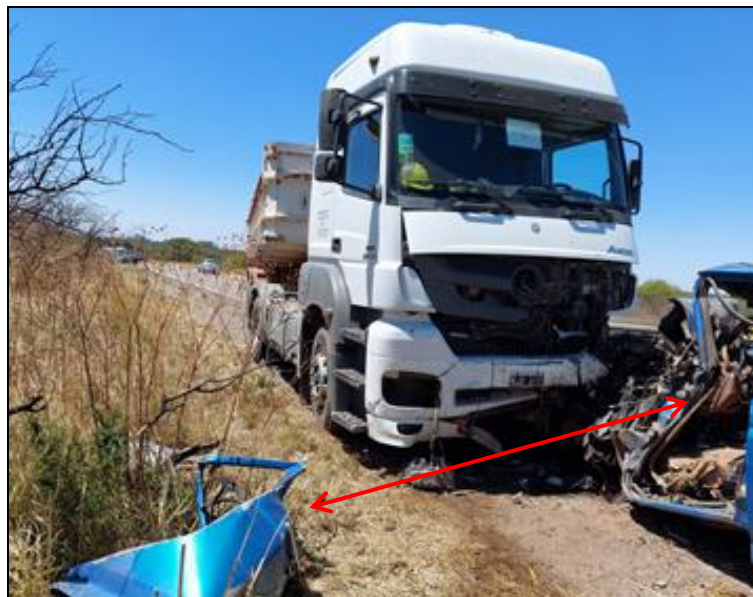
Figura 7. a) Torsión de chasis. b) Plegamiento de las chapas del capó. c) Desprendimiento de puerta izquierda. Fuente: JST.
