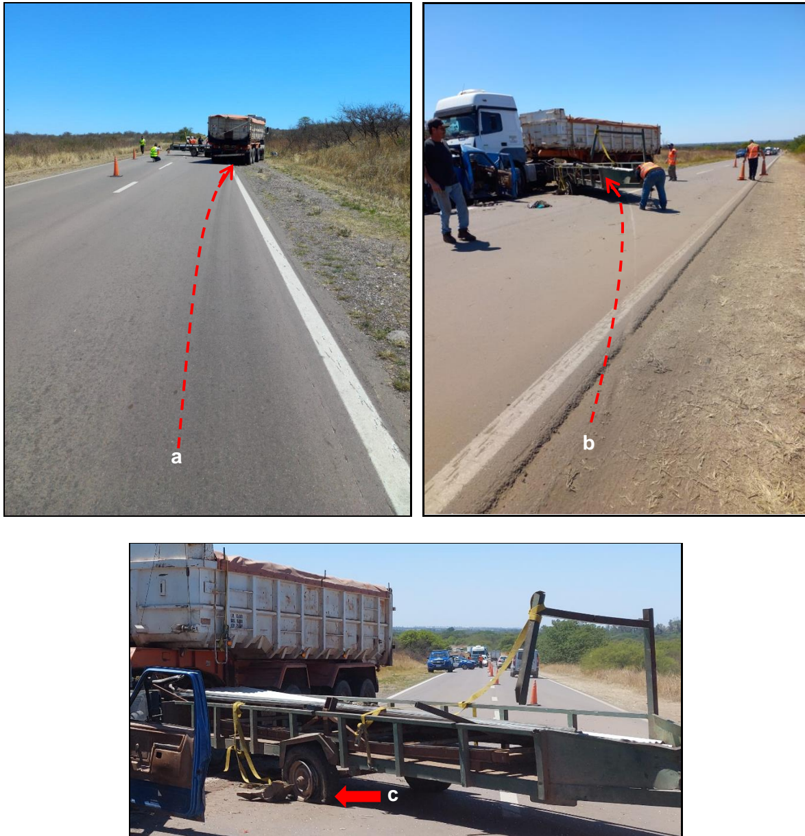
Figura 8. a) Huella de frenado. b) Huella de efracción. c) Neumático dañado. Fuente: JST.
