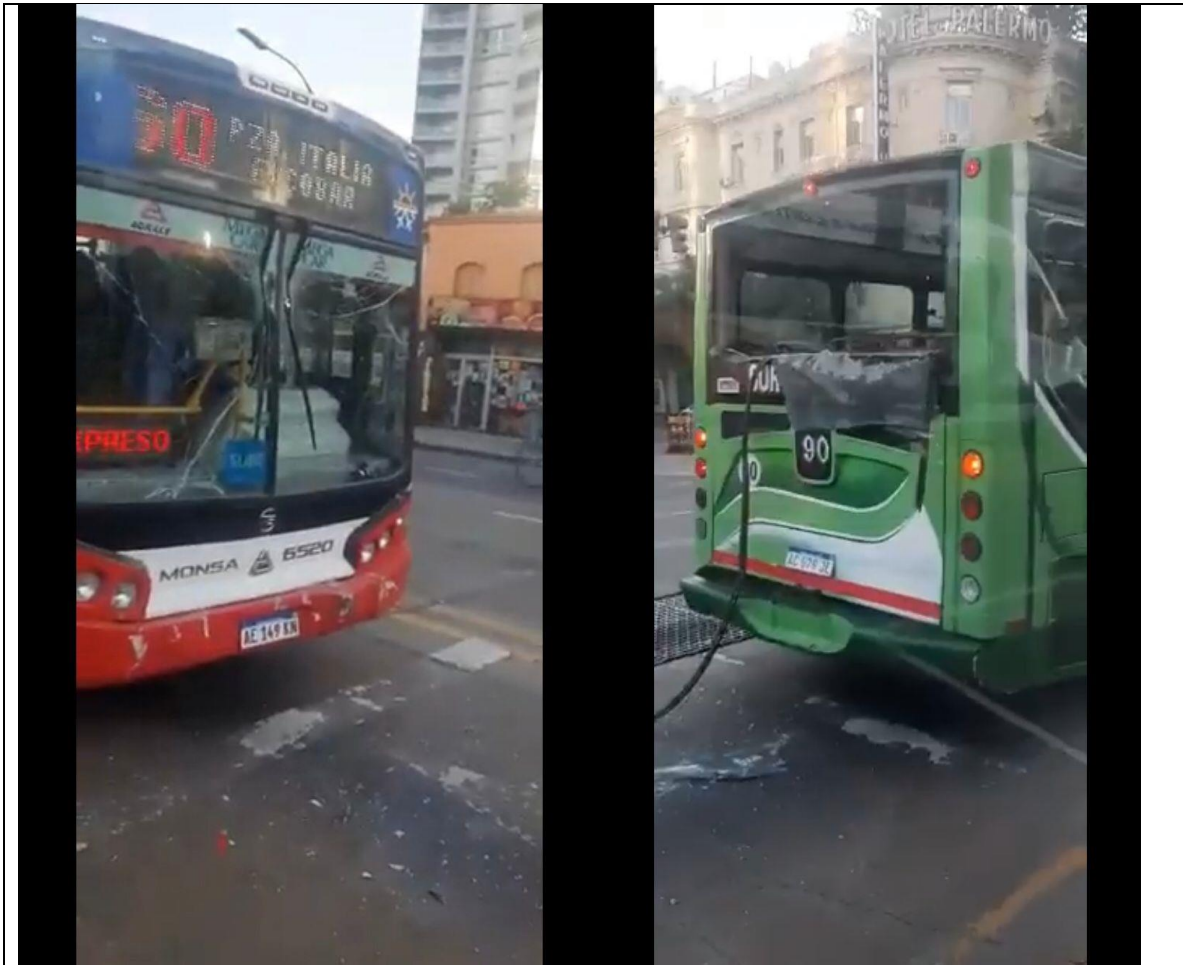
Figura 2. Daños sufridos por los Vehículos 1 y 2. Fuente: Ciudad de bondis , 2021.
