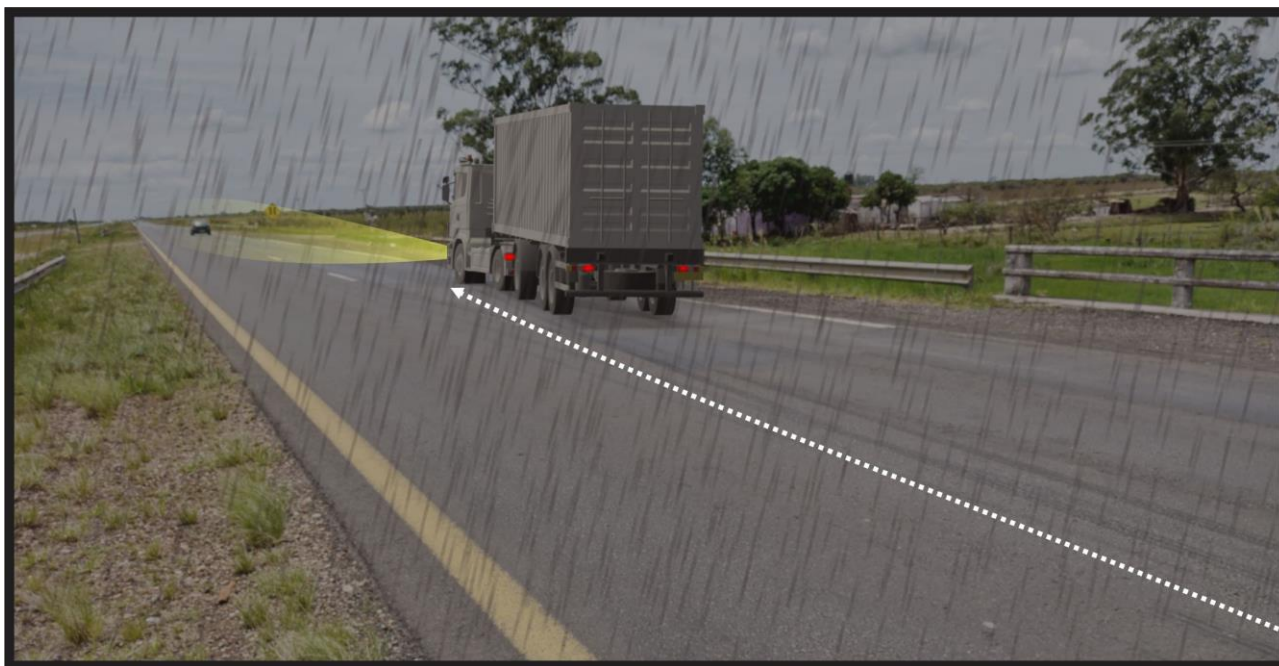
Figura 33. La imagen ilustra la trayectoria descontrolada descrita por del Vehículo 1 mientras descendía por la pendiente de la ruta con condiciones climáticas de lluvia torrencial y calzada con agua acumulada. Fuente: JST, 2021.
