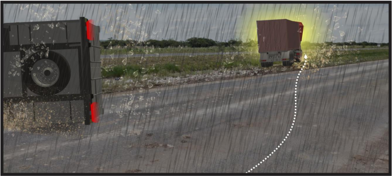
Figura 37. En la imagen se indica la trayectoria de despiste seguida por el Vehículo 2 el cual ingresó al canchero central de la autovía para finalmente detenerse dentro de él. Fuente: JST.
