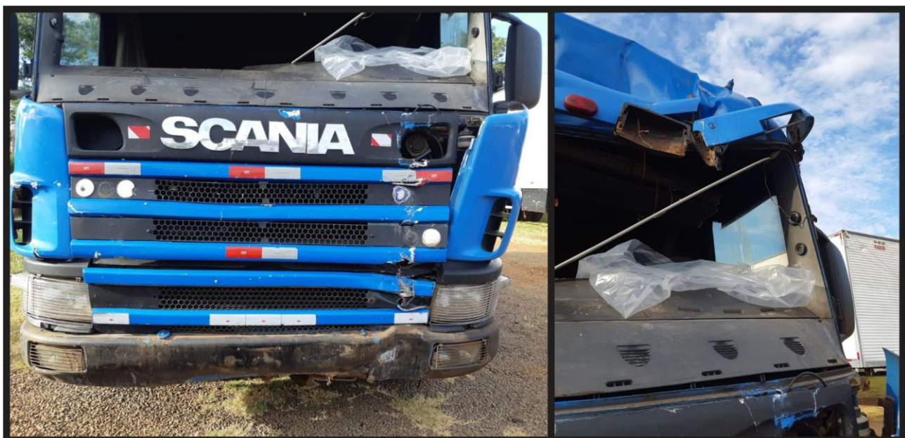
Figura 31. Daños en el frente izquierdo del Vehículo 4. Fuente: Mapfre Paraguay, 2021.
