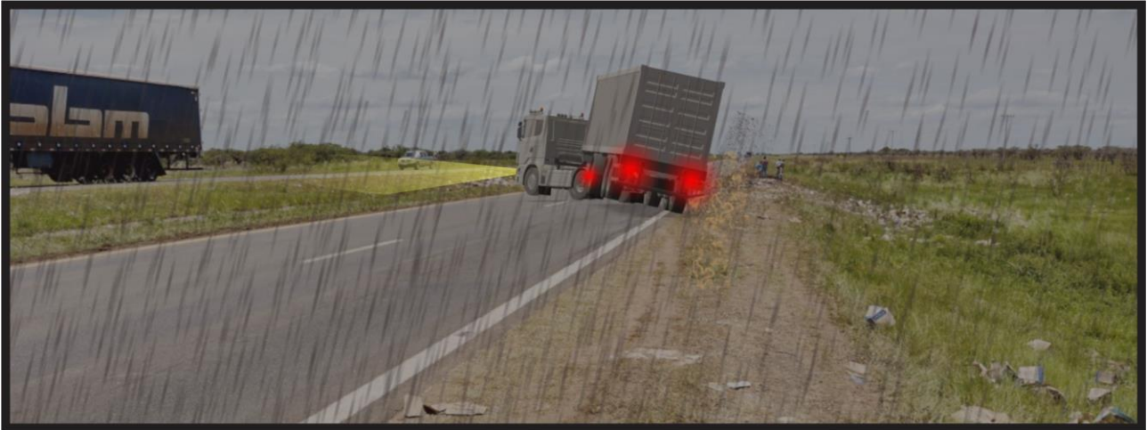
Figura 34. La imagen muestra el proceso de derrape descrito por el Vehículo 1 al reingresar a la calzada, dirigiéndose hacia el cantero central de la autovía. Fuente: JST, 2021.
