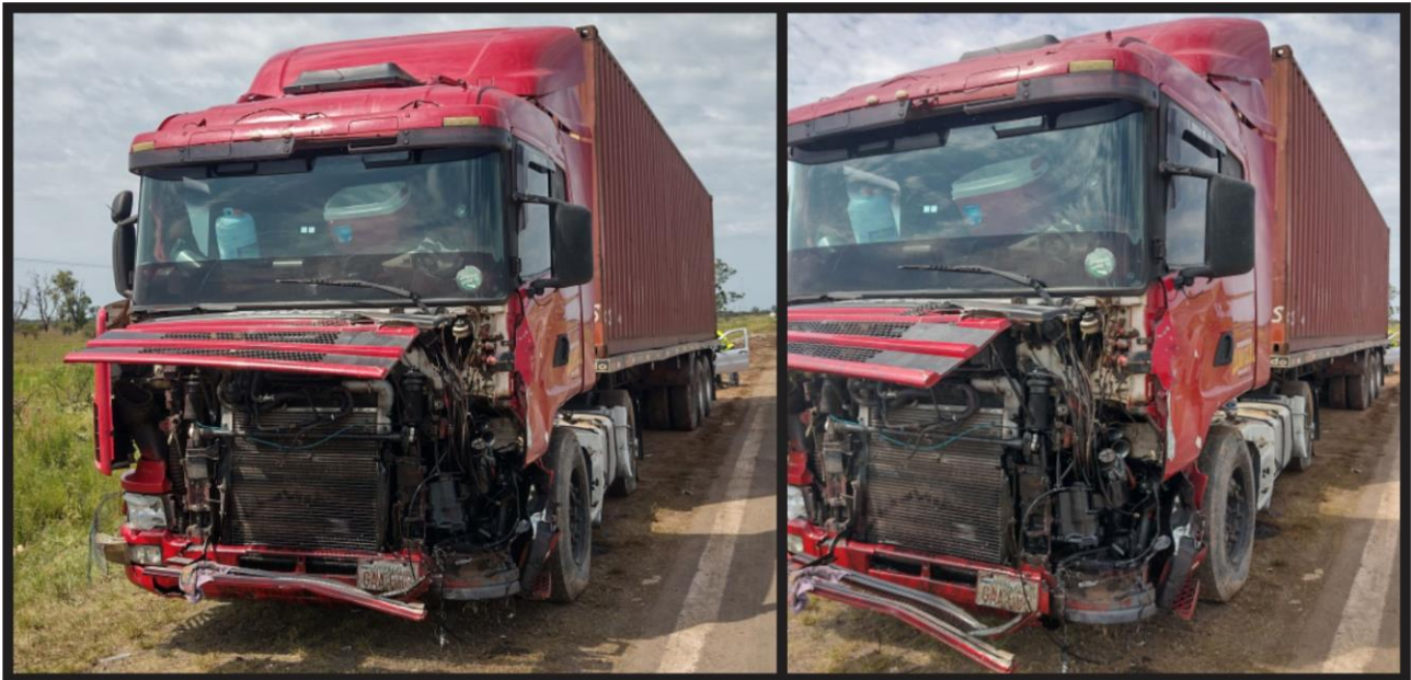
Figura 29. Daños y zona de impacto en el Vehículo 2. Fuente: JST, 2021.
