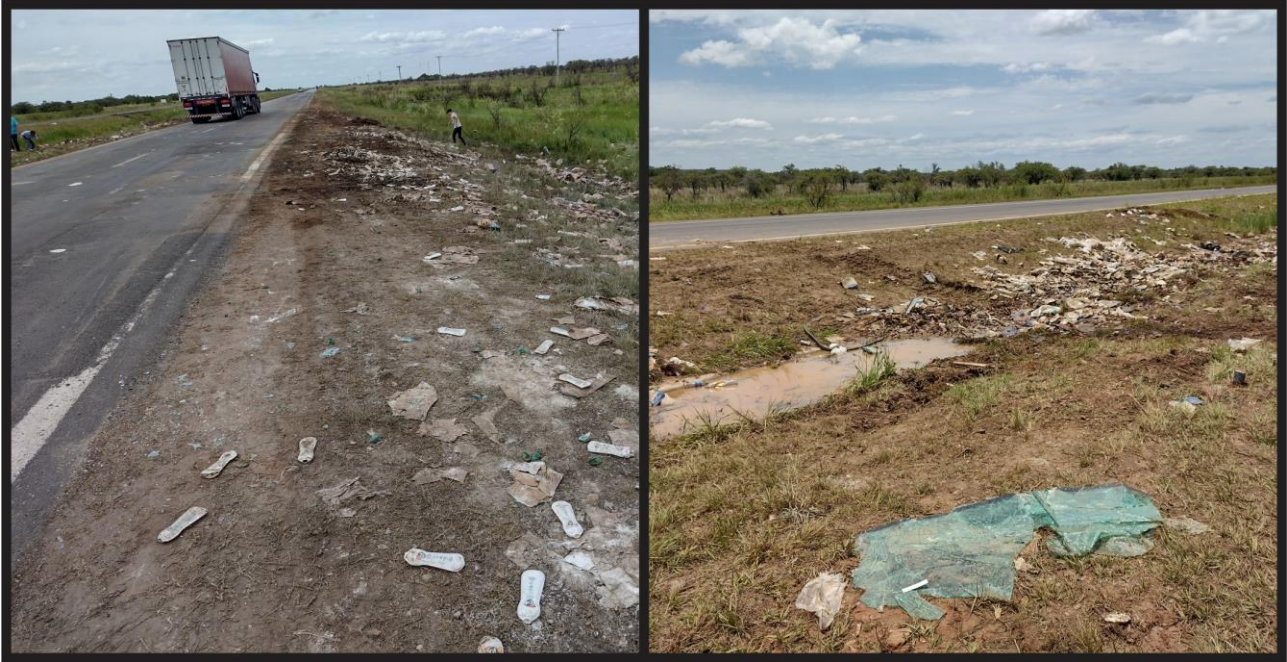
Figura 18. Restos de cristal detectados sobre la banquina sureste, a partir de donde se detectó la dispersión de la carga del Vehículo 1, identificados como I. En la fotografía contigua se observan los restos de cristal de parabrisas del Vehículo 1 situados dentro del cantero central de la ruta, identificados como J. Fuente: JST, 2021.
