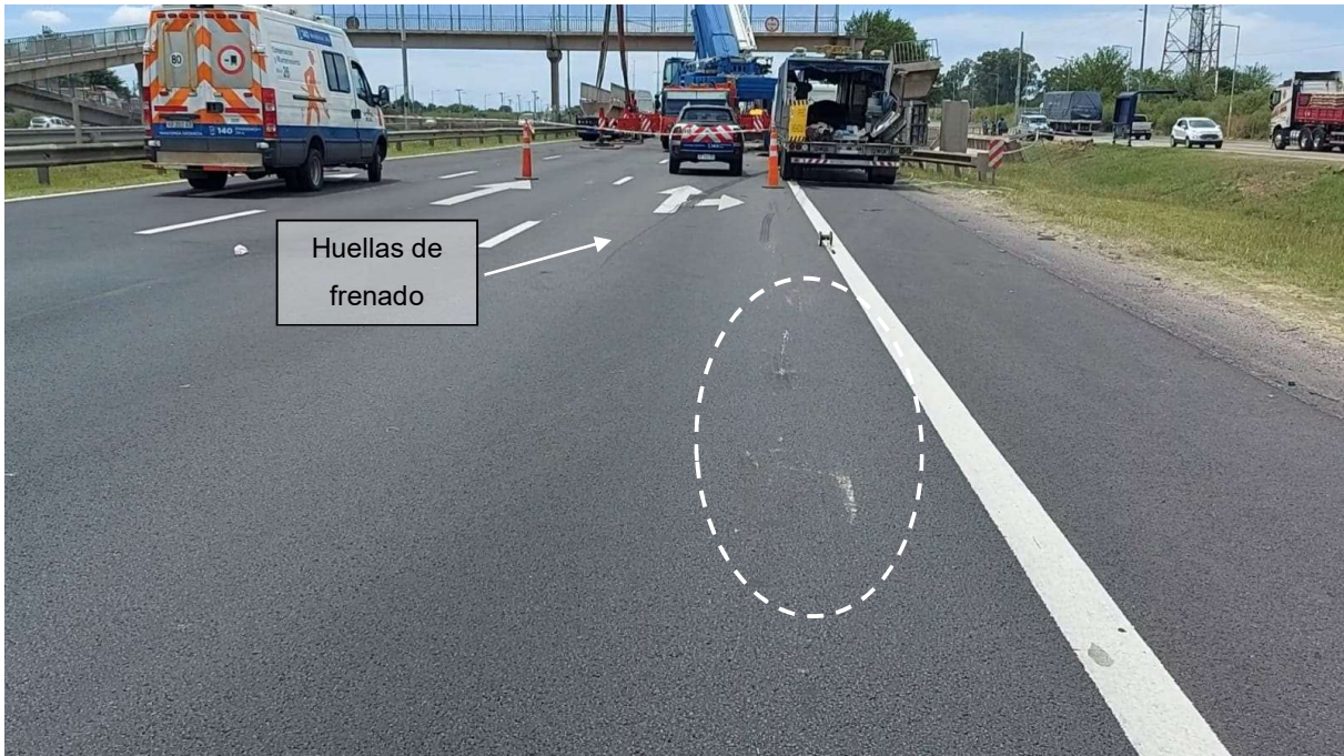
Figura 11. Indicios de arrastre y huellas de frenado en el área de colisión sobre el carril derecho de circulación. Fuente: JST, 2022.
