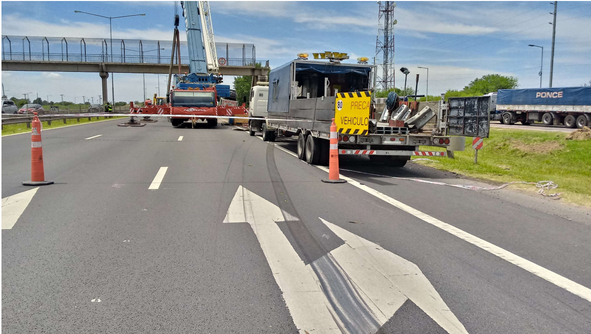
Figura 13. Fotografía de indicios de huellas de frenado duales correspondientes al Vehículo 1, posterior al área de colisión ubicada sobre el carril derecho de circulación. Fuente: JST, 2022.
