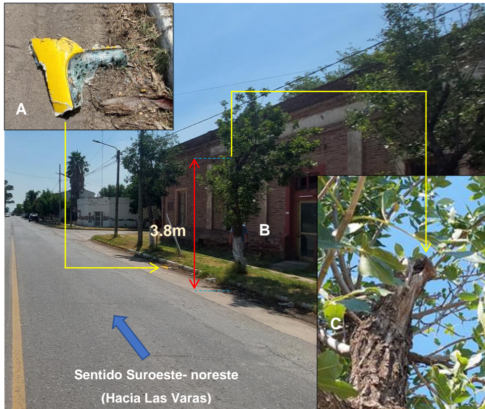
Figura 5. Demarcación de indicios de interés accidentalógico. A) Parte desprendida del vértice superior derecho de la carrocería del ómnibus. B) Árbol con el que habría chocado el ómnibus. C) Rama del árbol con la que habría impactado el vehículo.
