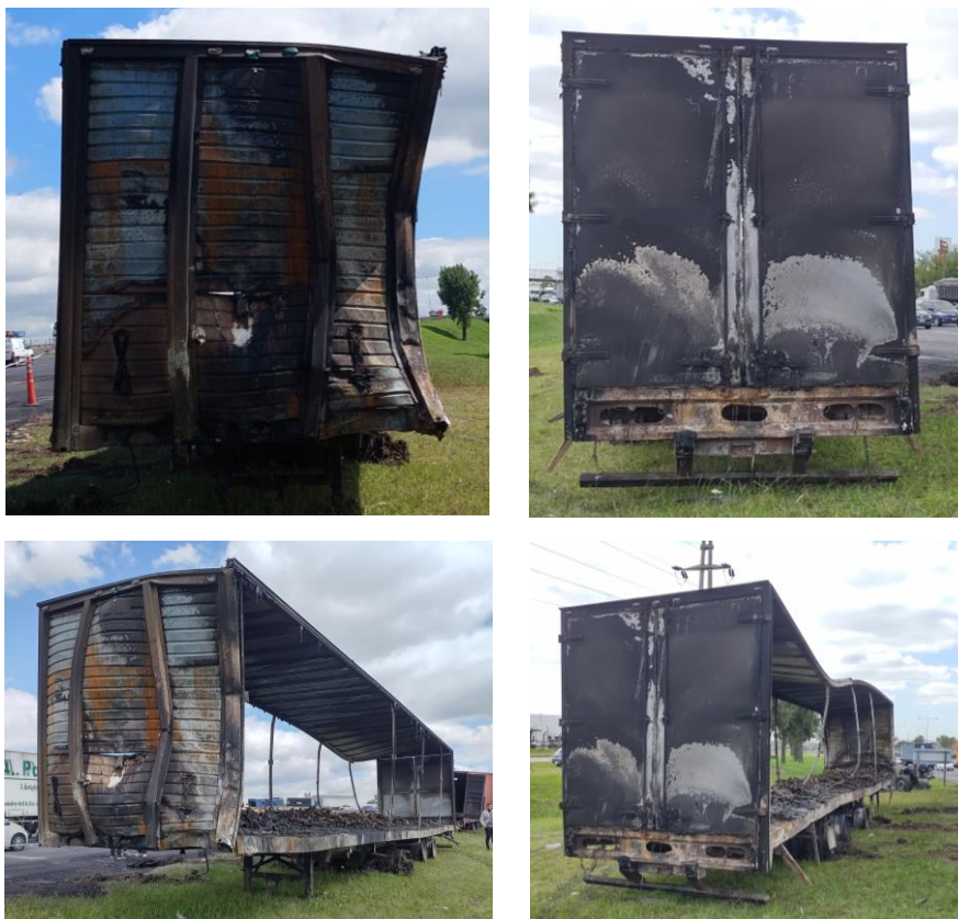
Figura 6. Daños generados en el sector frontal y techo en la colisión con el Vehículo 2. Fuente JST, 2022.
