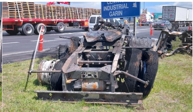
Figura 4. Daños generados en la mitad anterior del chasis Vehículo 1. Fuente JST, 2022.
