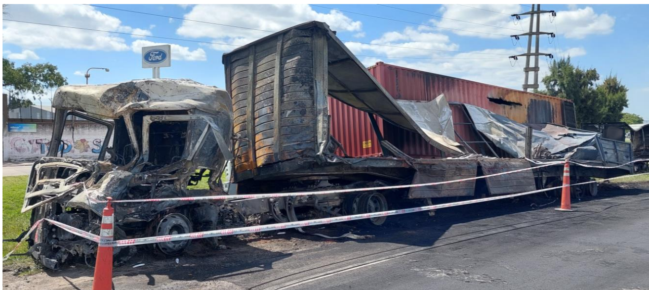
Figura 8. Daños en el frente, lateral izquierdo y techo del semirremolque. Fuente JST, 2022.
