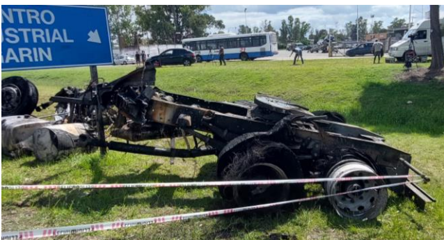
Figura 5. Daños generados en la mitad posterior del chasis Vehículo 1. Fuente JST, 2022.
