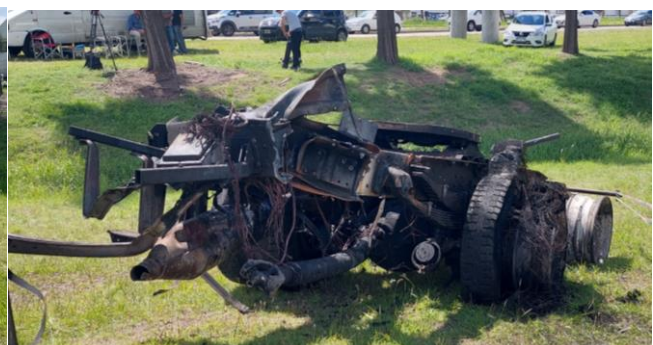
Figura 5. Daños generados en la mitad posterior del chasis Vehículo 1. Fuente JST, 2022.
