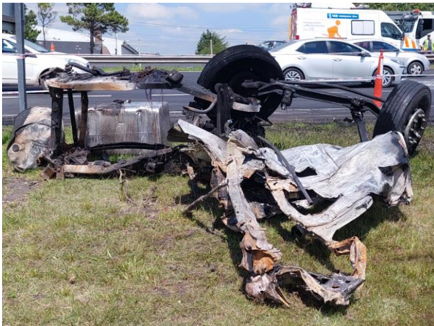
Figura 4. Daños generados en la mitad anterior del chasis Vehículo 1. Fuente JST, 2022.
