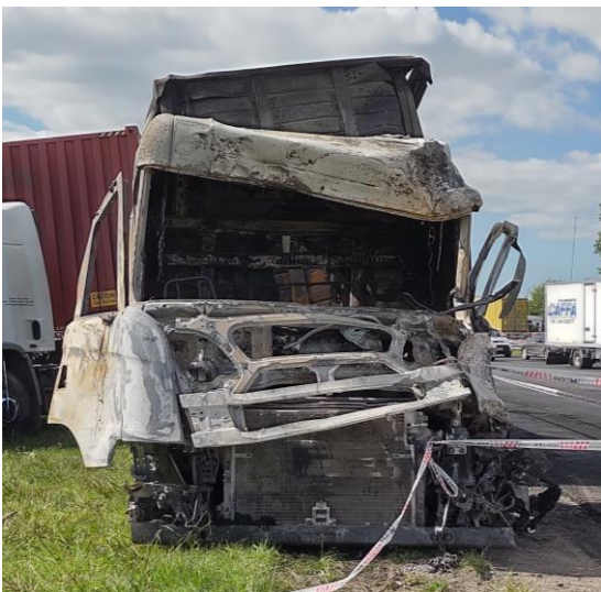
Figura 7. Daños generados en la cabina a causa de la colisión con el Vehículo 2. Fuente JST, 2022.
