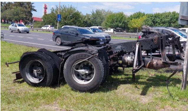
Figura 4. Daños generados en la mitad anterior del chasis Vehículo 1. Fuente JST, 2022.
