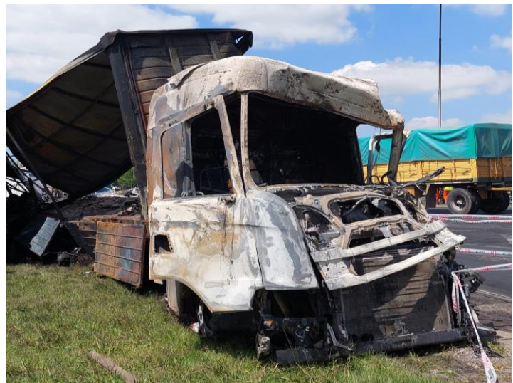
Figura 7. Daños generados en la cabina a causa de la colisión con el Vehículo 2. Fuente JST, 2022.
