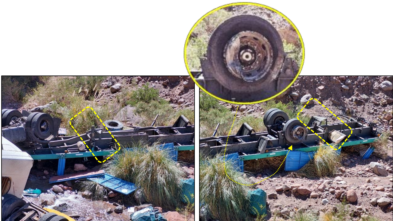
Figura 20. Vista general del semirremolque. Se observan daños estructurales generales en el sector anterior, lateral izquierdo, lateral derecho y sector posterior. Caja con desprendimiento de barandas y chasis con desprendimiento de eje delantero y trasero. En el eje medio, desprendimiento completo del neumático externo derecho, con llanta deformada corroída por óxido. Fuente: JST, 2022
