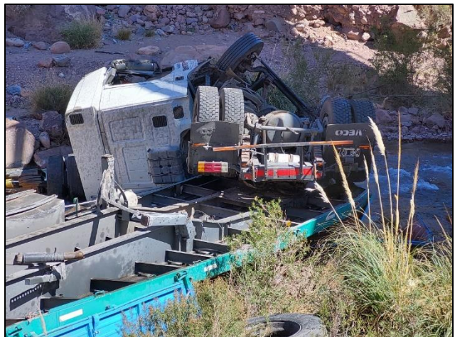
Figura 18. Vista general del camión tractor. Se observan daños estructurales generales en el sector anterior, lateral izquierdo, lateral derecho y sector posterior. Techo y chasis. Fuente: JST, 2022
