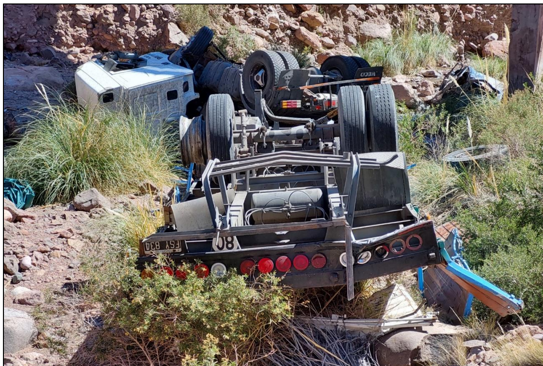
Figura 21. Vista general del vehículo desde la parte trasera. Se observan daños estructurales generales, pérdida del eje trasero completo y desprendimiento completo de un neumático externo en el eje medio. Fuente: JST, 2022
