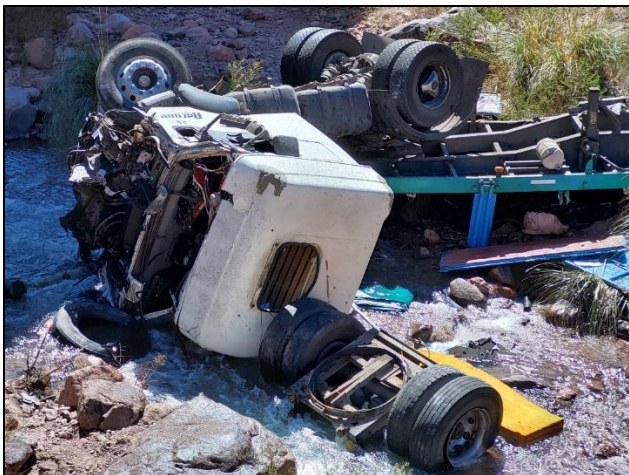
Figura 18. Vista general del camión tractor. Se observan daños estructurales generales en el sector anterior, lateral izquierdo, lateral derecho y sector posterior. Techo y chasis. Fuente: JST, 2022
