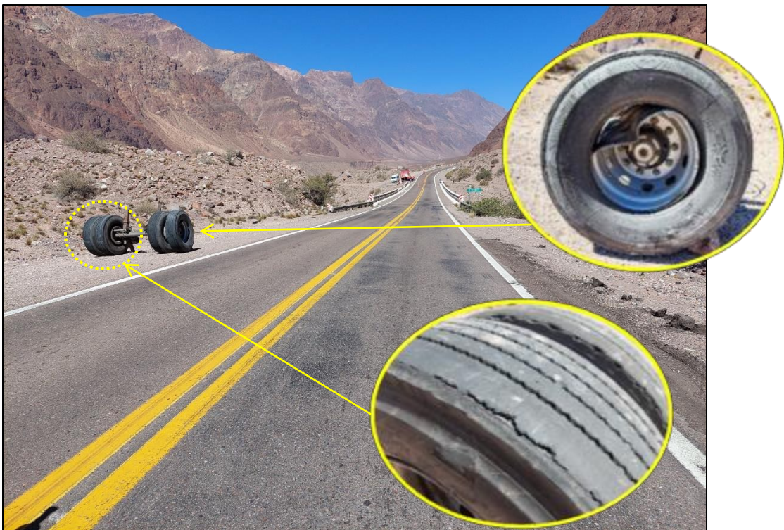
Figura 13. Lugar del suceso. Eje completo perteneciente al semirremolque, ubicado del otro lado del puente, con respecto al accidente. Se puede observar el mal estado de dos de sus cubiertas (recapadas) y una de sus llantas deformadas. Fuente: JST, 2022
