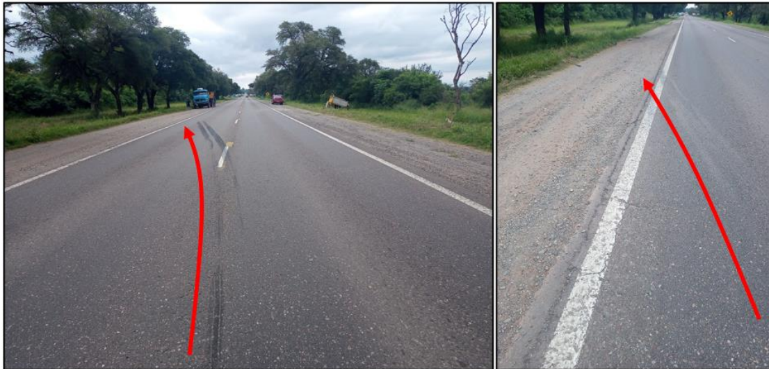
Figura 7. Huellas de derrape demarcadas por el Vehículo 2 sobre la calzada (carril sur-norte) y banquina oeste, luego del impacto. Fuente: JST, 2022
