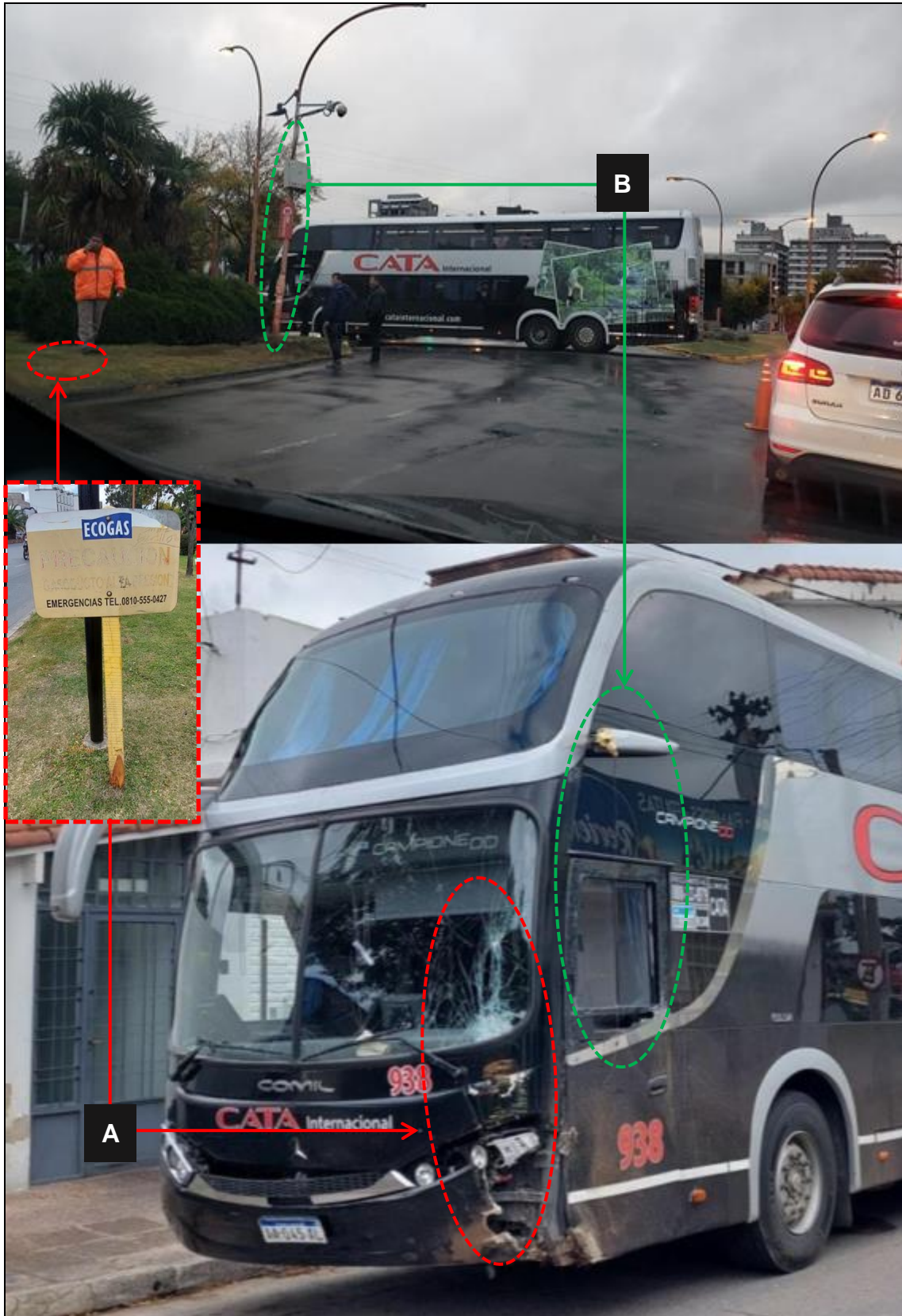
Figura 4. A) Ubicación del lugar y elemento del primer impacto del vehículo. B) Lugar del segundo impacto y correlación de daños materiales en el vehículo. Fuente: JST, 2022
