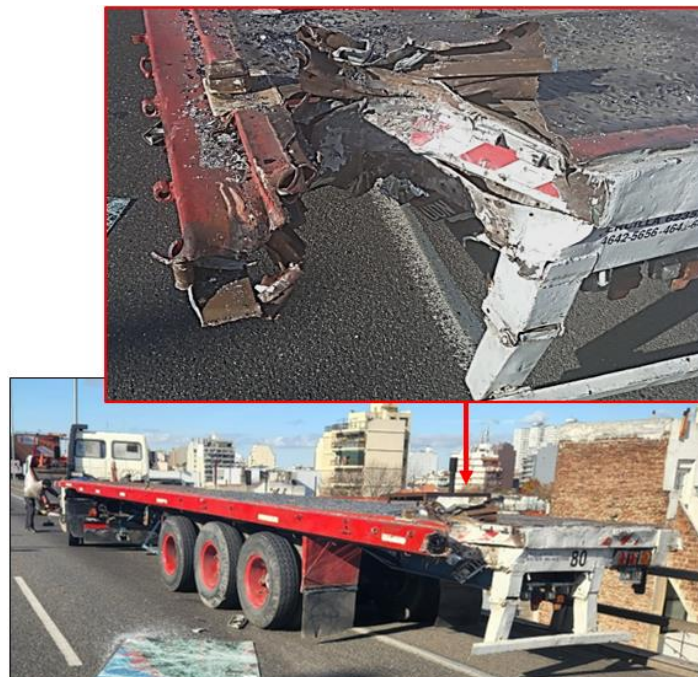
Figura 10. Daños en el semirremolque del Vehículo 2. Fuente: Master Bus SA, 2022
