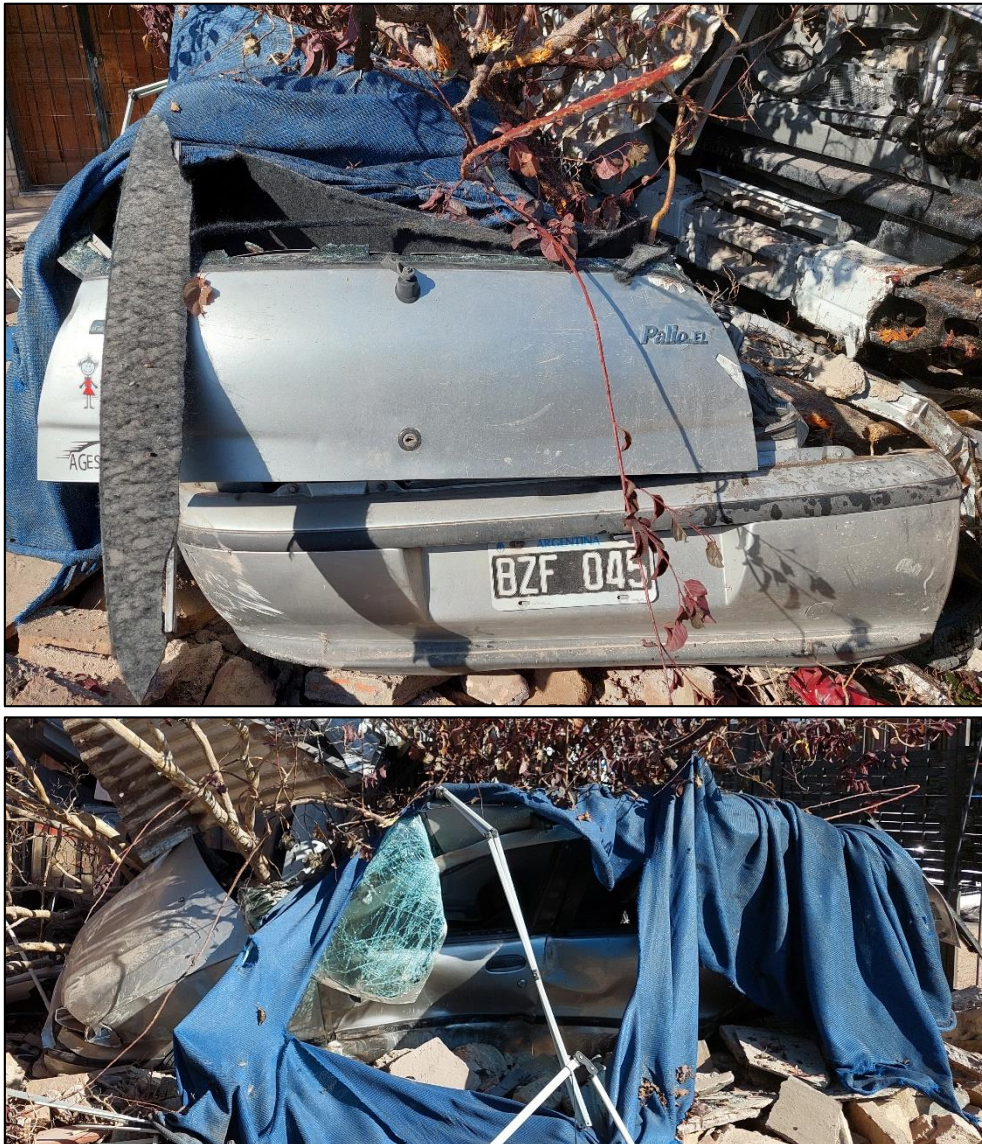
Figura 23. Fotografías del Vehículo 5. Destrucción general. Daños en el sector anterior, lateral derecho, sector posterior, lateral izquierdo y techo. Fuente: JST, 2022
