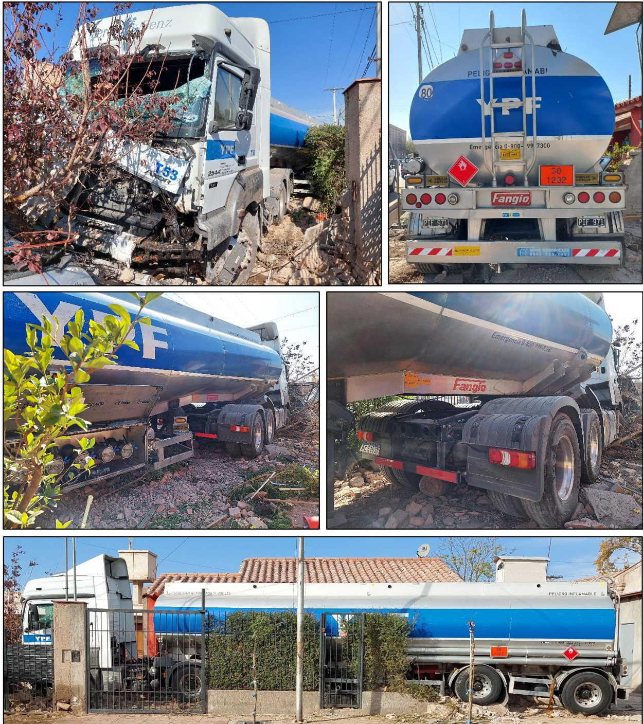
Figura 19. Fotografías del Vehículo 1. Daños estructurales en el sector anterior de la unidad tractora y abrasiones en los laterales izquierdo y derecho del semirremolque. Fuente: JST, 2022
