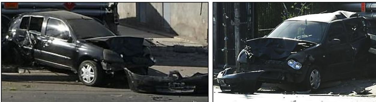
Figura 20. Fotografías del Vehículo 2. Daños en el sector anterior, lateral derecho, sector posterior, lateral izquierdo y techo. Fuente: Los Andes , 2022
