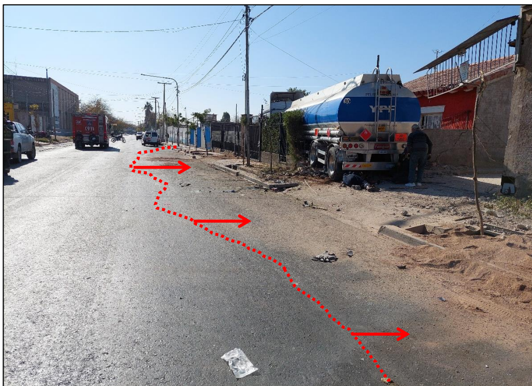
Figura 7. Posición final del Vehículo 1. A lo largo del carril de estacionamiento, se hallaban restos plásticos y fluidos mecánicos. En la acequia se halló combustible, que fue cubierto de arena. Fuente: JST, 2022
