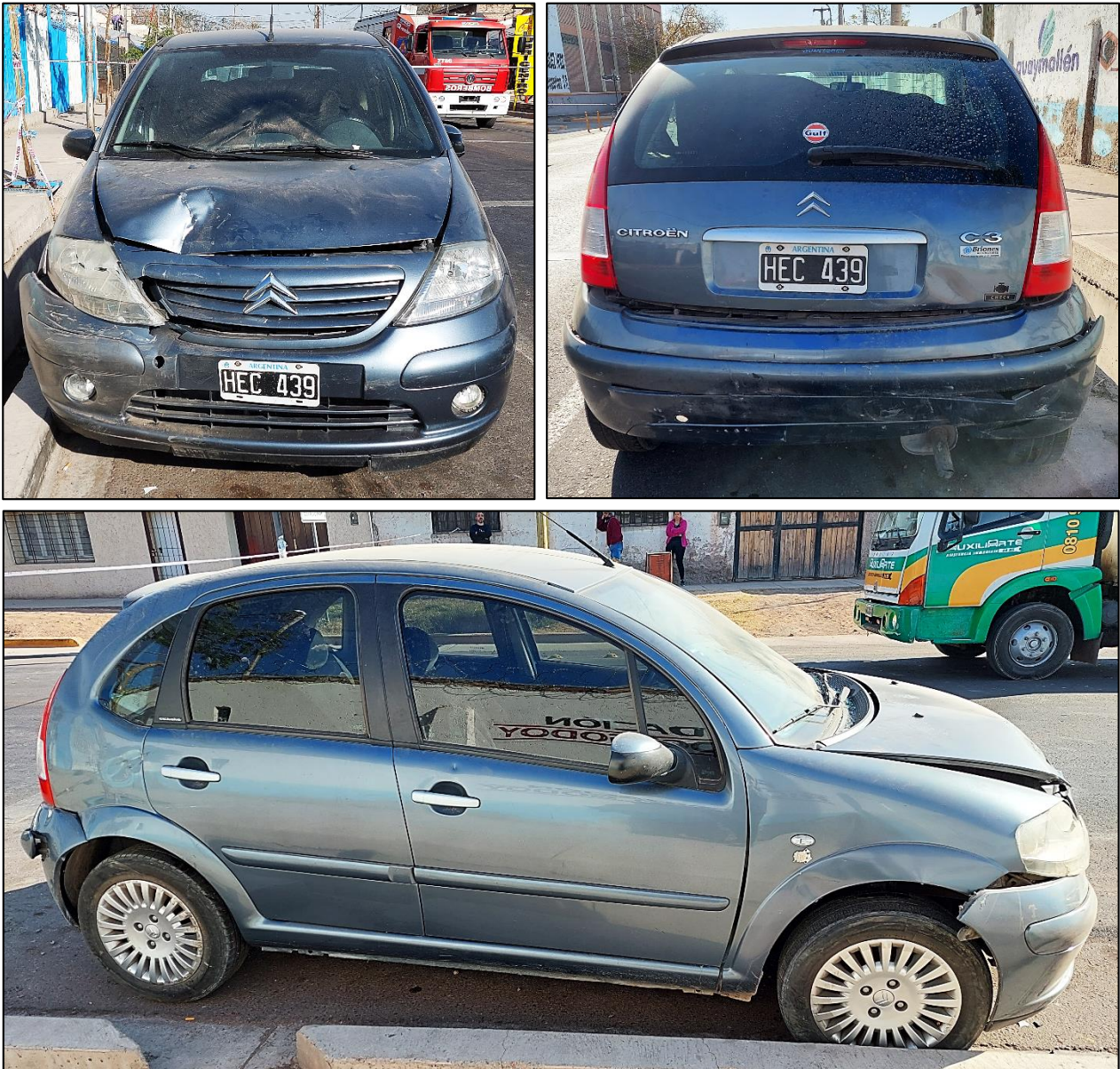
Figura 21. Fotografías del Vehículo 3. Daños en el sector anterior, lateral derecho y sector posterior. Fuente: JST, 2022
