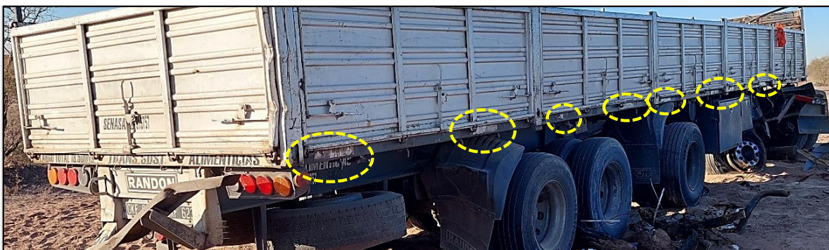
Figura 14. Estado de las bandas retrorreflectivas del semirremolque correspondiente al Vehículo 1. Fuente: JST, 2022
