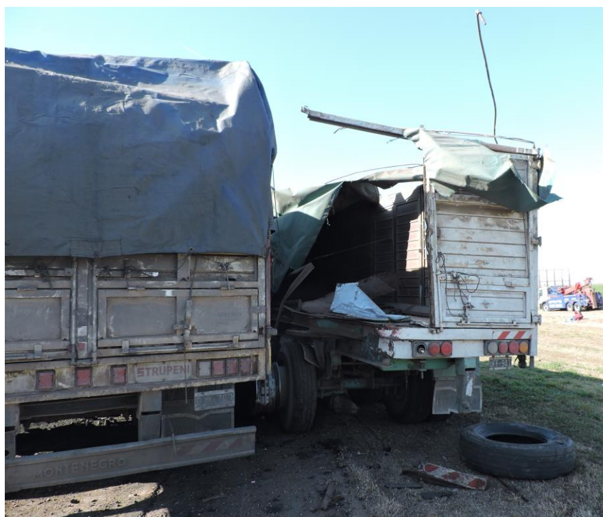
Figura 19. Detalle de los daños presentes en la parte lateral izquierda del acopado. Fuente JST, 2022
