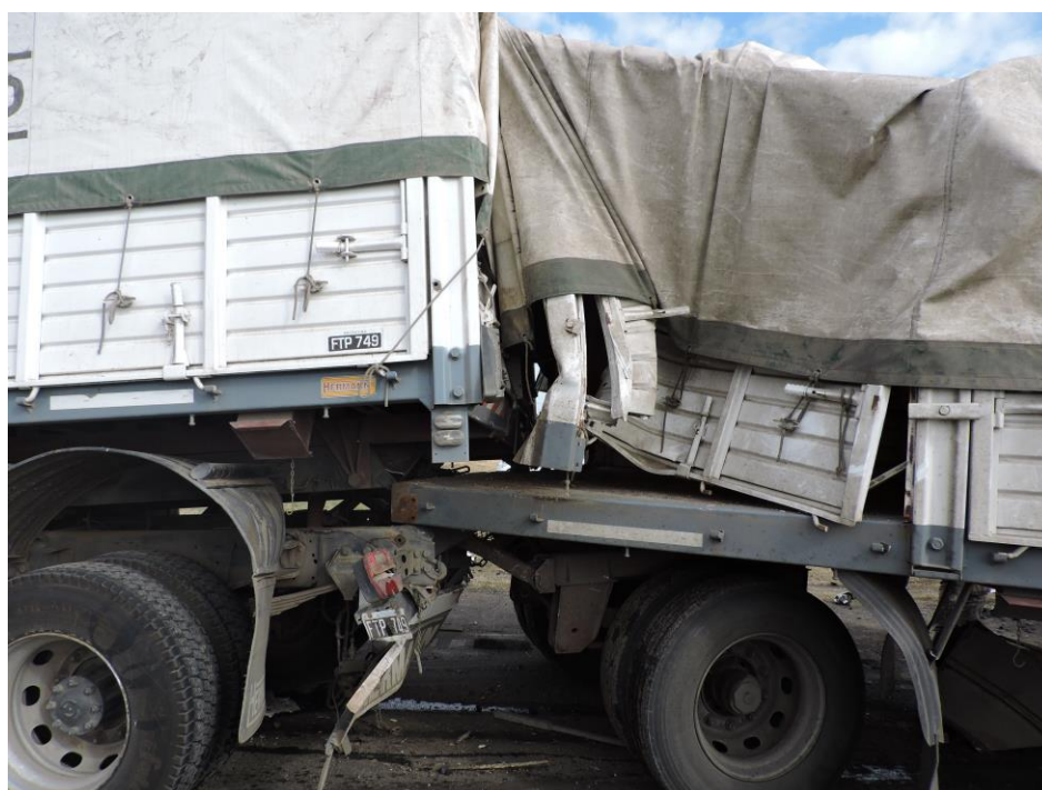
Figura 16. Detalle de los daños presentes en la parte posterior de la unidad tractora y la anterior de la transportada, vista izquierda. Fuente: JST, 2022
