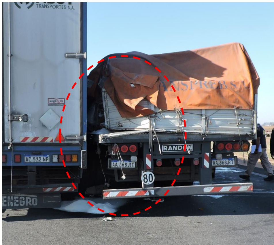
Figura 7. Detalle de los daños en el vértice posterior izquierdo del Vehículo 2. Fuente: JST, 2022
