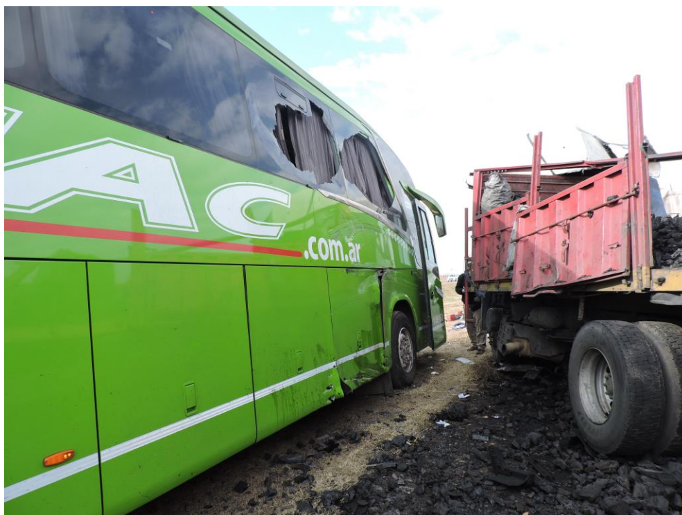
Figura 24. Detalle de los daños presentes en la parte lateral anterior derecha del ómnibus. Fuente: JST, 2022
