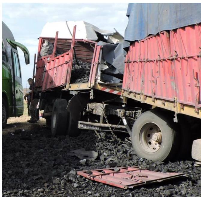
Figura 22. Detalle de los daños presentes en la caja del camión tractor, parte lateral izquierda.
