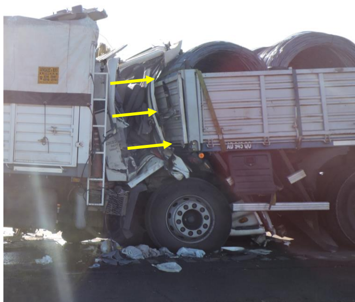
Figura 13. Ubicación de los daños, parte posterior del Vehículo 6, vista derecha. Fuente: JST, 2022
