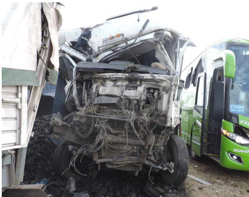
Figura 21. Detalle de los daños presentes en la parte frontal del camión tractor. Fuente: JST, 2022
