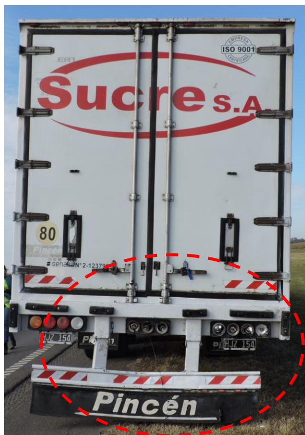
Figura 9. Detalle de los daños en la parte posterior del Vehículo 4. Fuente: JST, 2022
