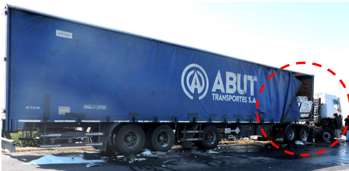
Figura 9. Detalle de los daños en el lateral anterior derecho del Vehículo 3. Fuente: JST, 2022
