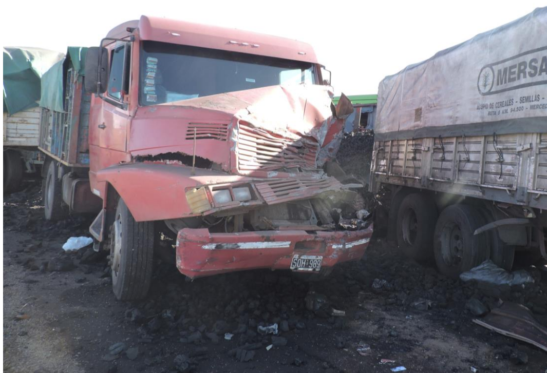
Figura 18. Detalle de los daños presentes en la parte frontal de la unidad tractora. Fuente: JST, 2022
