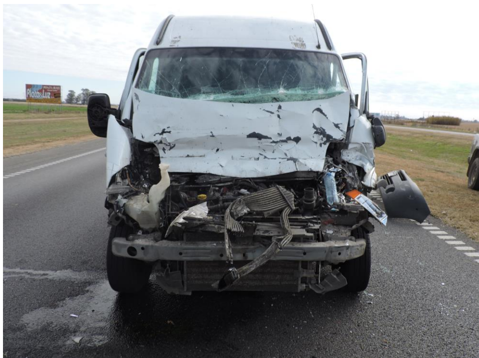
Figura 11. Detalle de los daños en la parte frontal del Vehículo 5. Fuente: JST, 2022
