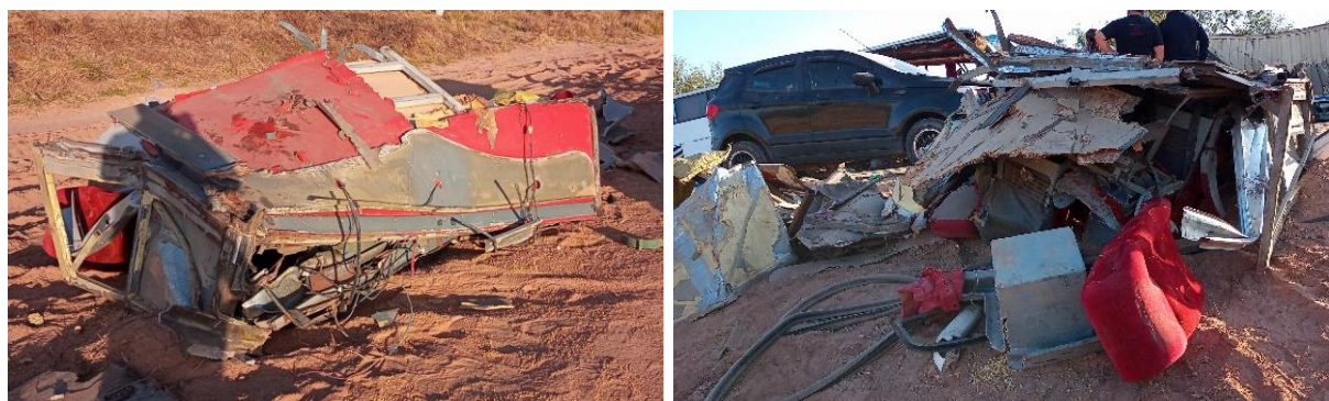
Figura 8. Parte superior frontal del ómnibus desprendida de la unidad. Fuente: JST, 2022
