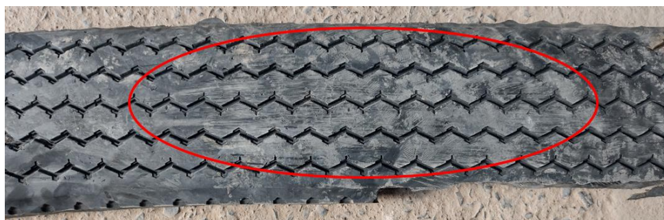
Figura 13. Abrasiones apreciadas en la superficie externa, sector medio, de la banda de rodamiento del neumático colapsado. Fuente: JST, 2022
