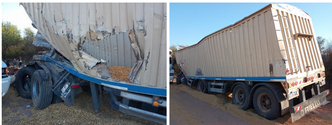
Figura 22. Daños constatados en el semirremolque del Vehículo 2. Fuente: JST, 2022
