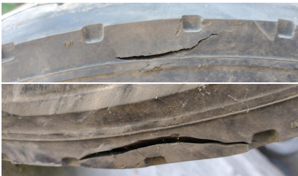
Figura 18. Cortes observados en la cara interna de los hombros del neumático delantero derecho.
