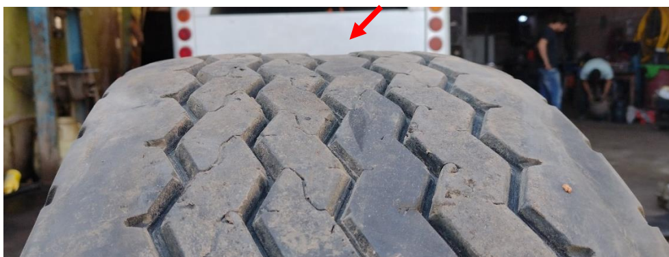
Figura 17. Depresión verificada en la superficie del sector medio de la capa de rodadura del neumático delantero derecho. Fuente: JST, 2022
