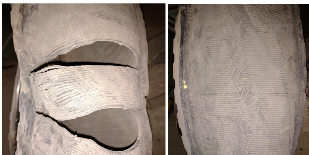
Figura 14. Daños y cortes perpendiculares en la lona de la carcasa del neumático delantero izquierdo del ómnibus. Fuente: JST, 2022
