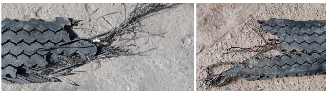
Figura 12. Extremos de la banda de rodadura desprendida que evidencian la zona de separación del resto del neumático. Fuente: JST, 2022
