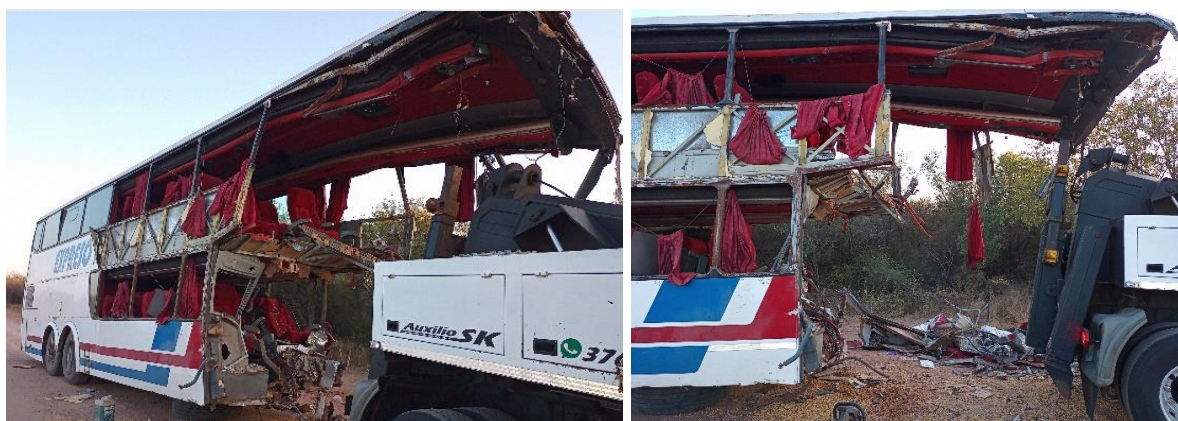
Figura 5. Parte principal de la unidad afectada por la colisión: sector frontal, medio inferior y superior. Fuente: JST, 2022
