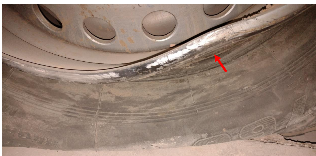
Figura 15. Deformación del perfil de la llanta de la rueda delantera izquierda. Fuente: JST, 2022
