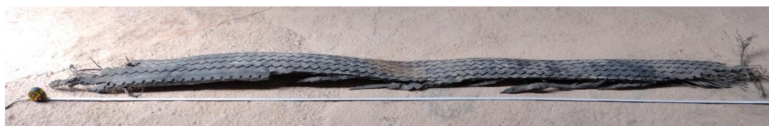
Figura 10. Banda de rodadura desprendida del neumático delantero izquierdo del ómnibus. Fuente: JST, 2022
