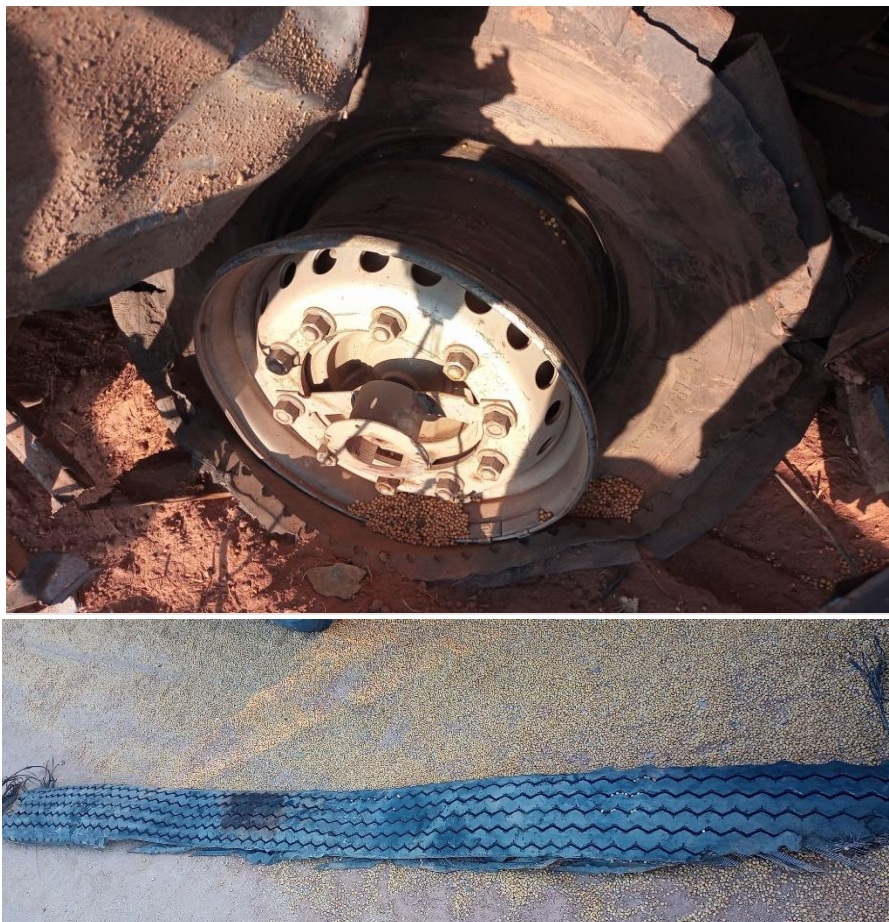
Figura 26. Neumático delantero izquierdo (arriba) y banda de rodamiento desprendida, hallada en el lugar del suceso (abajo). Fuente: JST, 2022
