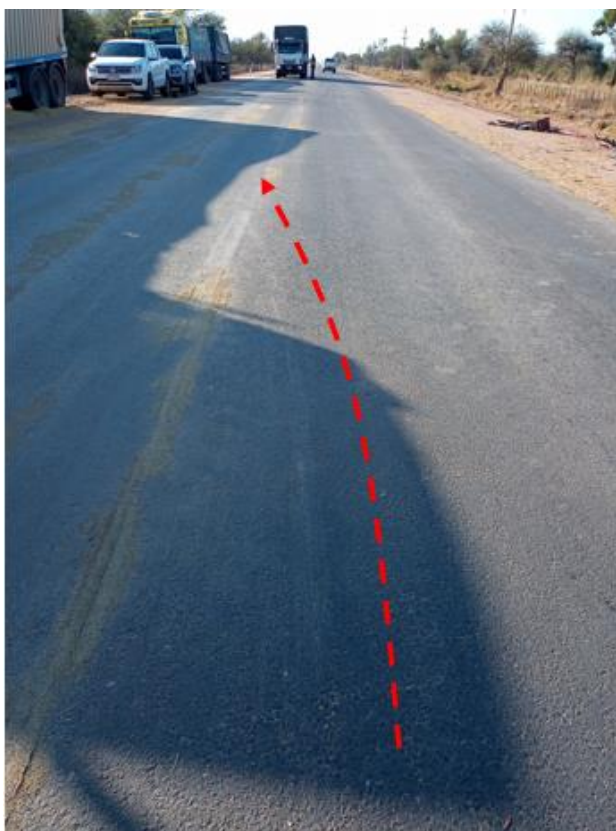
Figura 25. Huella dejada por el neumático delantero izquierdo del ómnibus luego del reventón.
