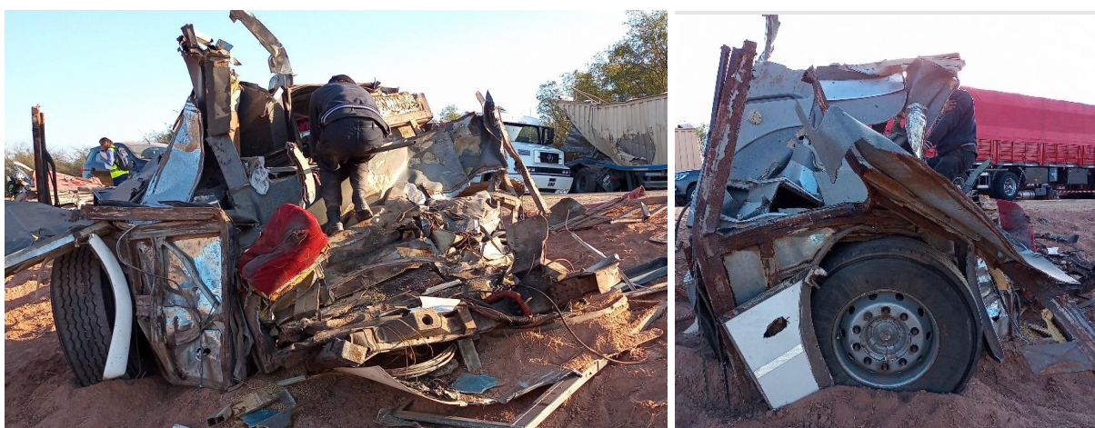
Figura 7. Parte inferior frontal del ómnibus desprendida de la unidad. Fuente: JST, 2022
