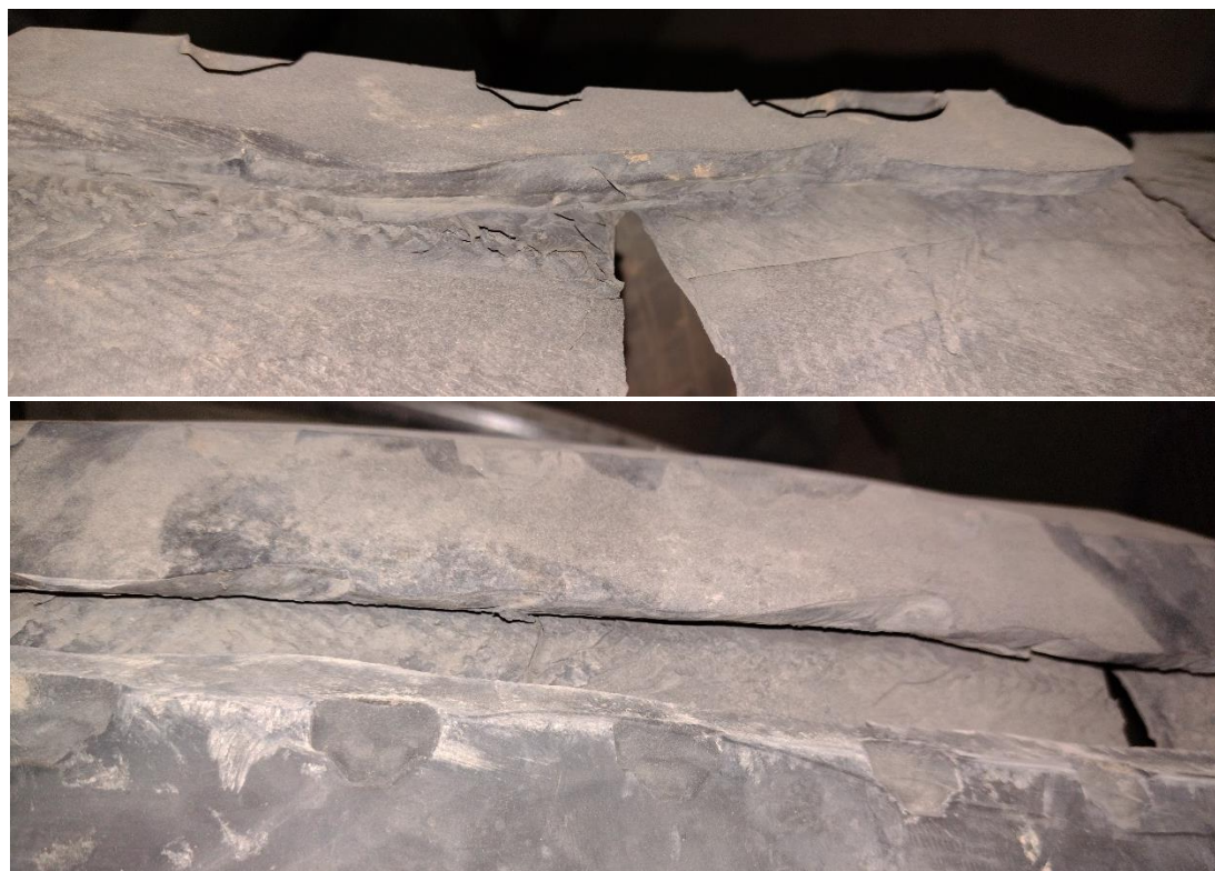
Figura 11. Zona de desgarro longitudinal de la capa de rodamiento en el hombro de la carcasa (arriba). Banda de rodadura desprendida presentada sobre la carcasa del neumático para ilustrar el desgarramiento longitudinal (abajo). Fuente: JST, 2022
