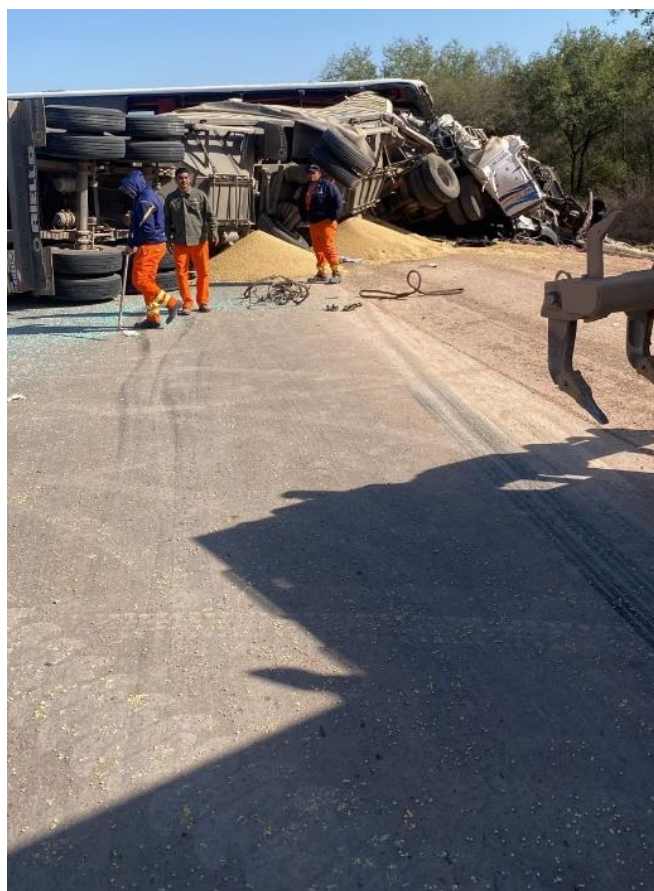
Figura 31. Vista este-oeste de la posición y ubicación final del camión y semirremolque luego del accidente. Se observan con mayor claridad las huellas de frenadas demarcadas por la unidad en instantes previos a la colisión. Fuente: Expreso del Plata SRL, 2022
