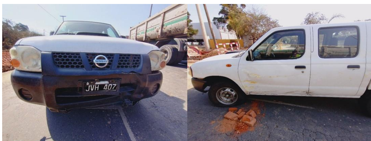
Figura 18. Daños sobre el vehículo 10. Fuente: JST, 2022
