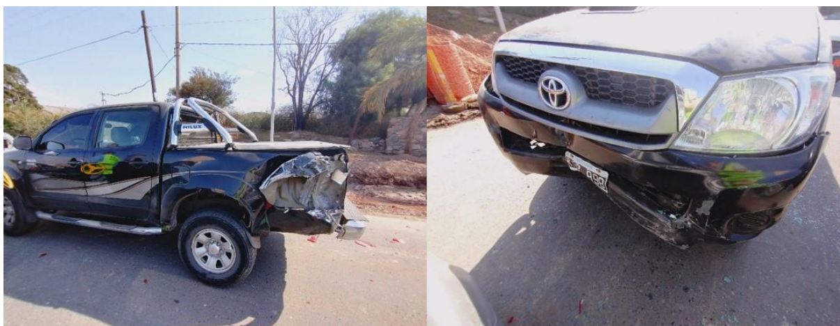
Figura 13. Daños sobre el Vehículo: lado derecho de la caja y paragolpes delantero. Fuente: JST, 2022
