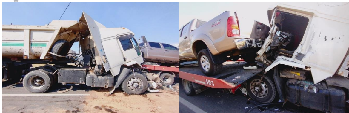
Figura 8. Daños sobre la cabina del vehículo 1. Fuente: JST, 2022.
