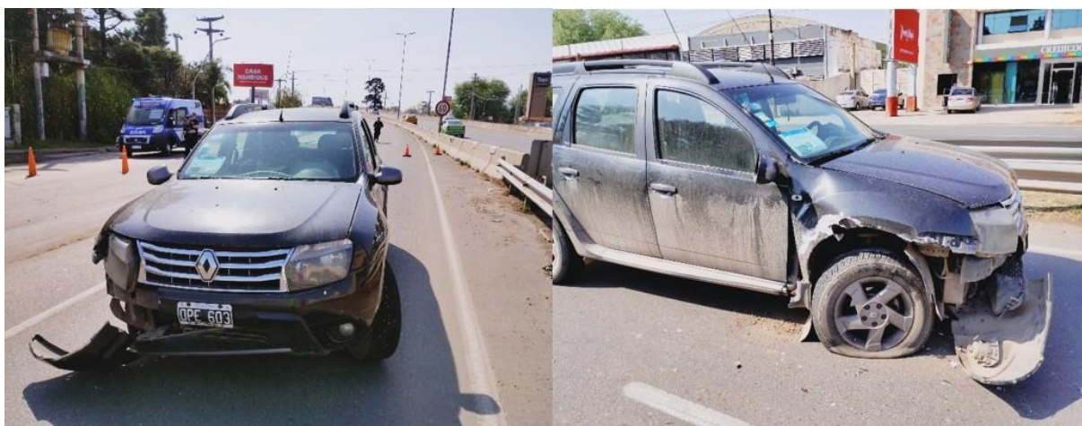
Figura 11. Daños sobre el Vehículo 3 sobre la parte anterior, con predominancia sobre el vértice izquierdo. Fuente: JST, 2022
