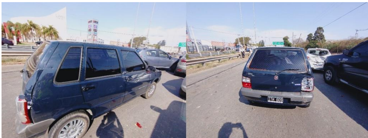
Figura 12. Daños en el vehículo 4 sobre parte trasera. Fuente: JST, 2022
