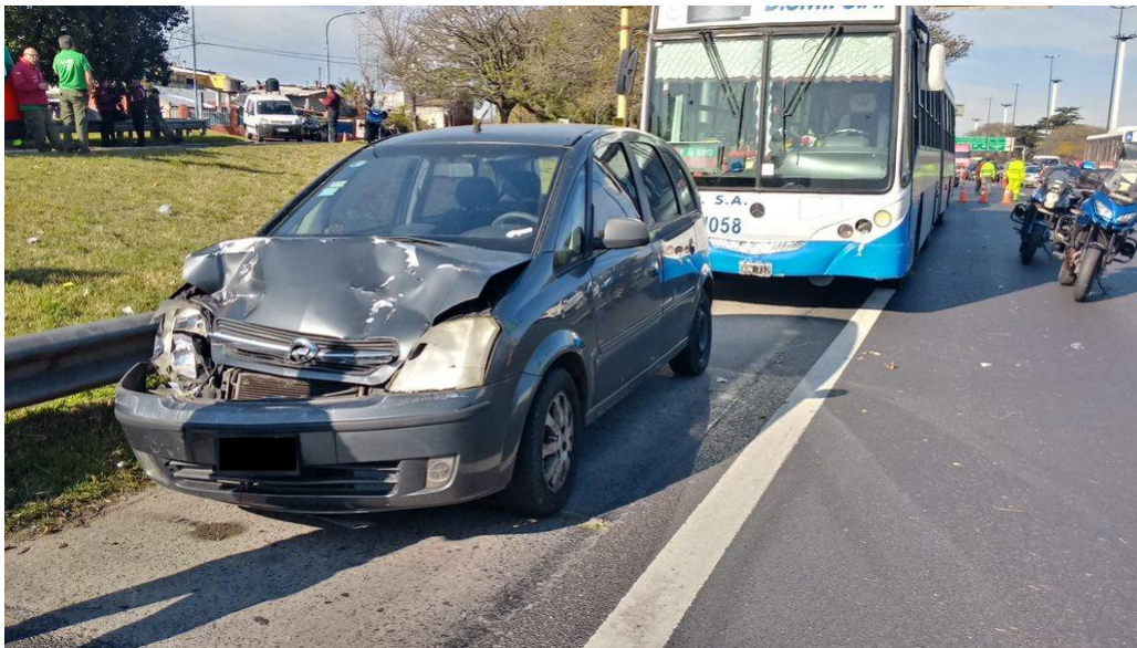
Figura 9. Daños en Vehículo 3. Fuente JST, 2022
