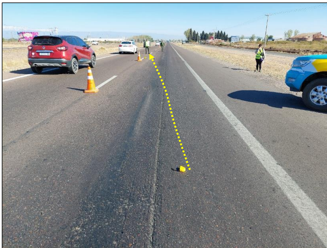
Figura 9. Fotografía tomada dos días después del suceso. Huella de derrape de 19,2 metros de longitud, situada sobre el carril norte (derecho de la imagen), con dirección hacia el suroeste. Con cambio de iluminación (incidencia del sol) se aprecia una huella más extensa y continua que en el día del suceso. Fuente: JST, 2022
