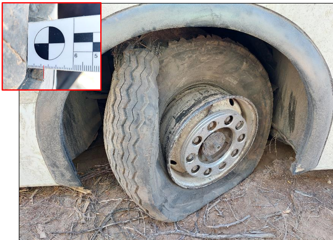
Figura 25. Rueda delantera izquierda (TOPRUNNER CR918 385/65R22.5) del Vehículo 1, luego de haber sido remolcado al predio de GNA para su secuestro. La rueda se encontraba completamente desinflada, con la base y perfiles internos a la vista. Profundidad de las ranuras de la banda de rodamiento: 12 milímetros. Fuente: JST, 2022
