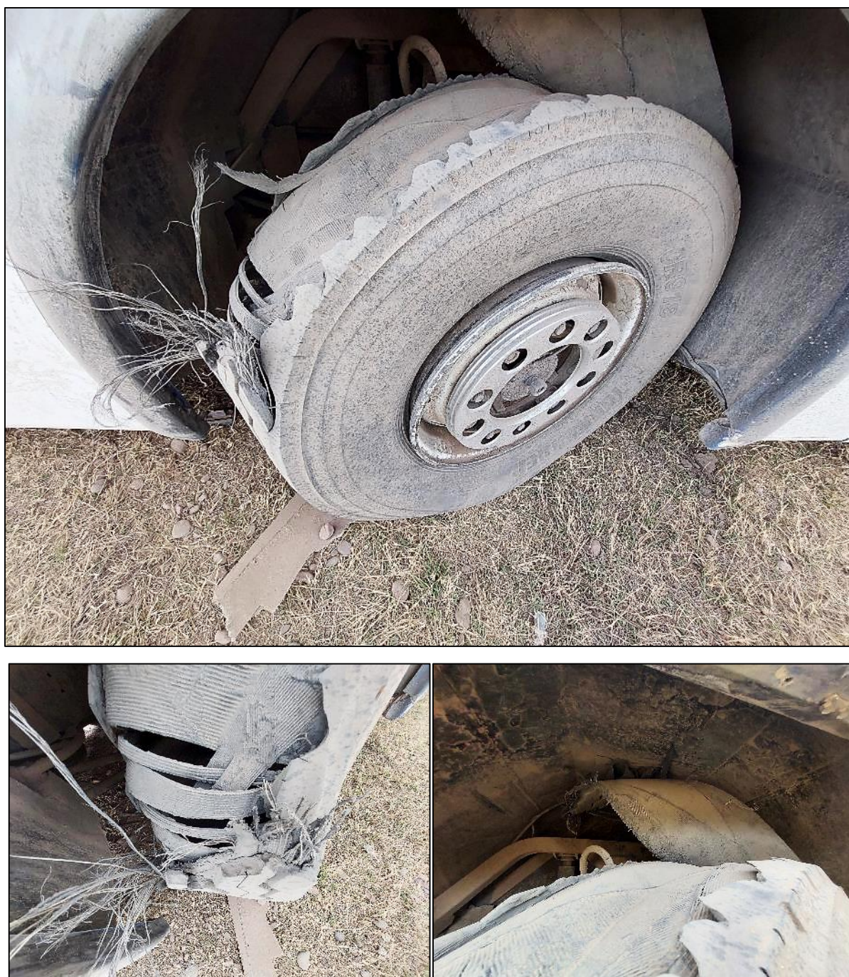
Figura 18. Rueda delantera izquierda (TOPRUNNER CR918 385/65R22.5) luego de regresar a su posición normal al Vehículo 1 volcado. La rueda se encontraba parcialmente desbandada, con los cables de acero expuestos. Fuente: JST, 2022
