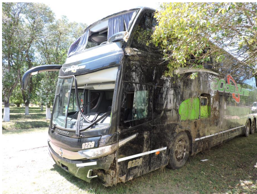
Figura 7. Vista desde el vértice izquierdo del vehículo, detalle de daños. Fuente: JST, 2022
