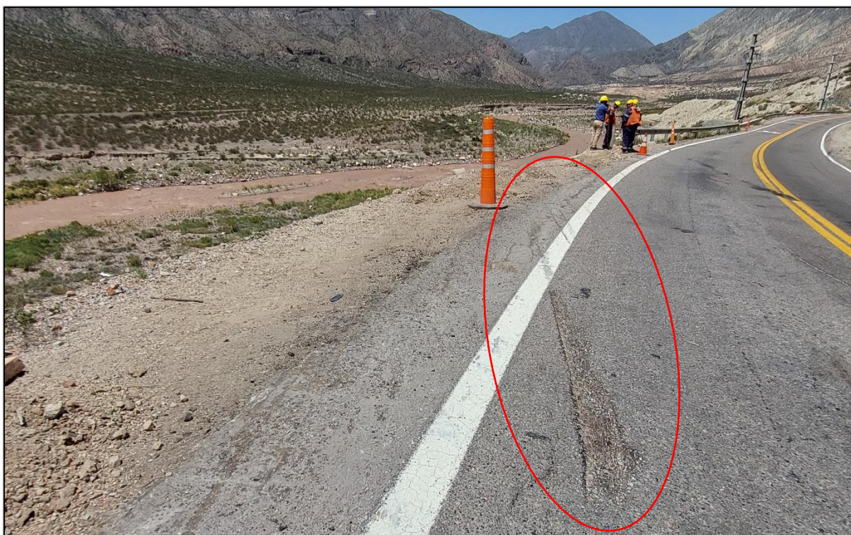
Figura 20. Zona de arrastre del Vehículo 1 y Vehículo 4. Sobre el carril externo de la curva, se observan marcas con dirección hacia el barranco. Fuente: JST, 2023
