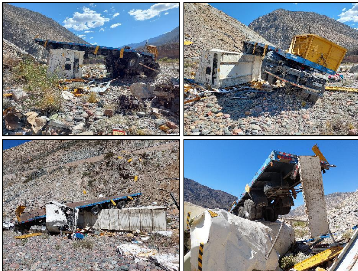
Figura 17. Daños materiales del semirremolque y contenedor del Vehículo 1. Fuente: JST, 2023
