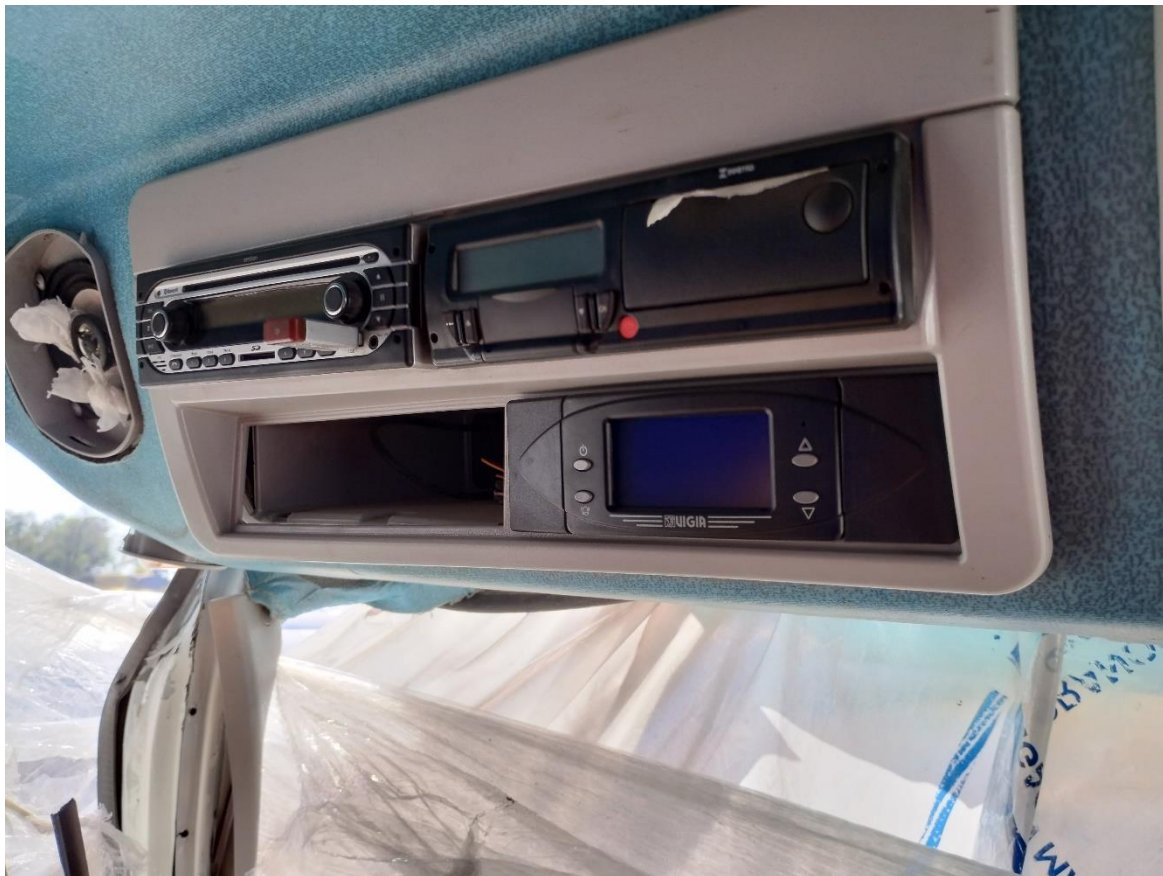
Figura 7. Tacógrafo del Vehículo 1 fuera de funcionamiento, momentos posteriores al suceso. Fuente: JST, 2023
