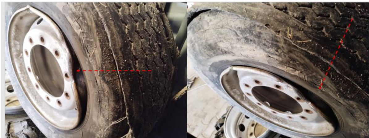
Figura 10. Daños constatados en el neumático trasero del Vehículo 2, con deformación de la llanta y rotura de la cubierta. Fuente: JST, 2023
