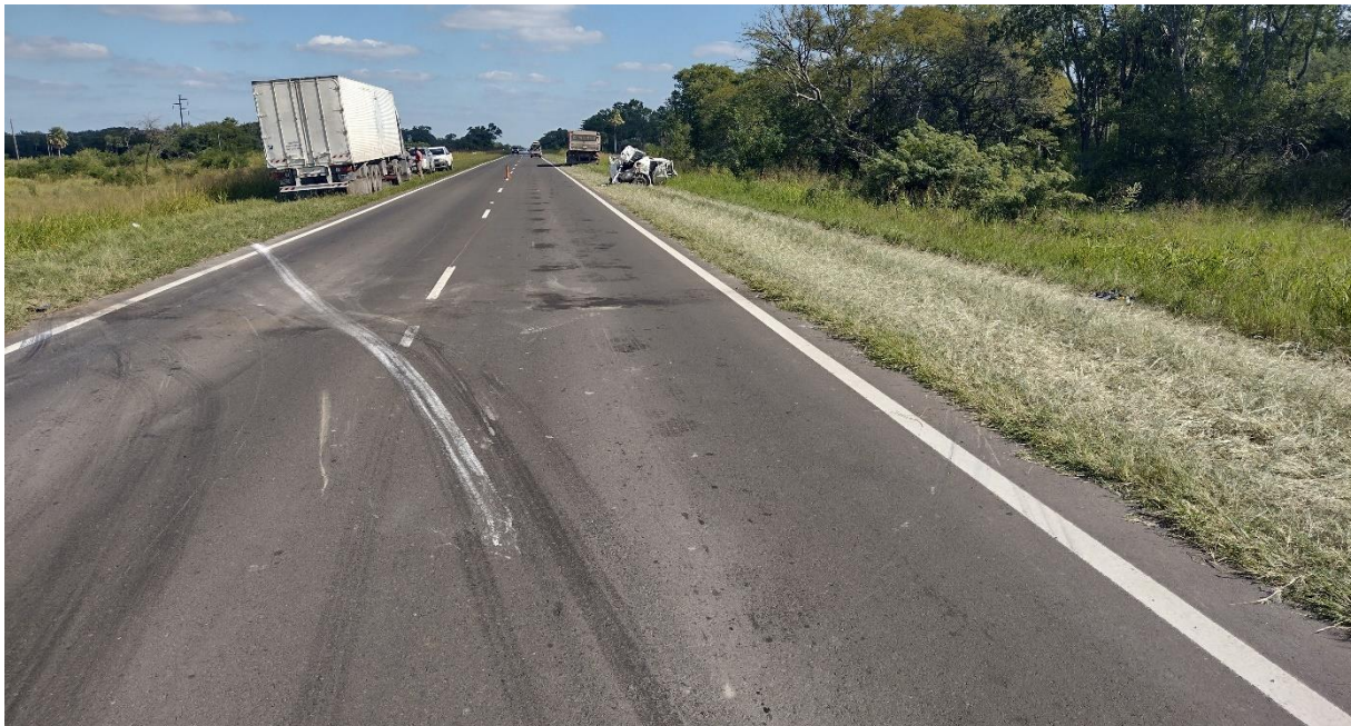
Figura 22. La imagen muestra el lugar de la vía donde se halló una de las zonas de impacto caracterizada por la presencia de marcas de fricción y huellas de neumático en diferentes direcciones, así como la presencia de derrame de fluidos. Fuente: JST, 2023
