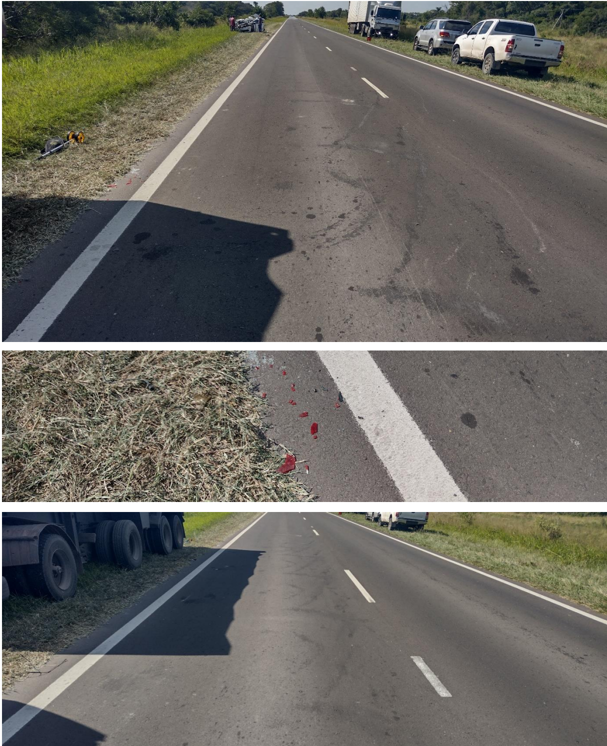
Figura 32. Las imágenes muestran las manchas de fluido con efracciones y restos de óptica hallados metros más adelante de la posición del Vehículo 7. Además, puede observarse que las efracciones se proyectaron hasta la posición registrada del rodado. Fuente: JST, 2023
