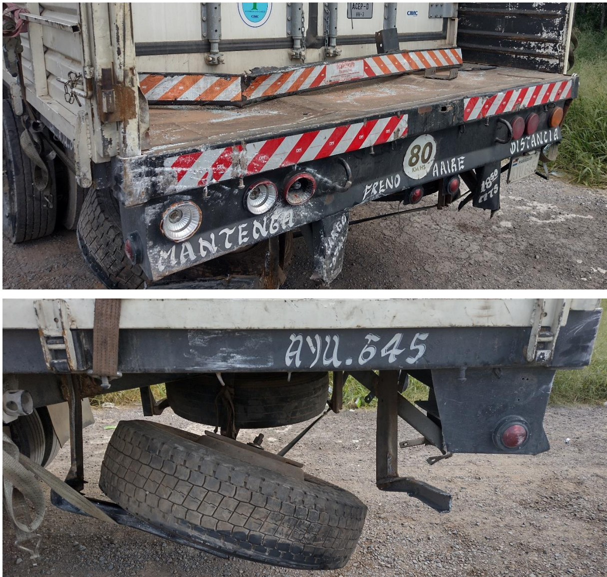
Figura 15. Vista posterior de los daños en la zona de impacto del semirremolque del Vehículo 5.
