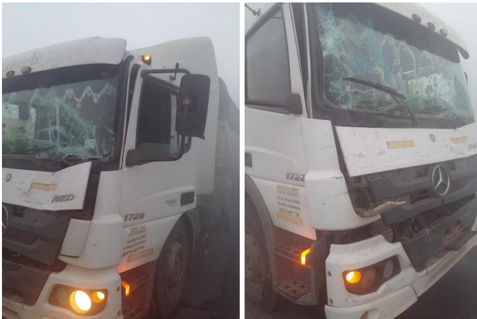
Figura 8. Las imágenes muestran los daños observados en la unidad tractora del Vehículo 3. Fuente: Policía de La Leonesa. 2023
