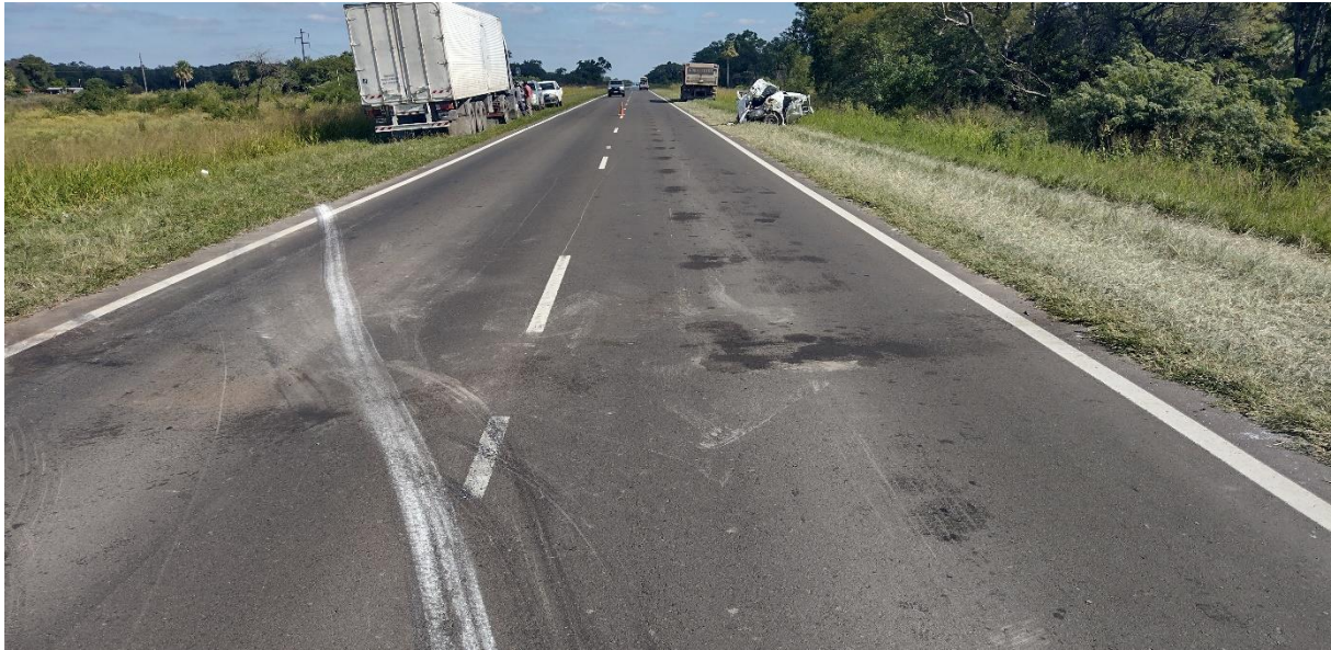
Figura 28. Vista de las manchas de fluido observadas con intermitencia luego de la zona de impacto y sobre el carril que conduce a la ciudad de Margarita Belén. Fuente: JST, 2023
