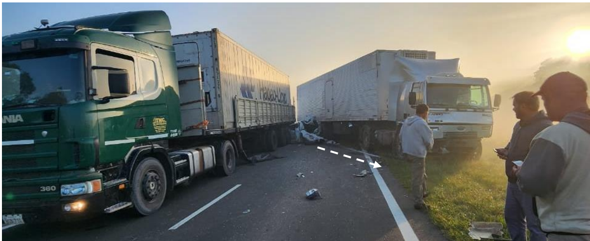
Figura 26. En la fotografía, se aprecia la posición final original del Vehículo 11, de forma oblicua sobre el carril y la banquina contraria, donde además resulta apreciable la marca de fricción que culminó bajo la estructura derecha de la unidad tractora, la cual es indicada en la imagen con una línea discontinua. Fuente: Policía de La Leonesa, 2023
