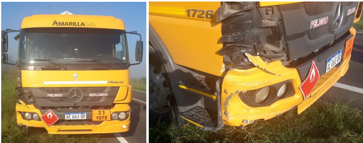
Figura 5. Imágenes que ilustran los daños y zona de impacto en el Vehículo 1. Fuente: Policía de La Leonesa. 2023
