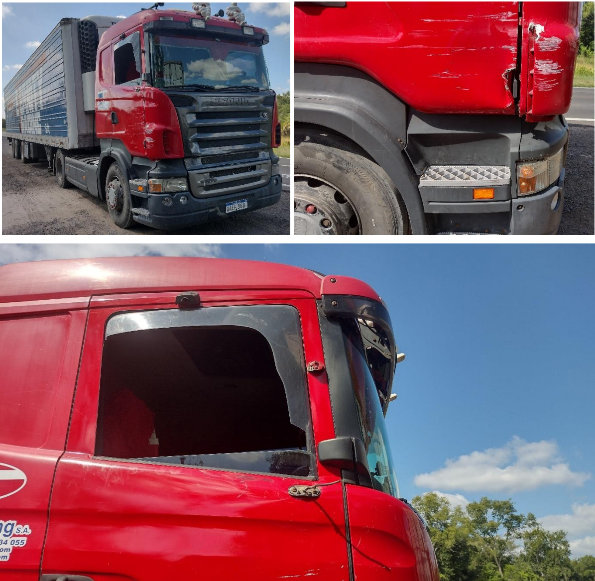
Figura 17. Daños en la cabina de la unidad tractora del Vehículo 6. Fuente: JST. 2023
