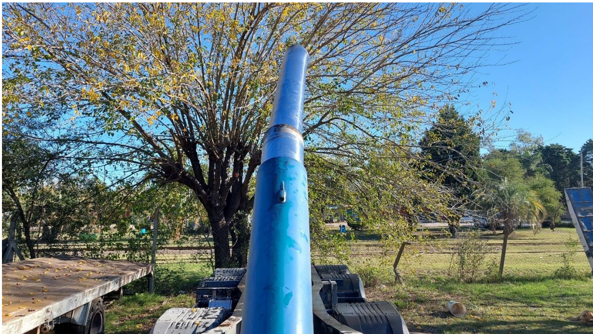
Figura 14. Daños en el cilindro elevador del semirremolque del Vehículo 1. Fuente JST, 2023
