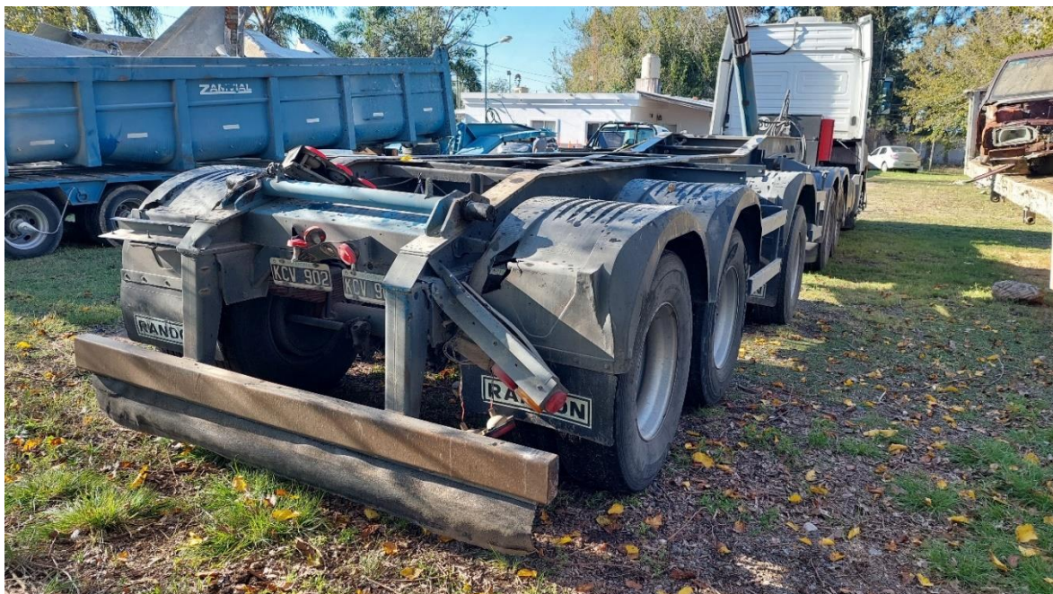
Figura 12. Daños en la parte trasera del chasis del semirremolque del Vehículo 1. Fuente JST, 2023
