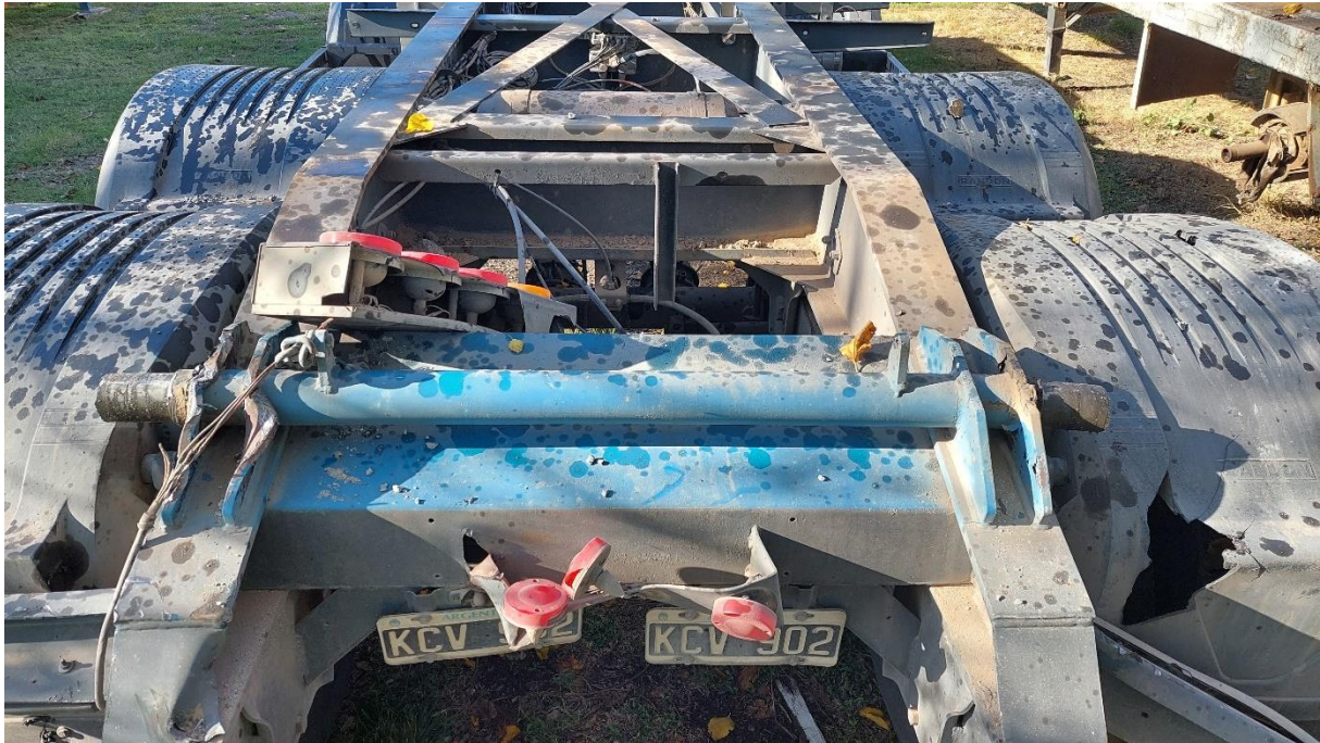
Figura 13. Daños en el sistema de enganche del chasis del semirremolque del Vehículo 1. Fuente JST, 2023
