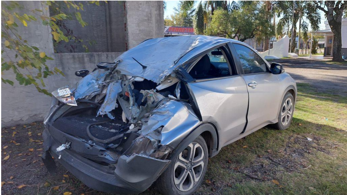
Figura 18. Vista trasera de los daños del Vehículo 2, adquiridas por contacto con la estructura del puente. Fuente JST, 2023
