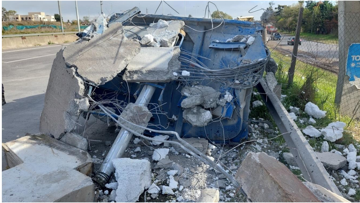
Figura 15. Vista delantera de los daños presentes en la batea del Vehículo 1. Fuente JST, 2023
