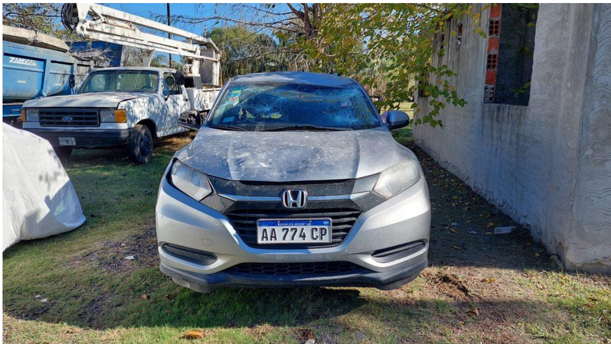
Figura 17. Deformaciones del Vehículo 2, adquiridas por contacto con la estructura del puente.
