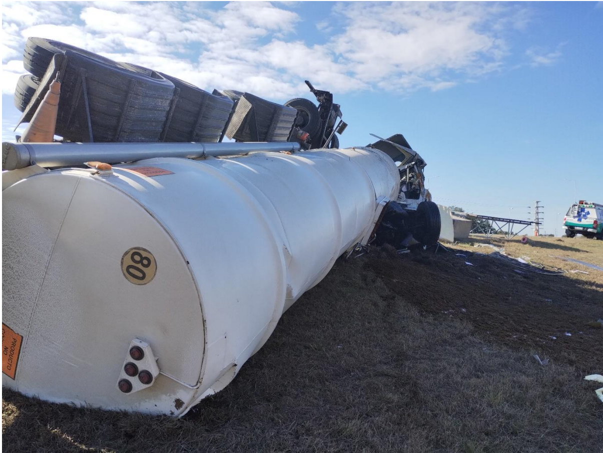
Figura 10. Deformación de la cisterna y derrame de melaza producto del choque. Fuente: JST, 2023
