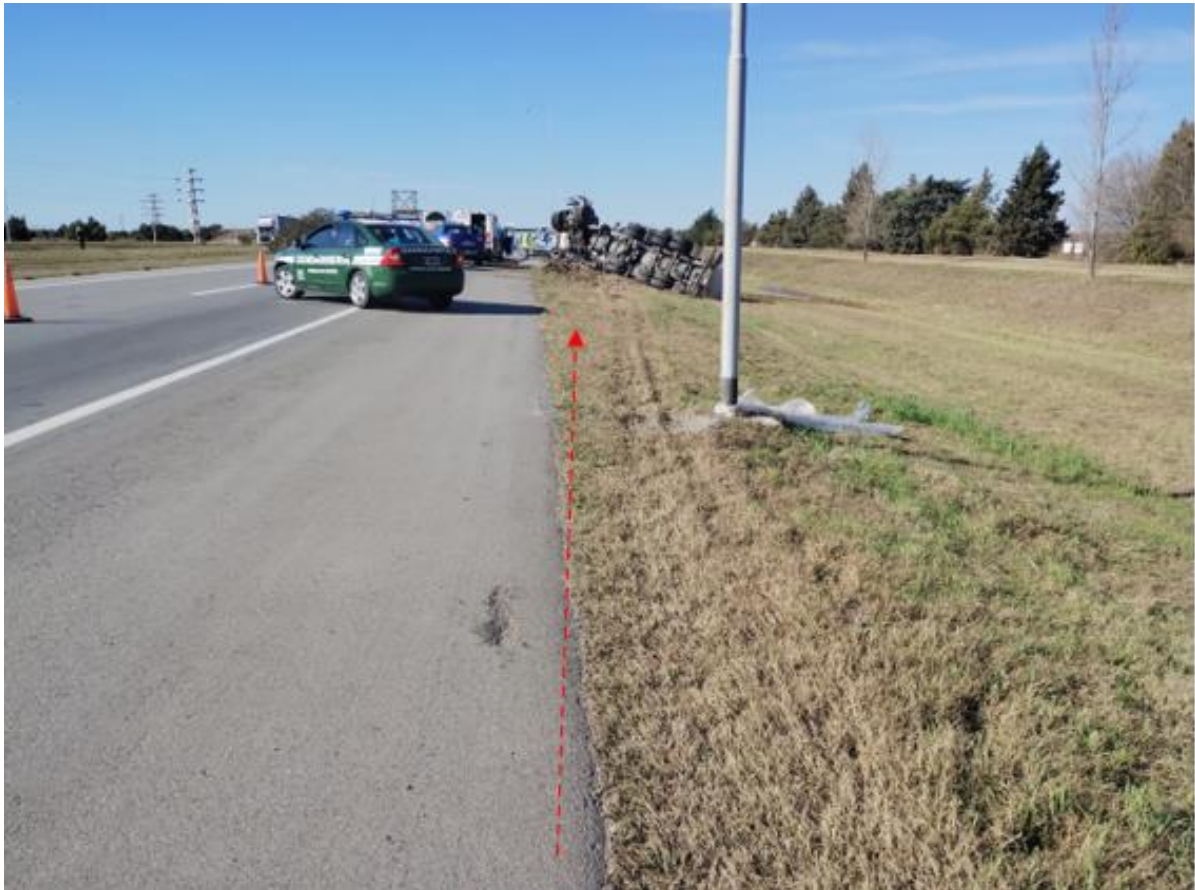
Figura 11. Trayectoria de la huella del Vehículo 1 sobre la banquina de pasto. Fuente: JST, 2023
