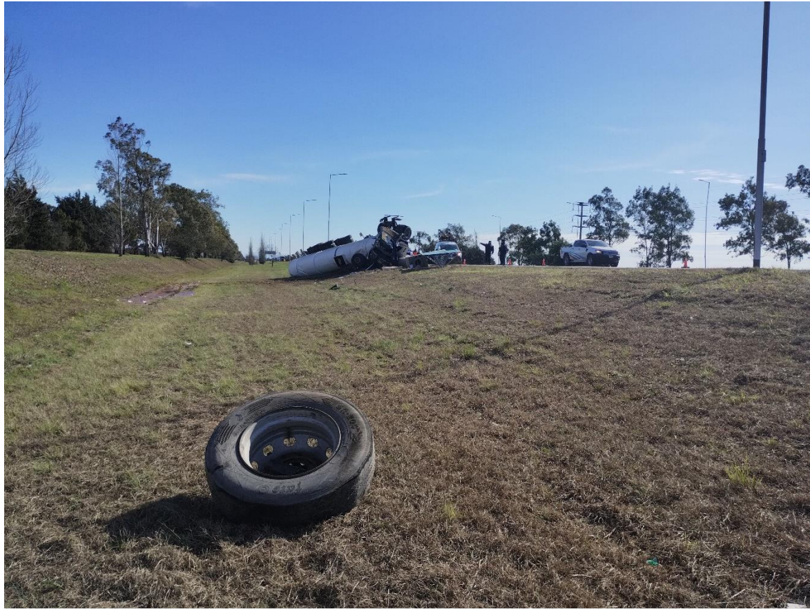
Figura 14. Distancia entre el neumático desprendido, luego de impactar con el poste de tendido eléctrico, y la posición final del Vehículo 1. Fuente: JST, 2023.
