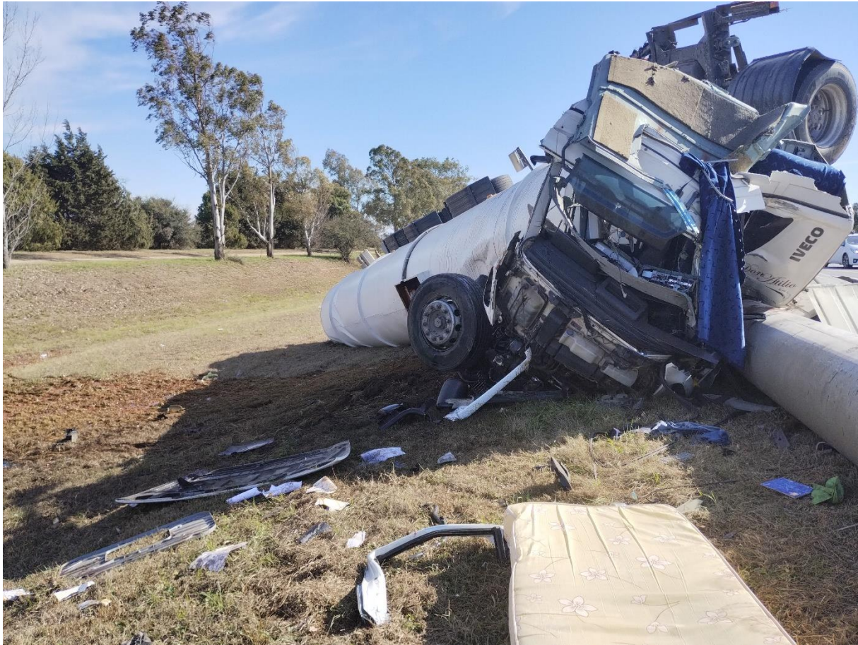
Figura 9. Daños constatados sobre el camión cisterna donde se observa la relación con su posición final. Fuente: JST, 2023
