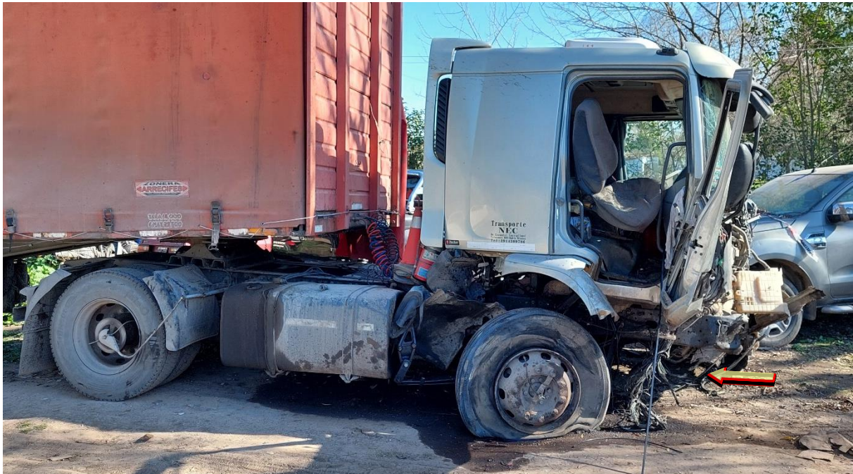
Figura 10. Daños en el lateral derecho de la unidad tractora del Vehículo 1. Fuente: JST, 2023
