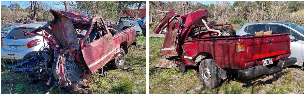
Figura 13. Deformaciones el lateral izquierdo del Vehículo 2. Fuente: JST, 2023
