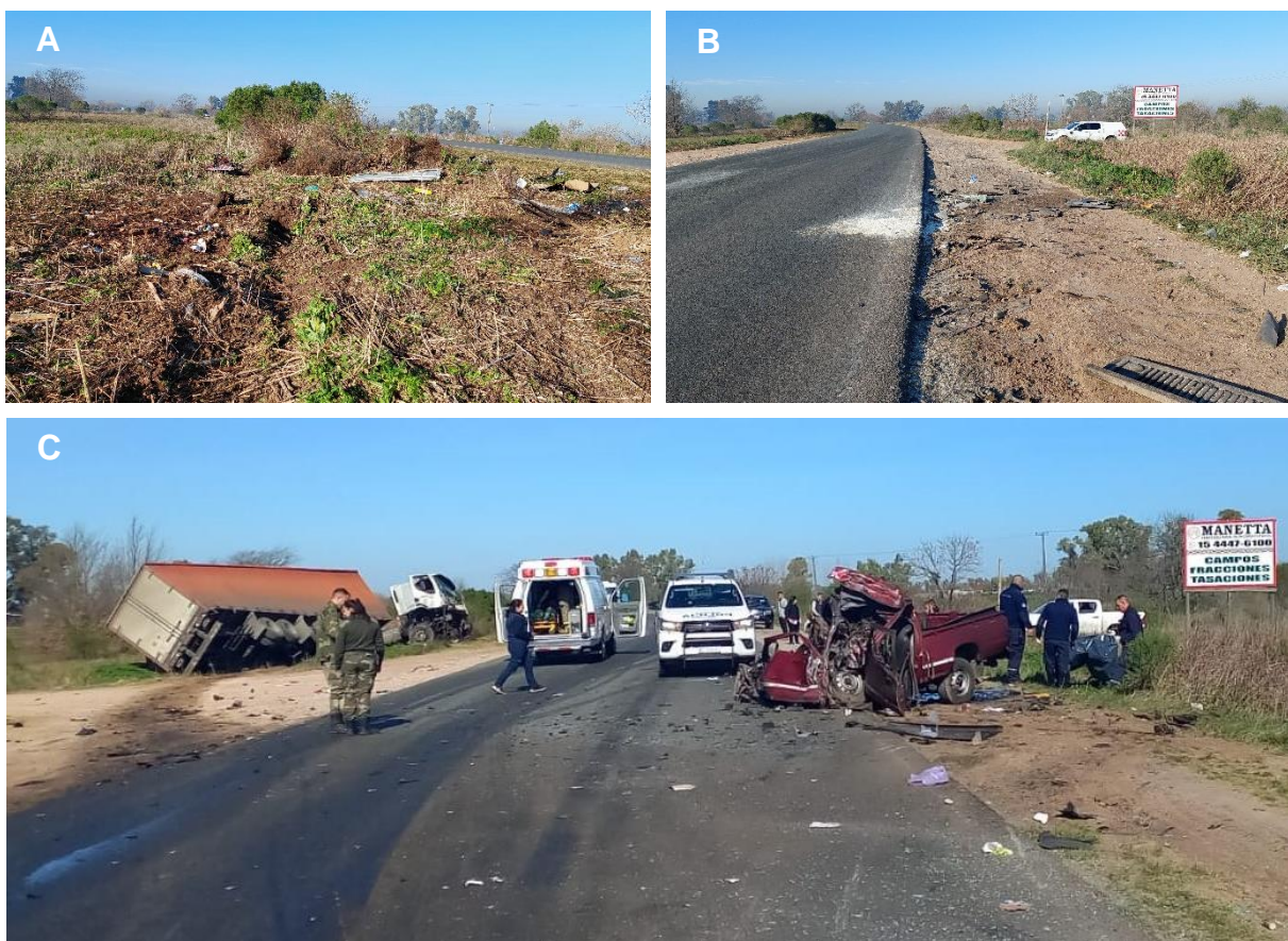
Figura 22. A) Finalización de la huella de arrastre, resto de carrocería y mancha estática de fluidos mecánicos que evidenció la posición final del Vehículo 1. B) Mancha de fluidos mecánicos estáticos que determinó la posición final del Vehículo 2. C) Posiciones finales de los vehículos participantes en el suceso. Fuente: JST y El Civismo , 2023
