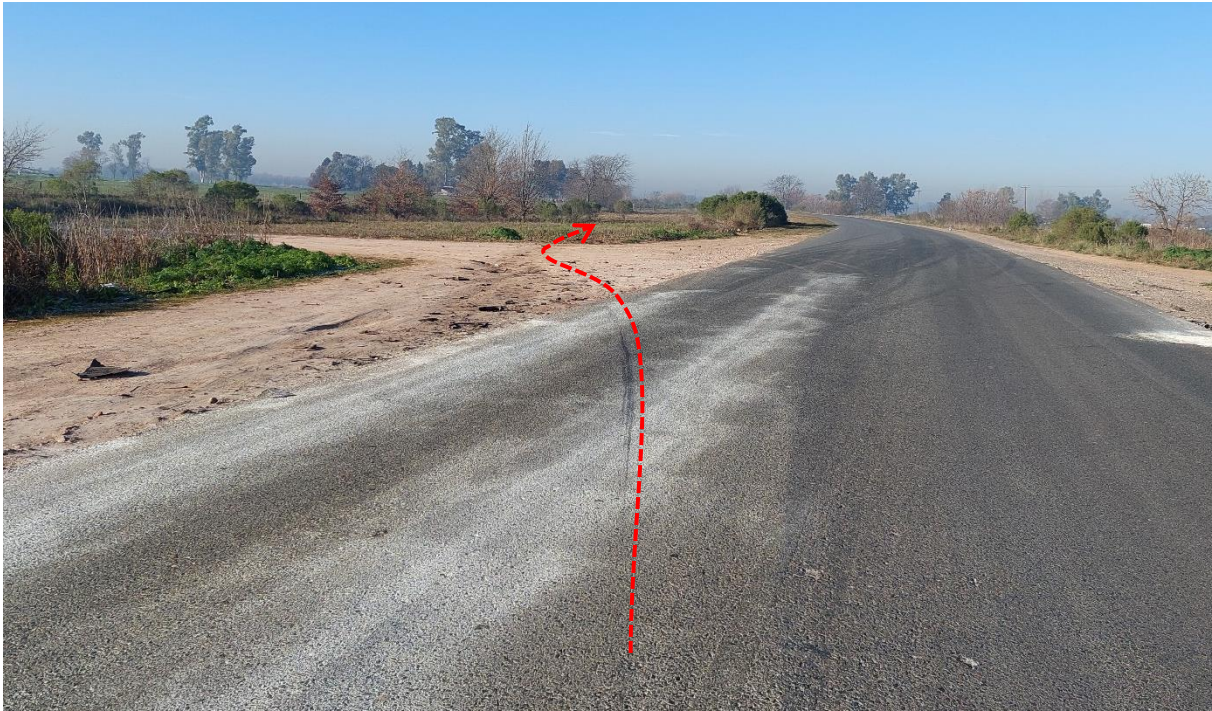
Figura 18. Impresión de la huella de arrastre pos impacto del Vehículo 1 sobre el carril y banquina hacia Luján. Fuente: JST, 2023
