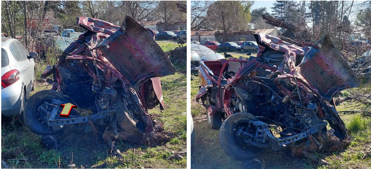
Figura 12. Daños en el sector anterior del Vehículo 2. Fuente: JST, 2023
