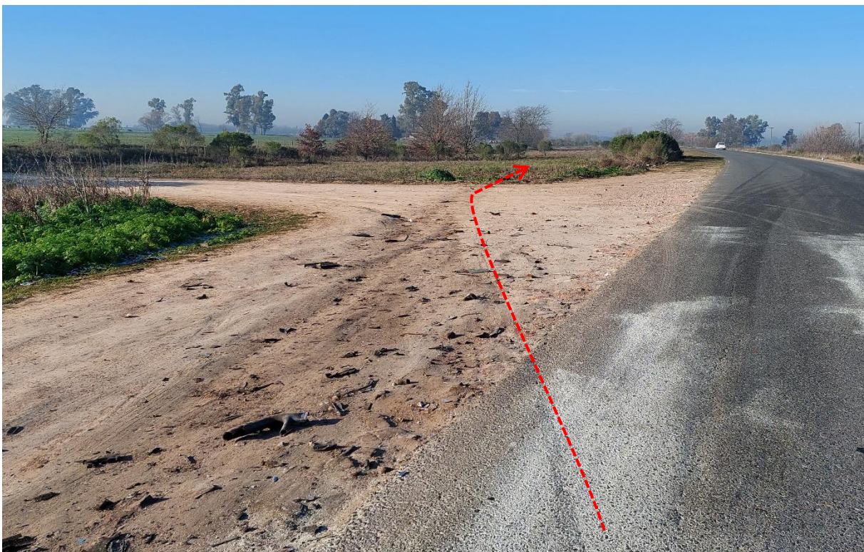
Figura 19. Ingreso de la huella de arrastre a la banquina y comienzo de mancha dinámica de fluidos mecánicos posimpacto y restos del Vehículo 1. Fuente: JST, 2023
