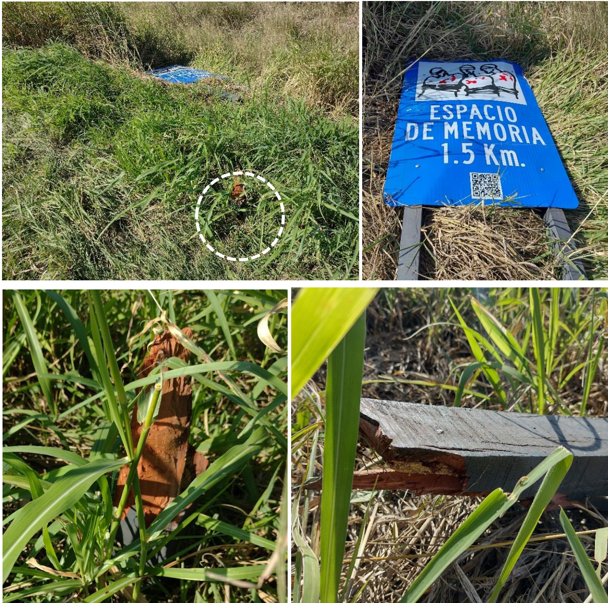
Figura 10. Las imágenes muestran el punto de anclaje de la señal informativa impactada por el ómnibus y el lugar donde quedó el cartel finalmente. Fuente: JST, 2023
