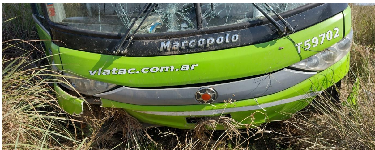
Figura 7. Vista de los daños externos en el ómnibus y en el frente bajo del ómnibus. Fuente: JST, 2023
