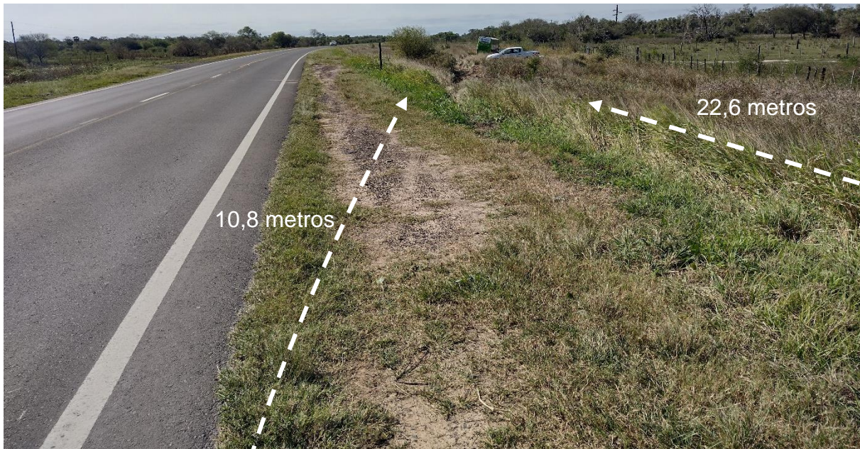
Figura 11. En la imagen se indican las dos marcas de neumático producidas por el ómnibus, con proyección hacia la zona de inicio del talud. Fuente: JST, 2023
