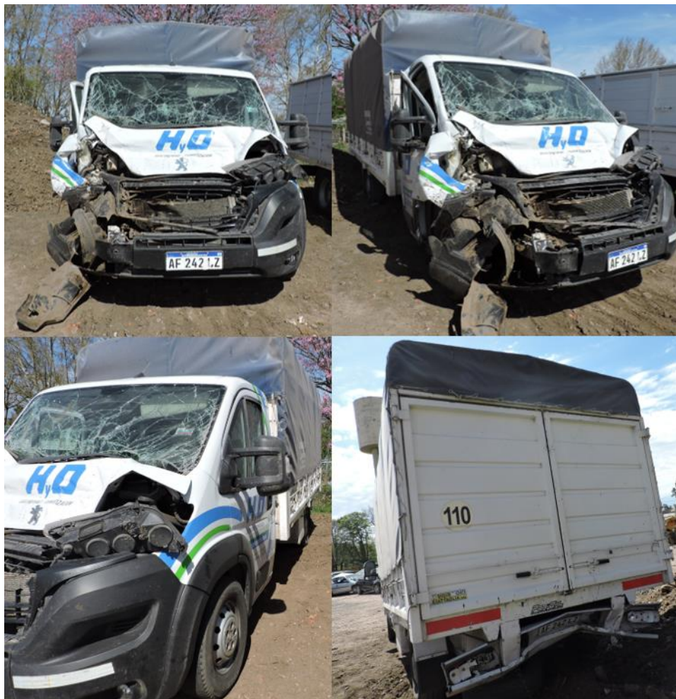
Figura 13. Visualización de daños en el Vehículo 4. Fuente: JST, 2023
