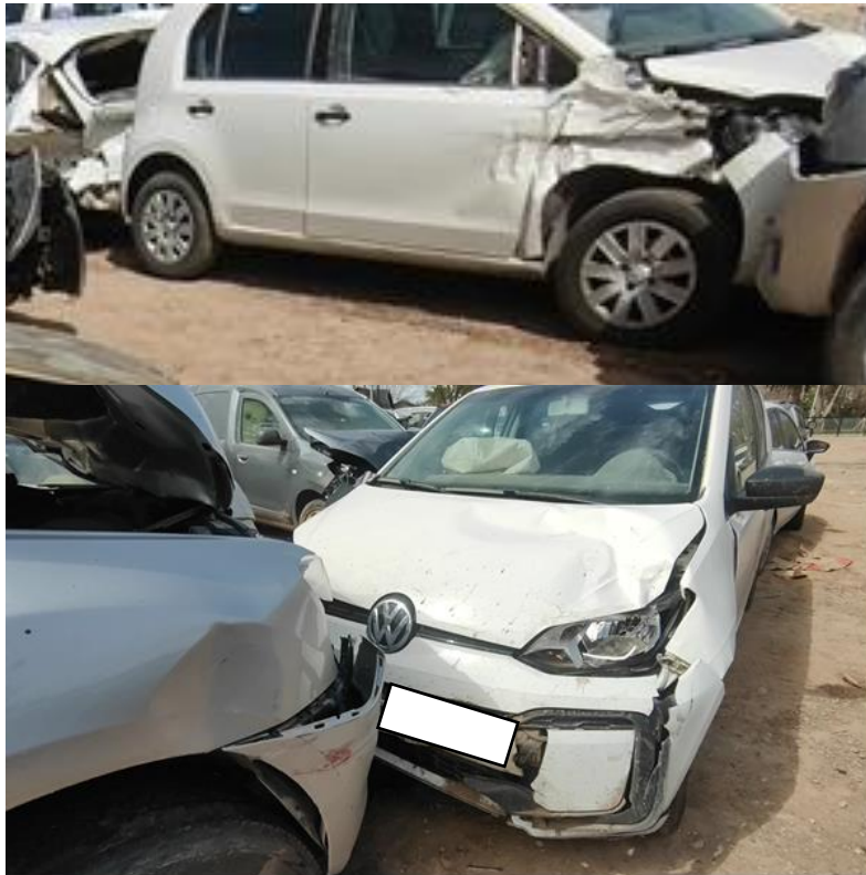
Figura 29. Visualización de daños del Vehículo 20. Fuente: JST, 2023
