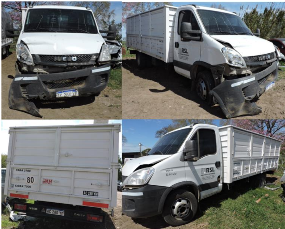
Figura 9. Vistas del Vehículo 2. Detalle de daños en la parte anterior. Fuente: JST, 2023
