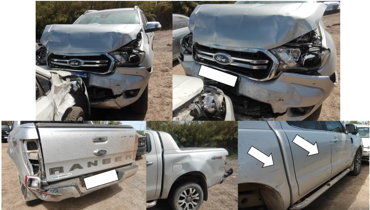
Figura 43. Visualización de daños del Vehículo 34. Fuente: JST, 2023
