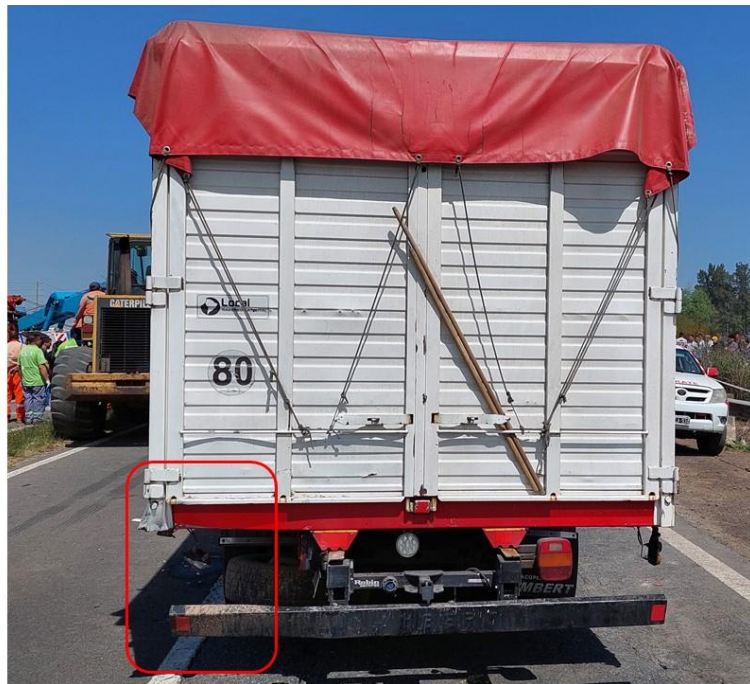
Figura 20. Daños que ocasionó el impacto con el Vehículo 6. Fuente: JST, 2023
