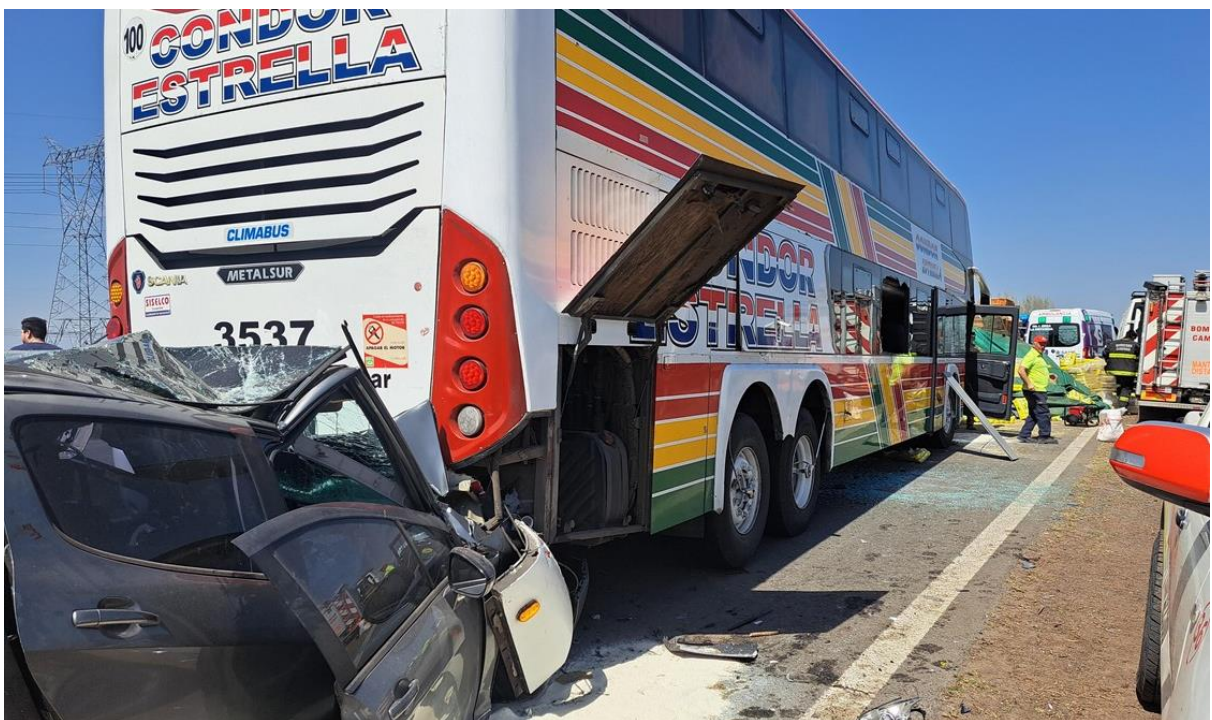
Figura 16. Daños producidos en el Vehículo 3 por el choque del Vehículo 4. Fuente: JST, 2023
