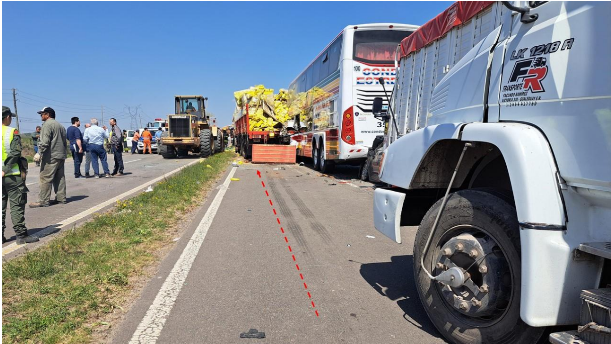
Figura 23. Comienzo de la huella de frenado preimpacto del Vehículo 2. Fuente: JST, 2023
