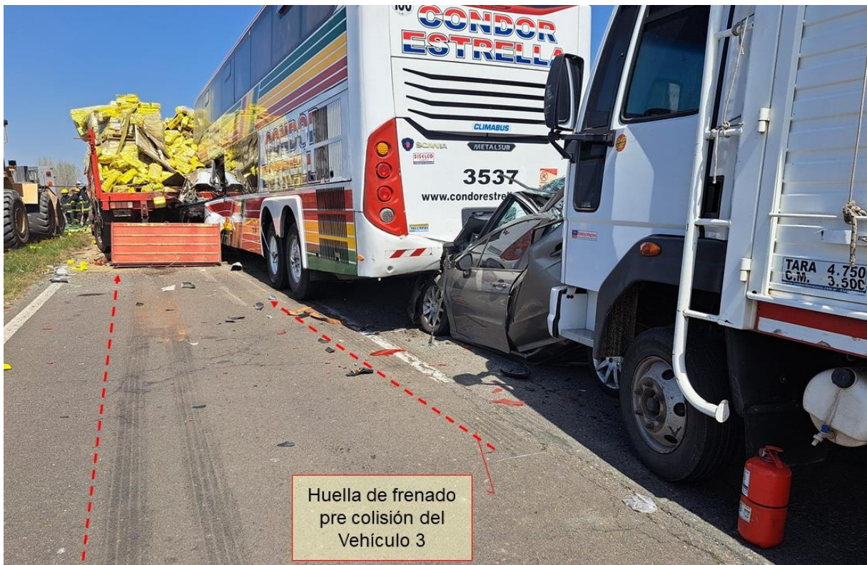
Figura 25. Comienzo de la huella de frenado preimpacto del Vehículo 3. Fuente: JST, 2023
