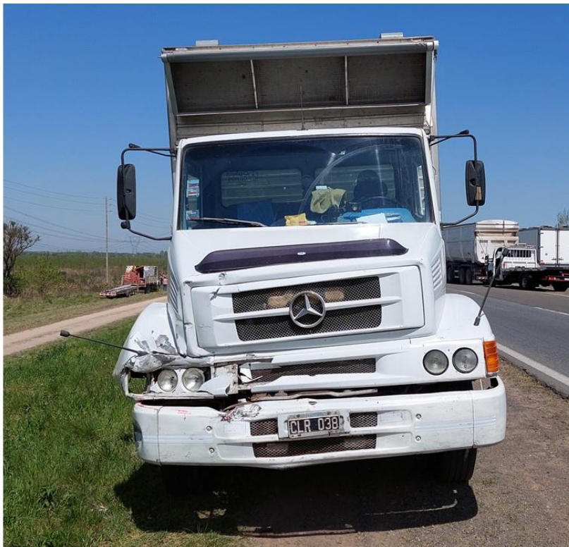
Figura 21. Daños en el Vehículo 6 ocasionados por el impacto con el Vehículo 5. Fuente: JST, 2023
