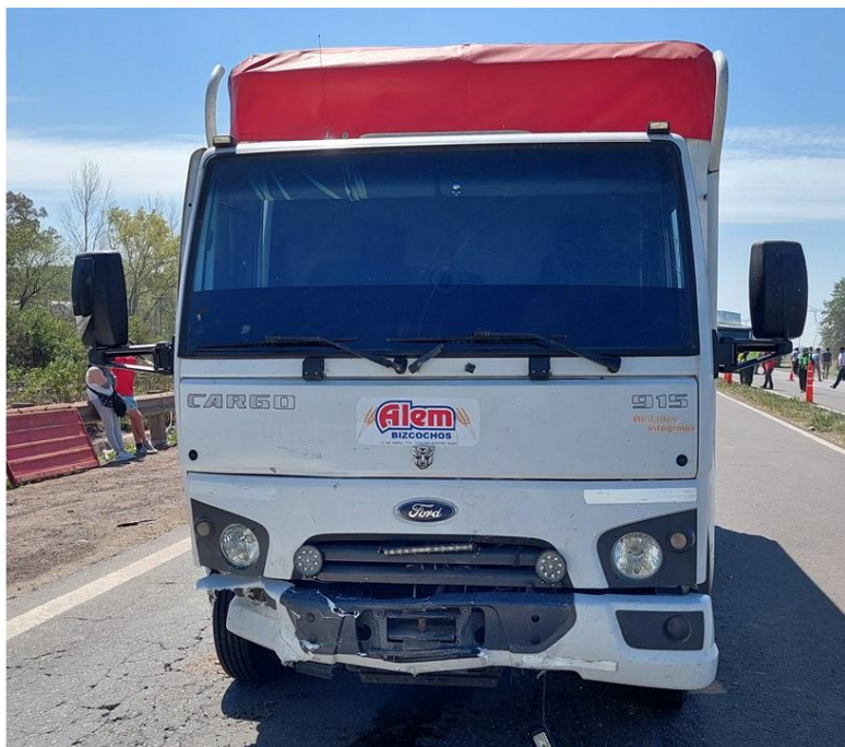
Figura 19. Daños en el Vehículo 5 producto de impacto con el Vehículo 4. Fuente: JST, 2023
