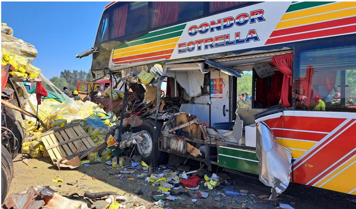
Figura 15. Daños producidos por el impacto por alcance en el Vehículo 3. Fuente: JST, 2023
