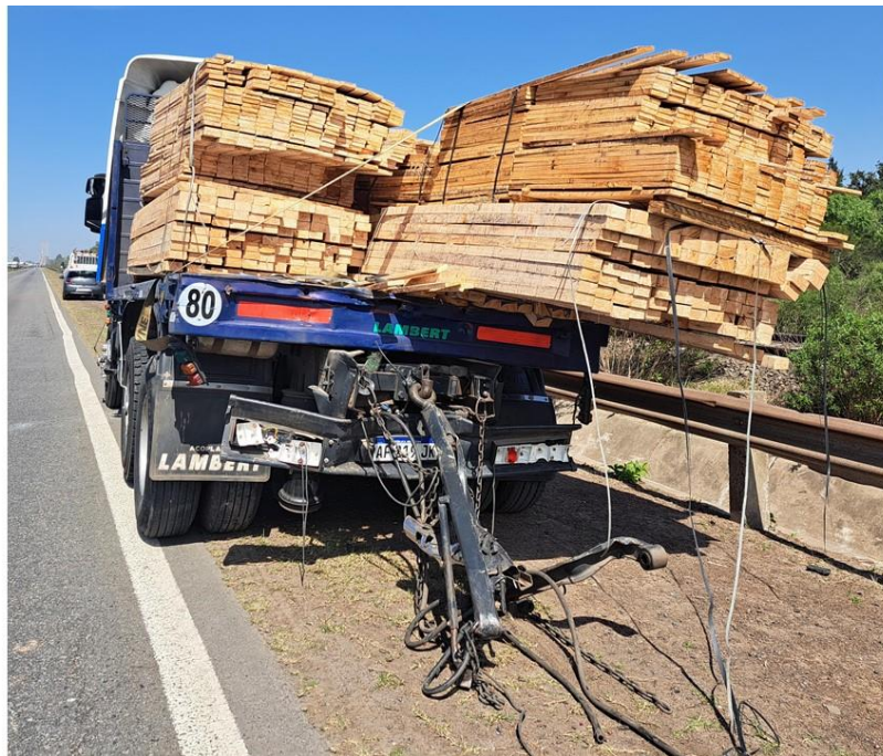
Figura 7. Deformaciones producidas con su acoplado. Fuente: JST, 2023
