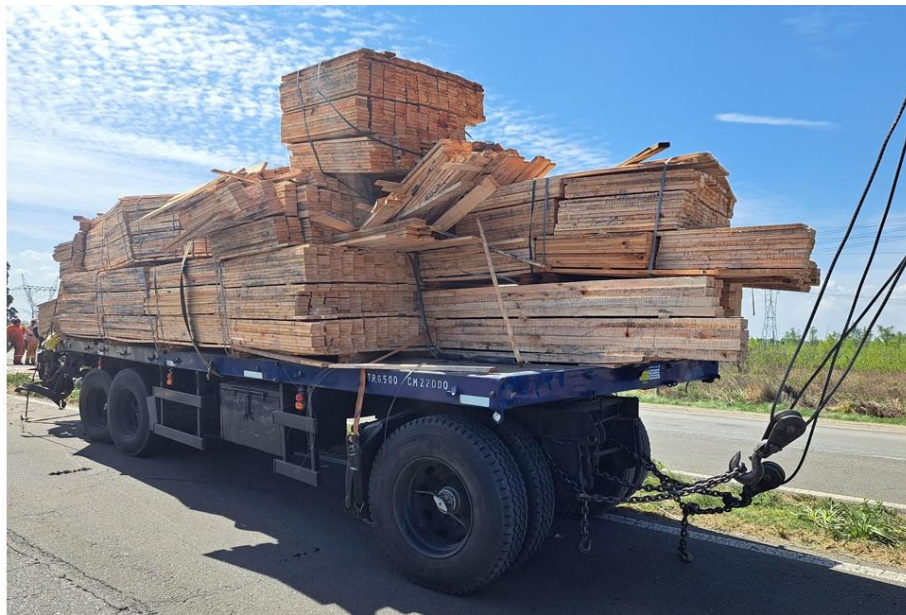
Figura 9. Desprendimiento de lanza de enganche con la unidad tractora del Vehículo 1. Fuente: JST, 2023
