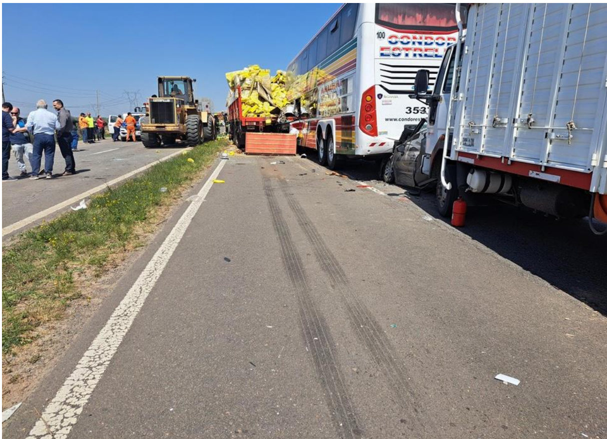
Figura 24. Continuación de la huella de frenado preimpacto del Vehículo 2. Fuente: JST, 2023
