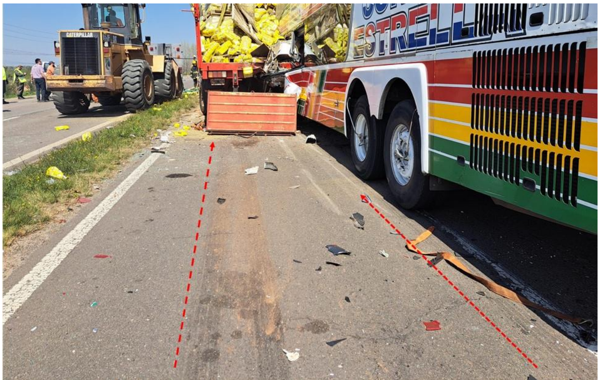
Figura 26. Finalización de ambas huellas de frenado preimpacto y comienzo de marcas de arrastre del Vehículo 2. Fuente: JST, 2023
