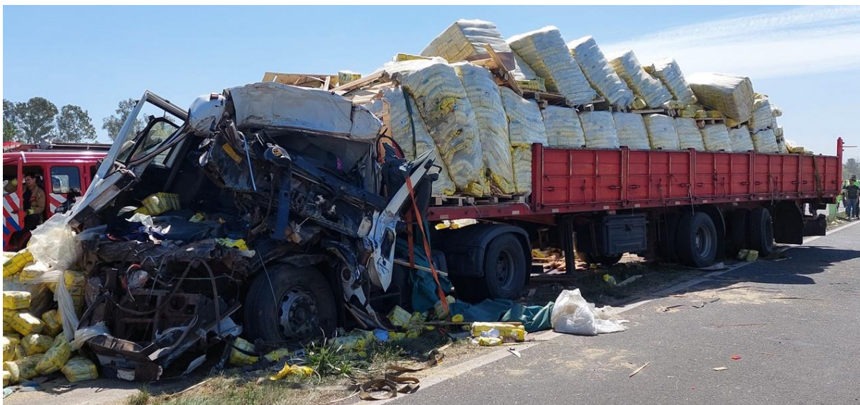
Figura 12. Daños de la unidad tractora del Vehículo 2, ocasionados por la colisión con el acoplado del Vehículo 1. Fuente: JST, 2023
