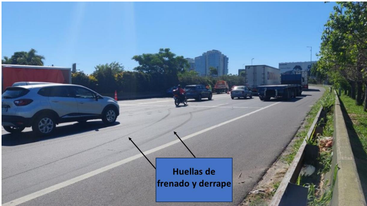
Figura 14. Huellas de derrape que invaden el carril contiguo al de circulación del Vehículo 1. Fuente JST, 2023
