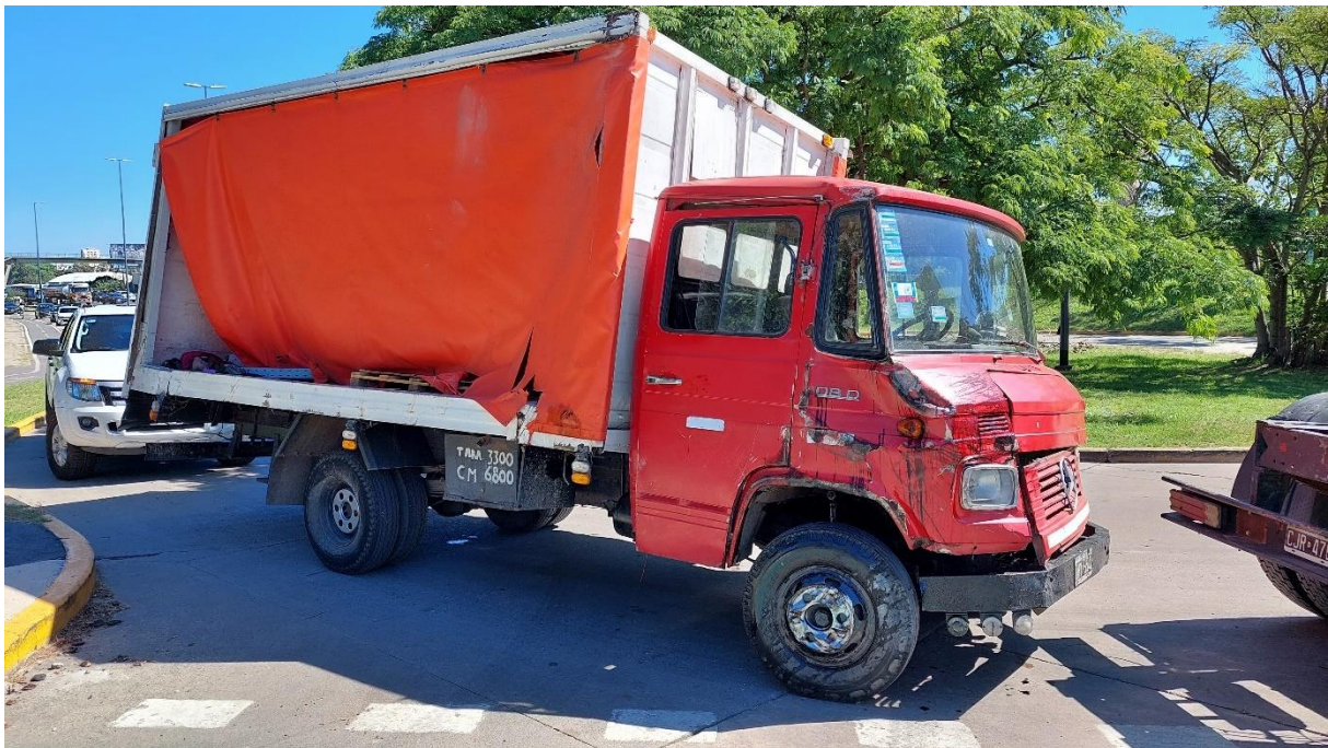
Figura 9. Daños en el lateral derecho del Vehículo 1. Fuente JST, 2023
