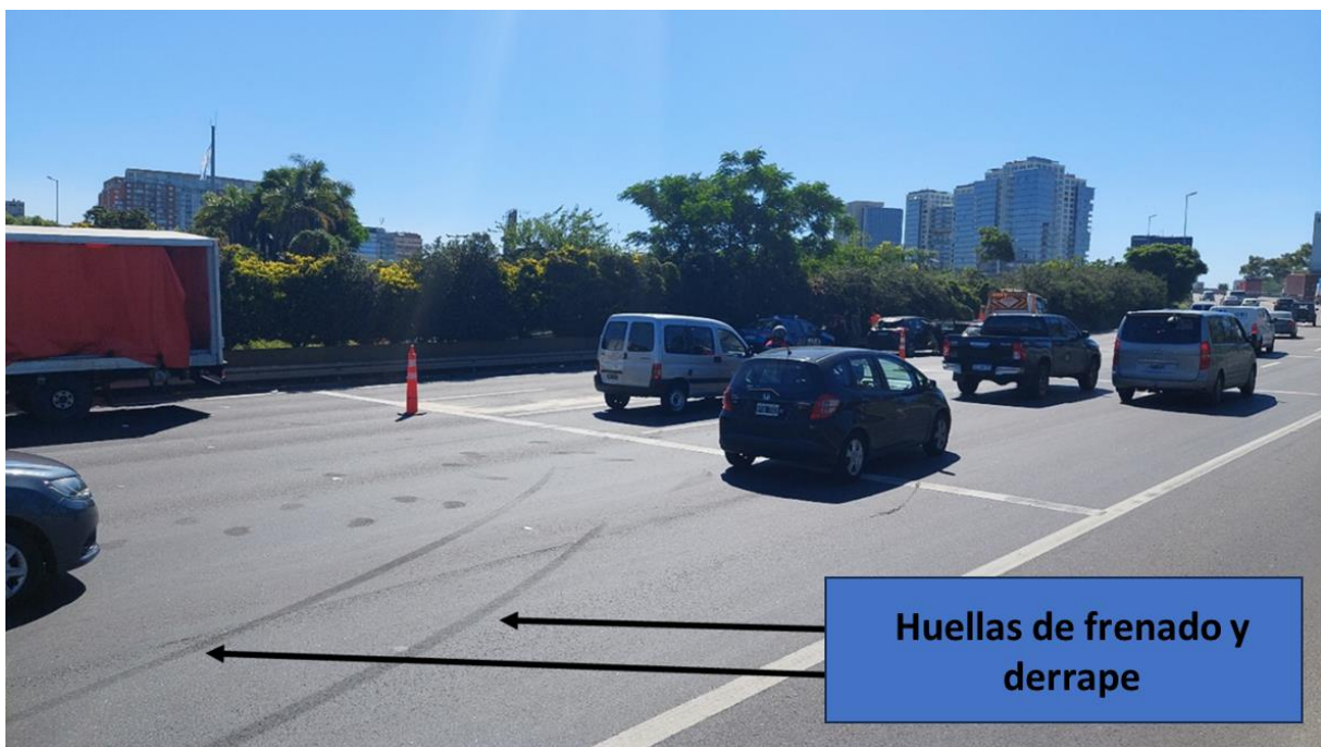
Figura 15. Huellas de frenado y derrape sobre la calzada. Fuente JST, 2023
