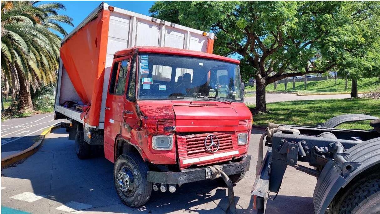
Figura 8. Daños en el sector frontal del Vehículo 1. Fuente JST, 2023
