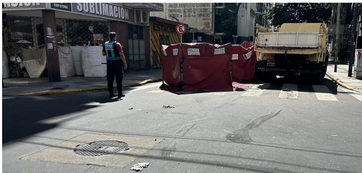
Figura 13. Huellas del tipo brochazo a partir de la zona de colisión y comienzo de la rototraslación horaria. Fuente: JST, 2024
