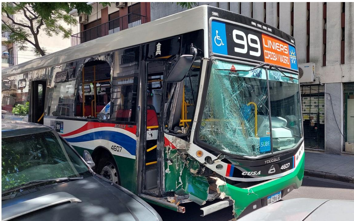
Figura 9. Daños en el lateral derecho del Vehículo 2. Fuente: JST, 2024
