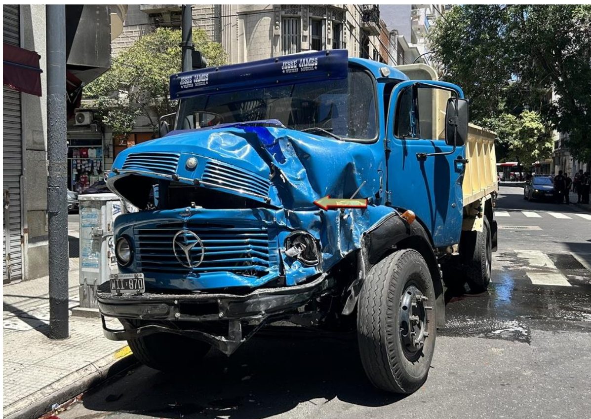
Figura 6. Daños del Vehículo 1 originados en la colisión con el Vehículo 2. La flecha indica el sentido de la fuerza actuante. Fuente: JST, 2024
