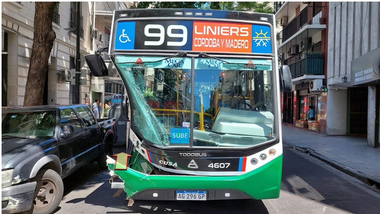
Figura 8. Daños del Vehículo 2 originados en la colisión con el Vehículo 1. La flecha indica el sentido de la fuerza actuante. Fuente: JST, 2024
