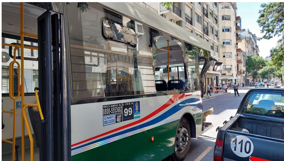
Figura 10. Daños en el Vehículo 2 asociados con la puerta izquierda y uno de los ocupantes del Vehículo 1. Fuente: JST, 2024
