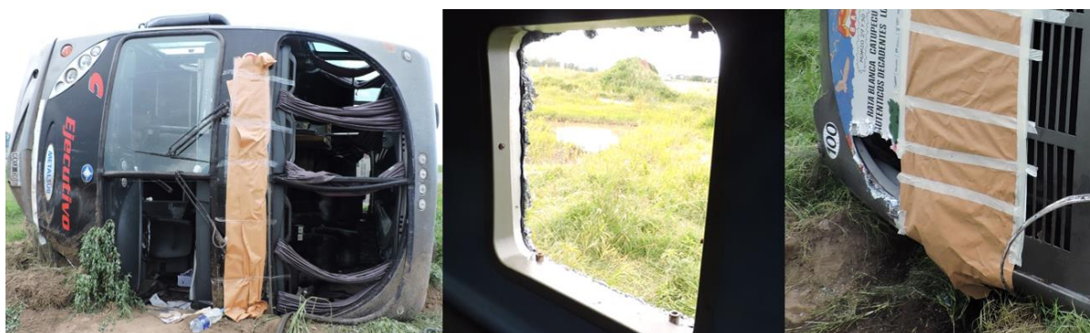
Figura 11. Daños por rescate y evacuación. Fuente. JST, 2024
