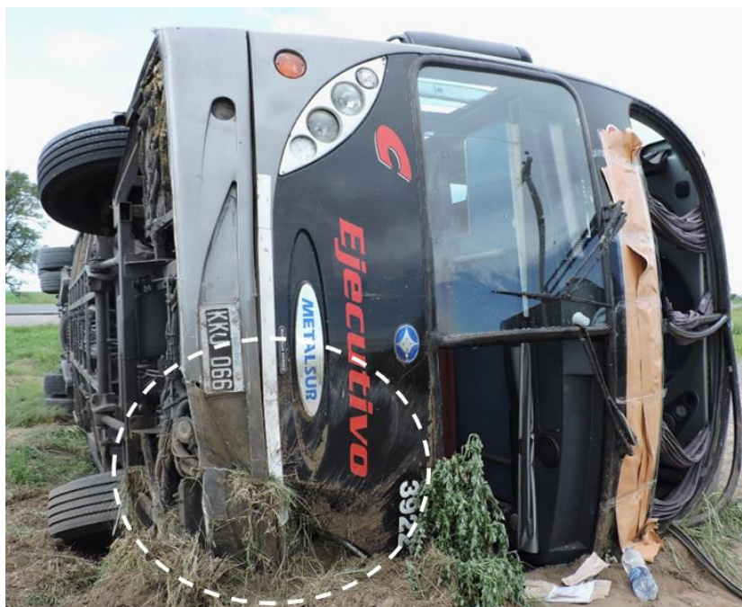
Figura 10. Daños en el vértice inferior izquierdo producto del impacto con la superficie durante el vuelco. Fuente: JST, 2024
